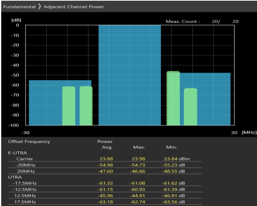
Band20 QPSK BW=20MHz Channel=24350 RB Size=100 Position=#0
