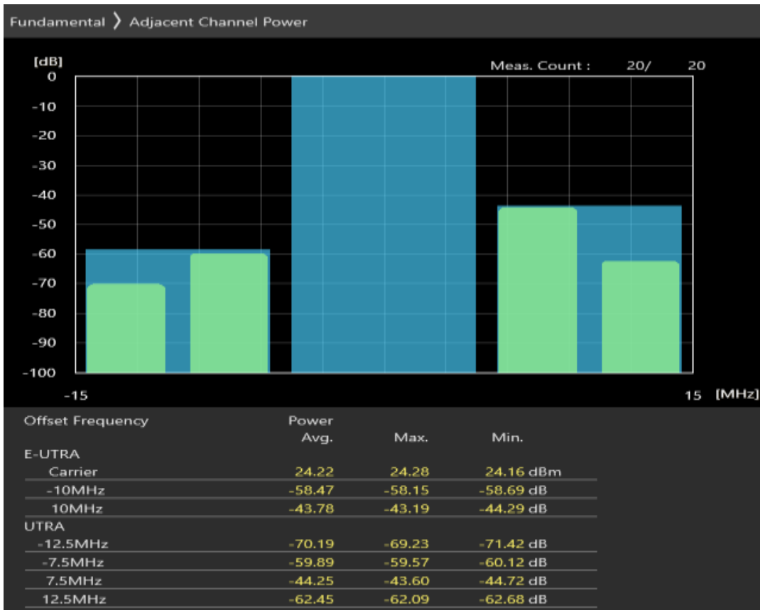
Band20 QPSK BW=10MHz Channel=24200 RB Size=50 Position=#0
