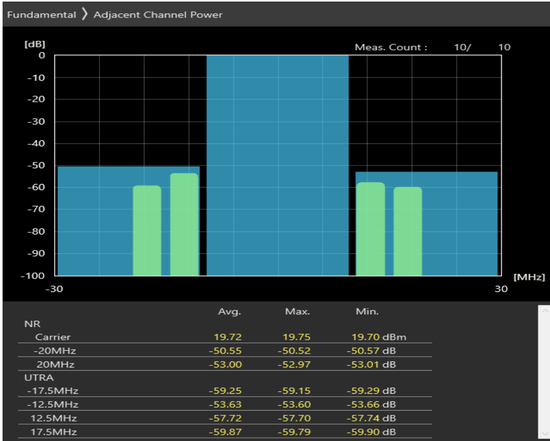
n20 SCS=30kHz DFT_BPSK BW=20MHz Channel=168400 RB=50@0
