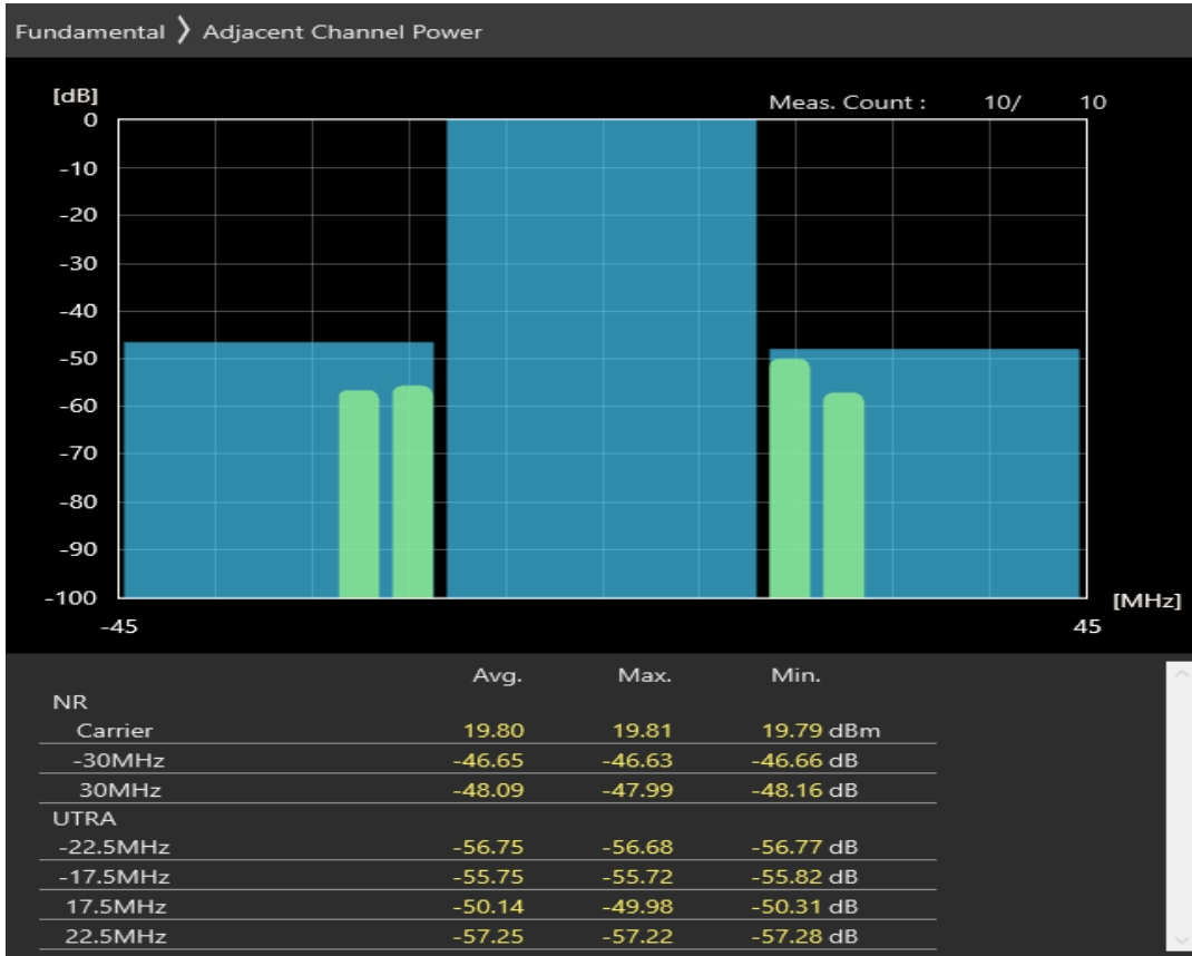
n3 SCS=30kHz CP_QPSK BW=30MHz Channel=354000 RB=78@0
