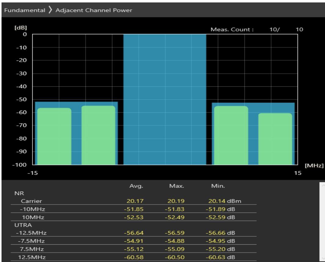
n8 SCS=30kHz DFT_BPSK BW=10MHz Channel=182000 RB=24@0
