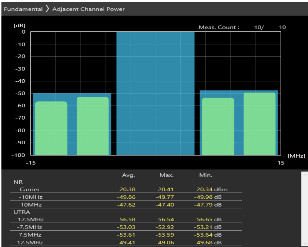
n3 SCS=30kHz CP_QAM256 BW=10MHz Channel=343000 RB=24@0
