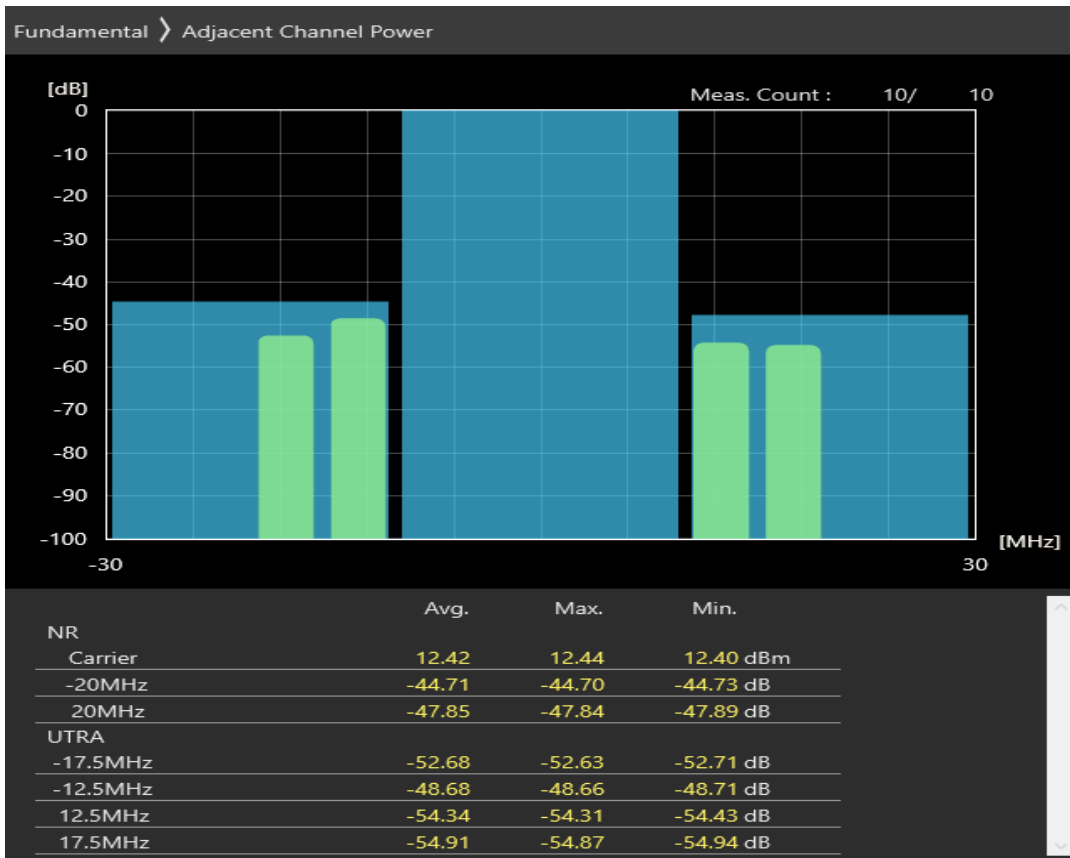
n28 SCS=30kHz CP_QAM256 BW=20MHz Channel=147600 RB=51@0
