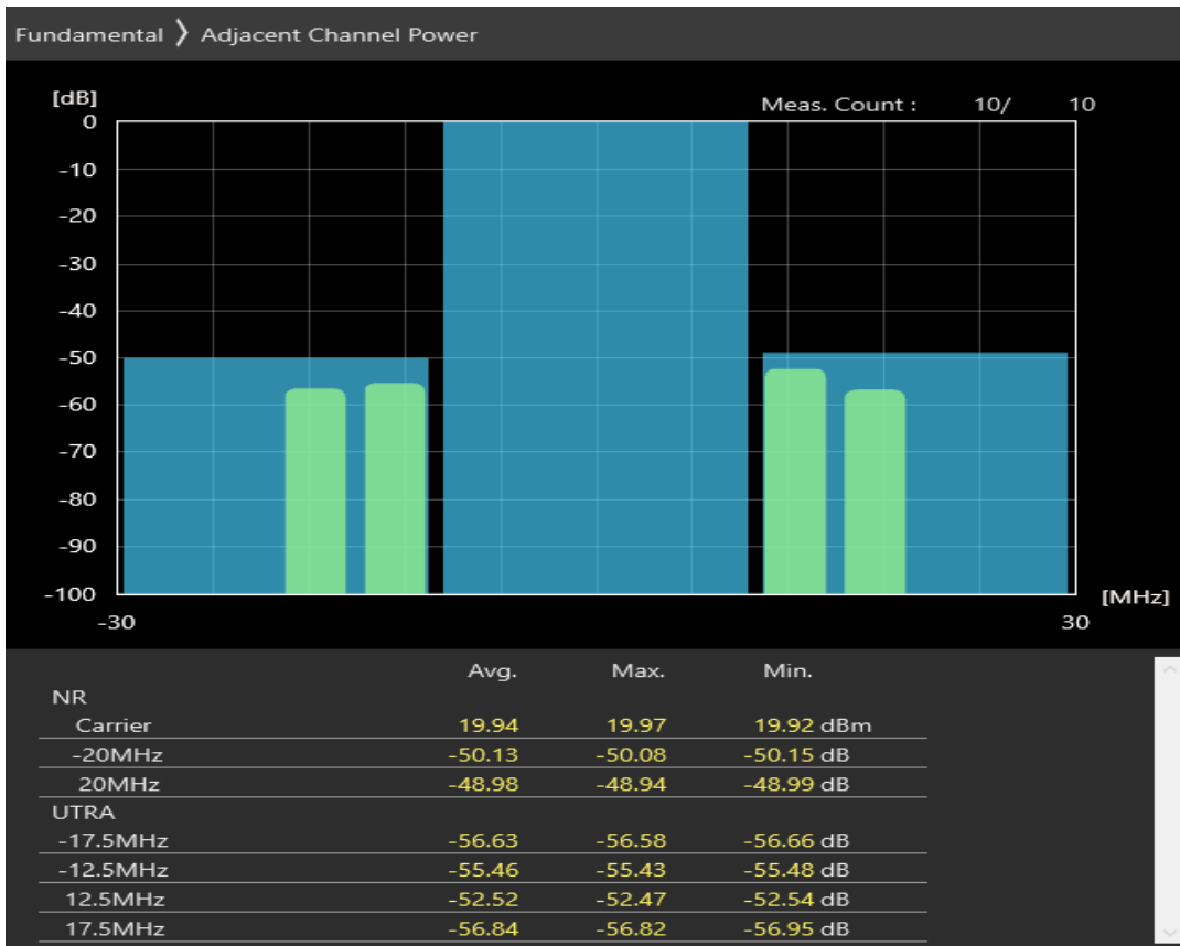
n20 SCS=30kHz DFT_QAM64 BW=20MHz Channel=170400 RB=50@0
