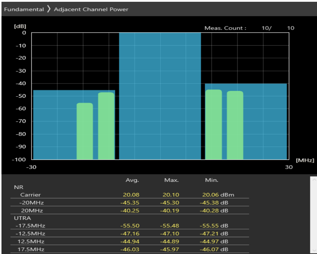
n28 SCS=30kHz CP_QPSK BW=20MHz Channel=142600 RB=25@12
