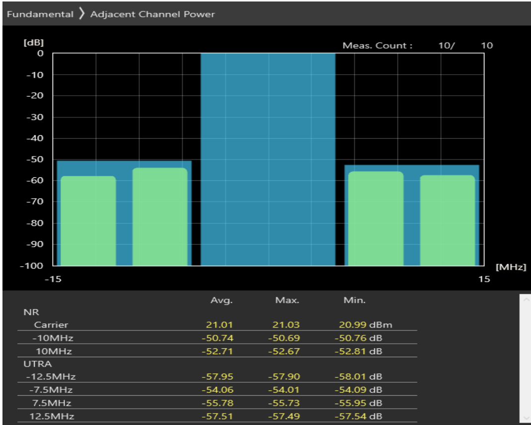
n20 SCS=30kHz DFT_QAM256 BW=10MHz Channel=167400 RB=24@0
