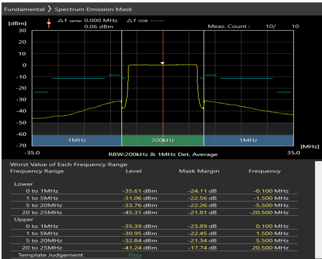
n1 SCS=30kHz CP_QPSK BW=20MHz Channel=386000 RB=51@0
