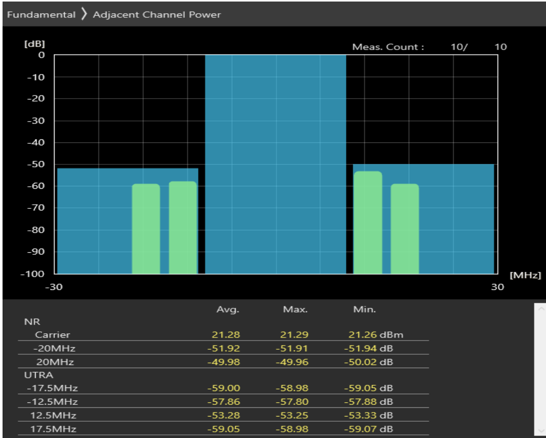
n8 SCS=30kHz CP_QAM16 BW=20MHz Channel=181000 RB=51 @0
