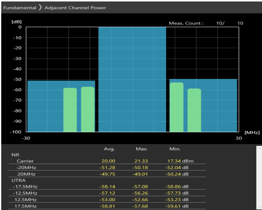
n28 SCS=30kHz DFT_QAM256 BW=20MHz Channel=147600 RB=50@0
