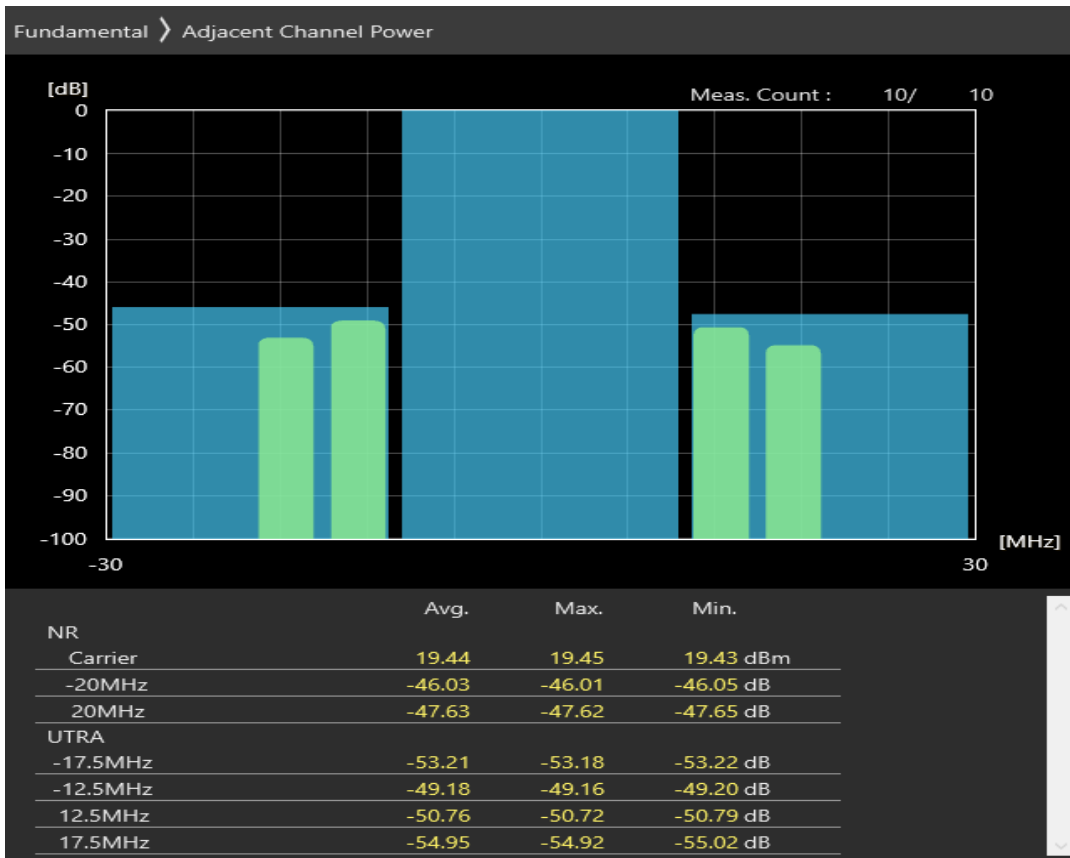
n1 SCS=30kHz DFT_BPSK BW=20MHz Channel=394000 RB=50@0
