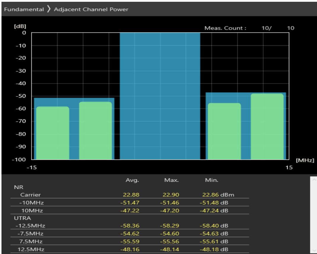
n3 SCS=30kHz DFT_QPSK BW=10MHz Channel=343000 RB=24@0
