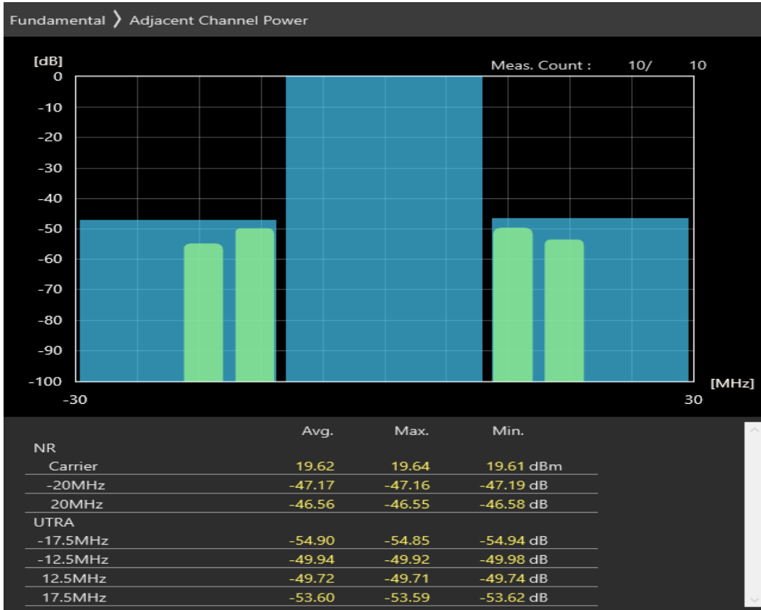
n1 SCS=30kHz DFT_QPSK BW=20MHz Channel=386000 RB=50@0
