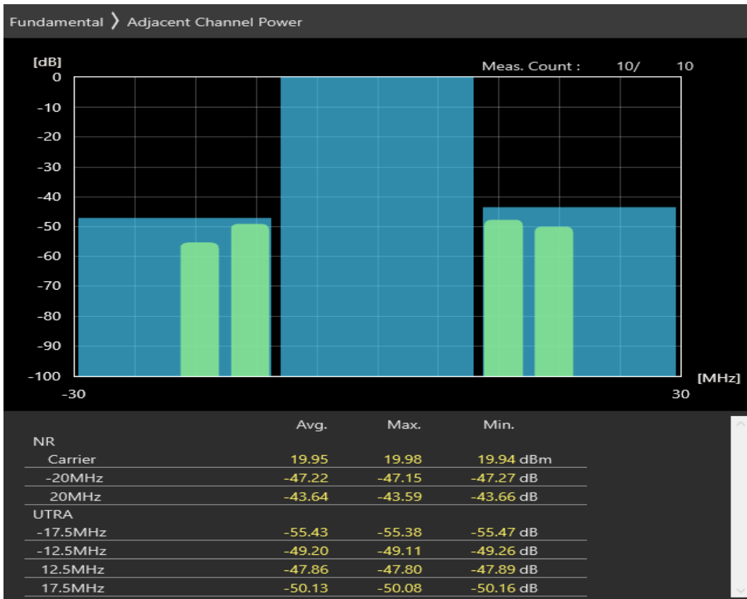
n20 SCS=30kHz DFT_QAM256 BW=20MHz Channel=168400 RB=1@0
