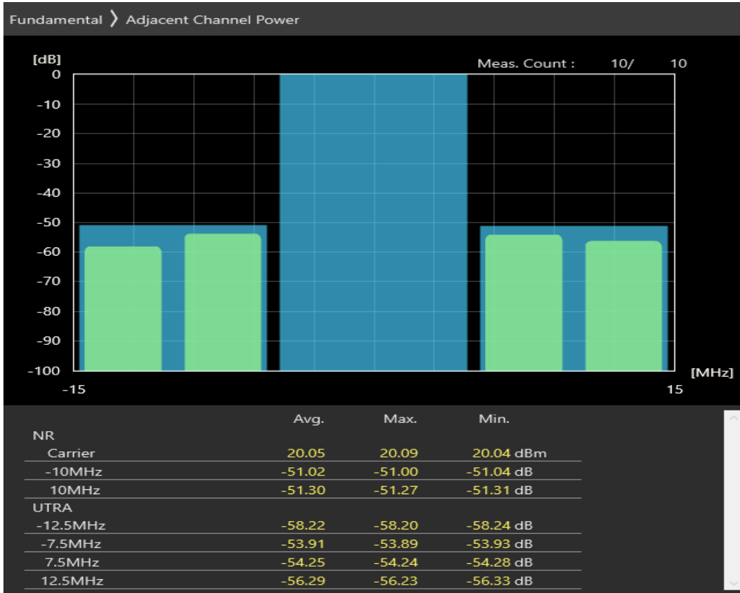
n28 SCS=30kHz CP_QAM256 BW=10MHz Channel=141600 RB=24@0
