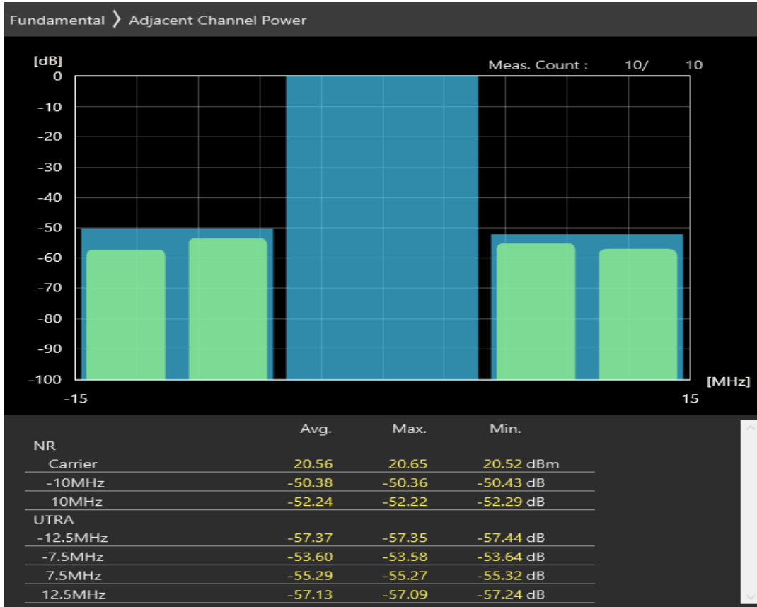
n1 SCS=30kHz CP_QPSK BW=10MHz Channel=385000 RB=24@0
