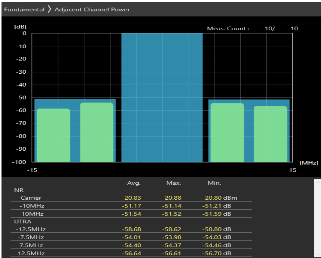
n28 SCS=30kHz CP_QPSK BW=10MHz Channel=141600 RB=24@0
