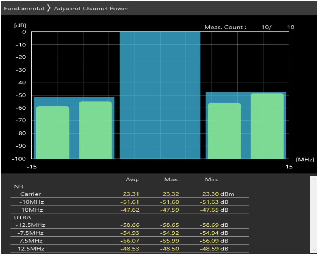
n3 SCS=30kHz DFT_BPSK BW=10MHz Channel=343000 RB=24@0
