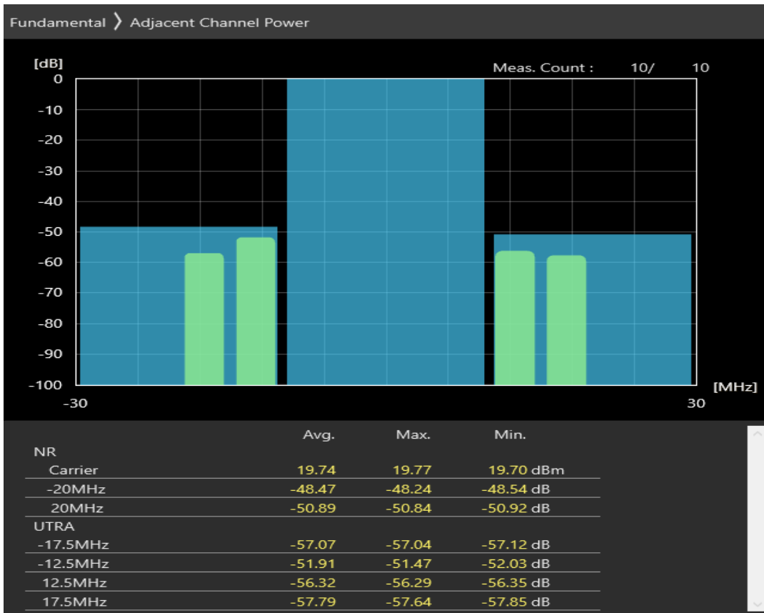
n20 SCS=30kHz CP_QAM256 BW=20MHz Channel=168400 RB=1@0
