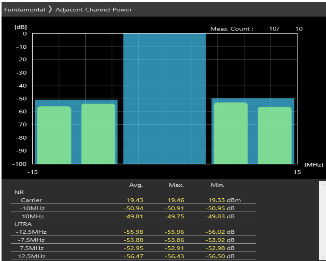
n1 SCS=30kHz CP_QAM256 BW=10MHz Channel=395000 RB=24@0
