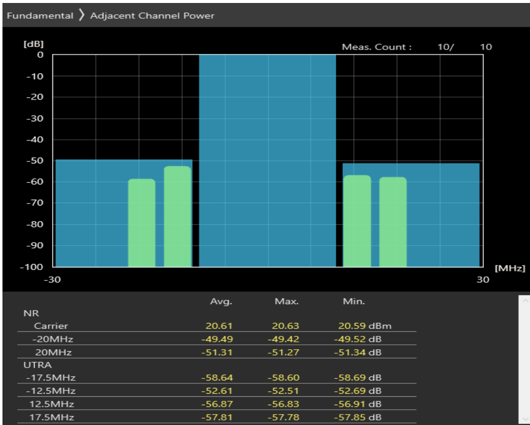
n28 SCS=30kHz CP_QPSK BW=20MHz Channel=142600 RB=51@0
