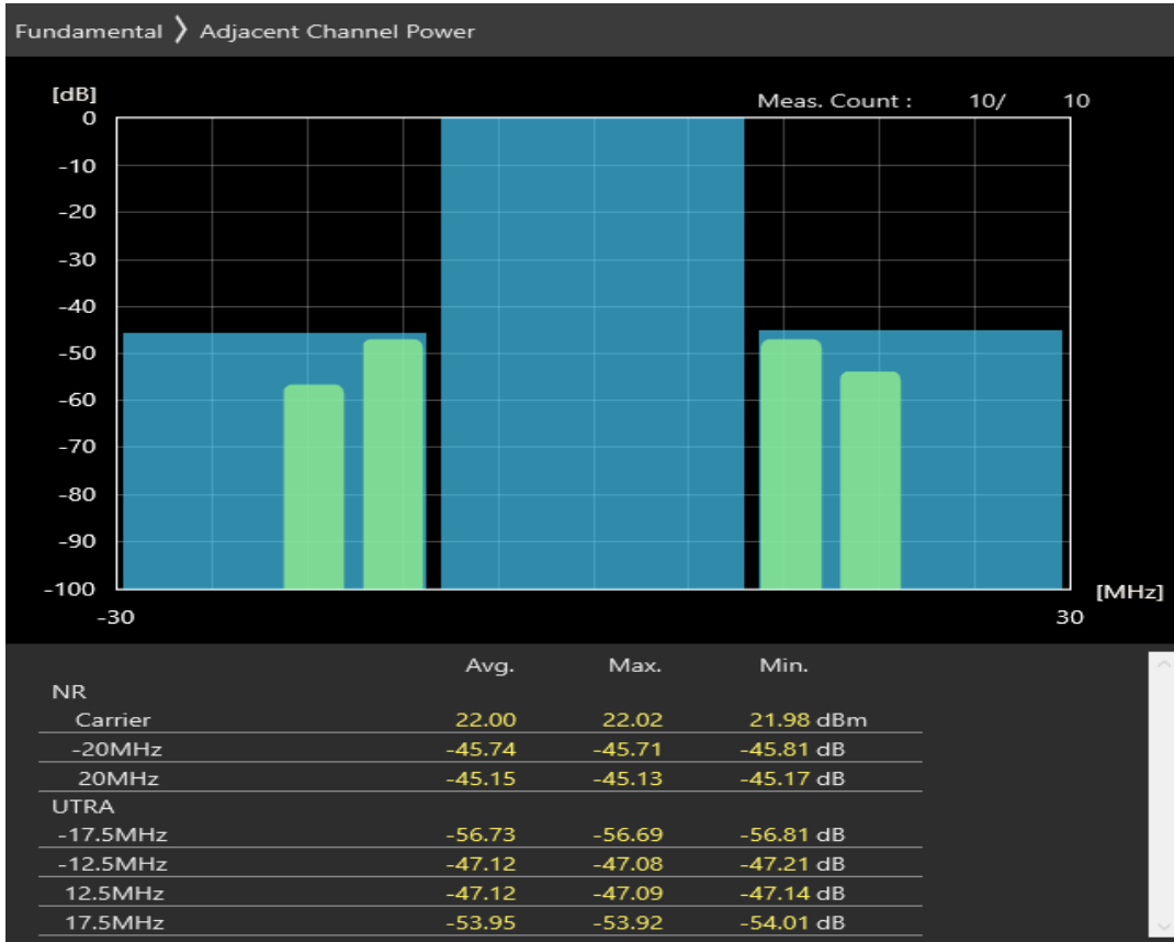
n20 SCS=30kHz CP_QPSK BW=20MHz Channel=168400 RB=1@0
