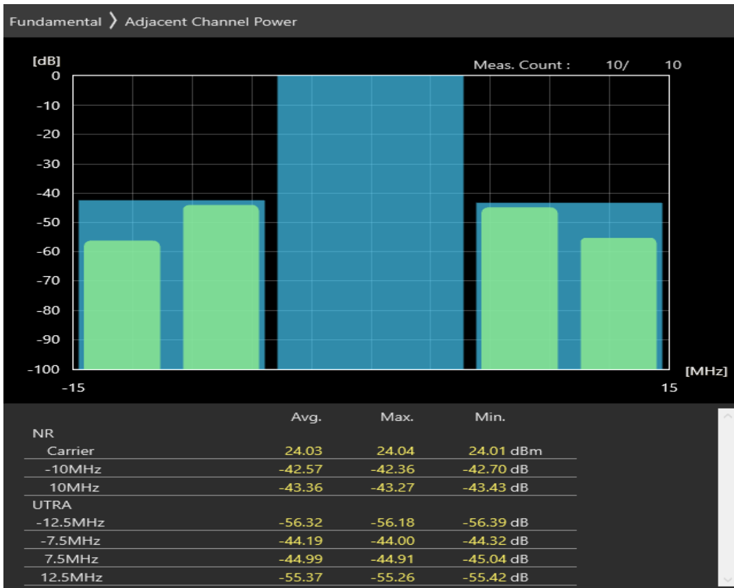
n8 SCS=30kHz DFT_QPSK BW=10MHz Channel=177000 RB=1@0
