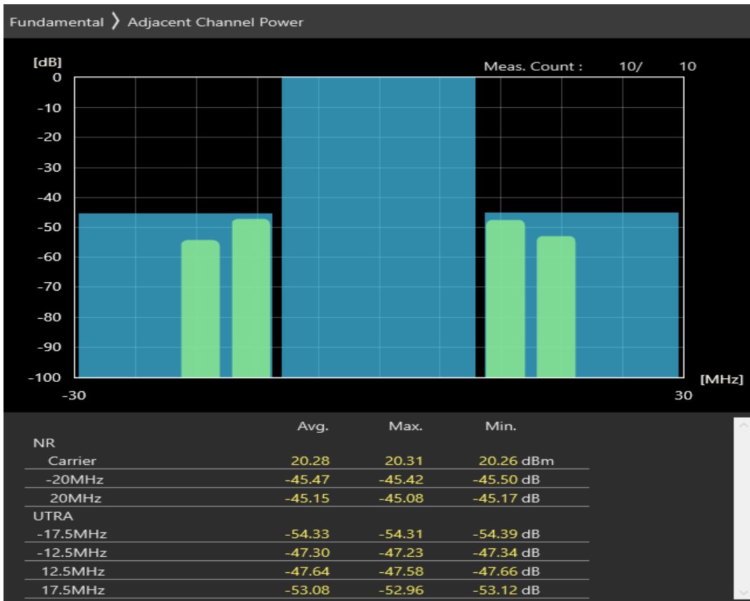
n8 SCS=30kHz DFT_QPSK BW=20MHz Channel=178000 RB=1@0
