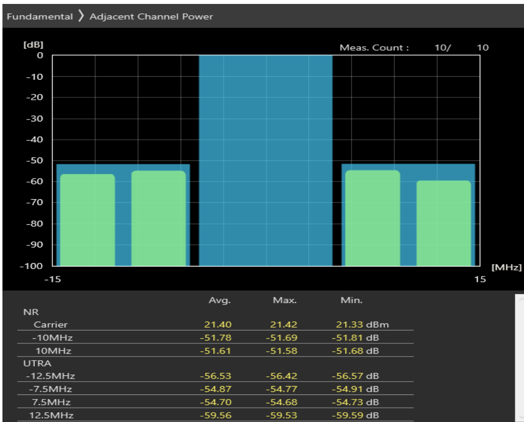
n28 SCS=30kHz DFT_QAM256 BW=10MHz Channel=148600 RB=24@0
