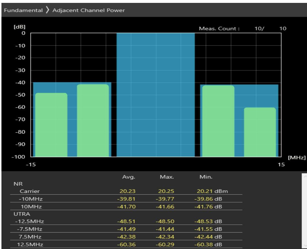
n8 SCS=30kHz DFT_QPSK BW=10MHz Channel=182000 RB=12@6
