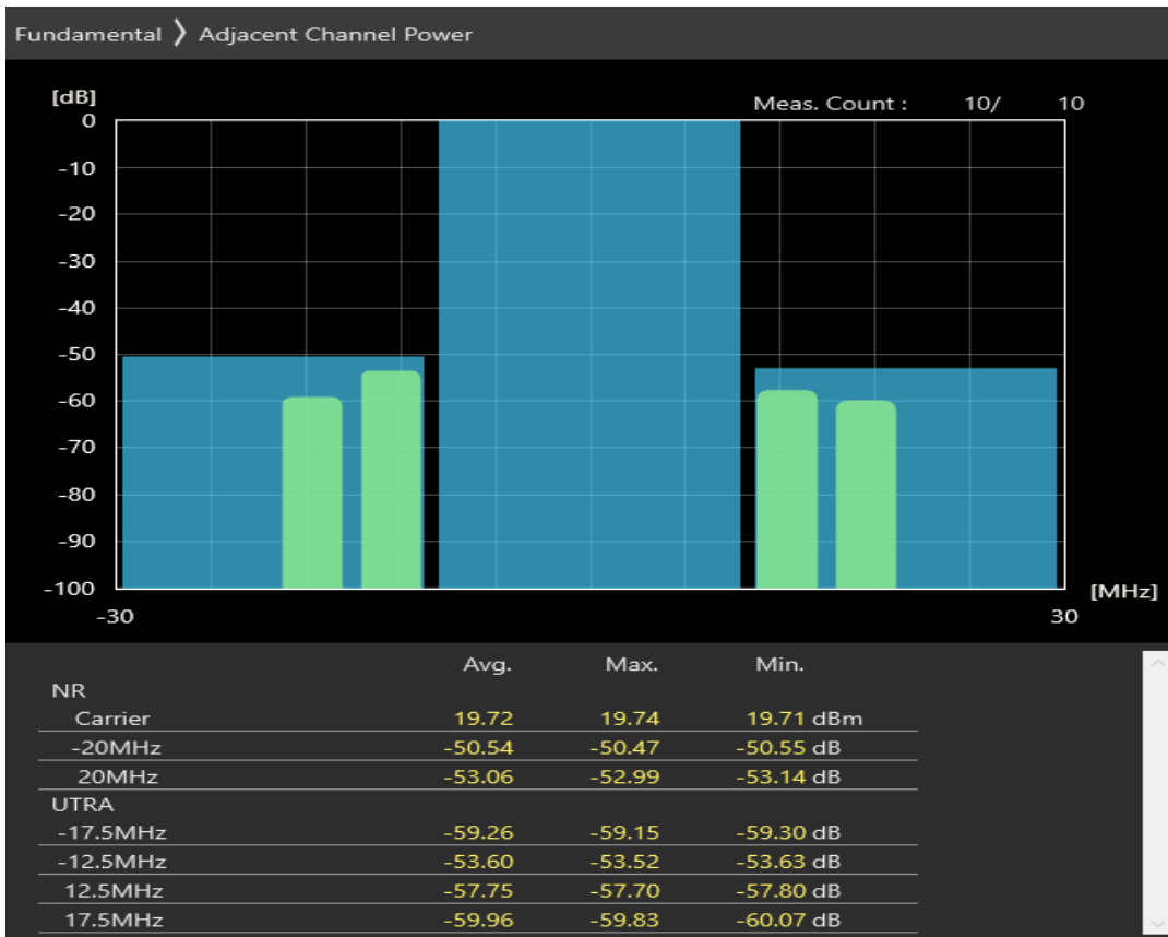
n20 SCS=30kHz DFT_QPSK BW=20MHz Channel=168400 RB=50@0
