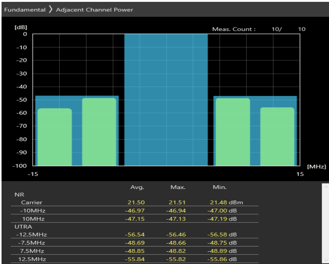
n8 SCS=30kHz CP_QPSK BW=10MHz Channel=177000 RB=1@0
