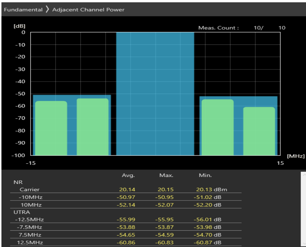
n28 SCS=30kHz DFT_BPSK BW=10MHz Channel=148600 RB=24@0
