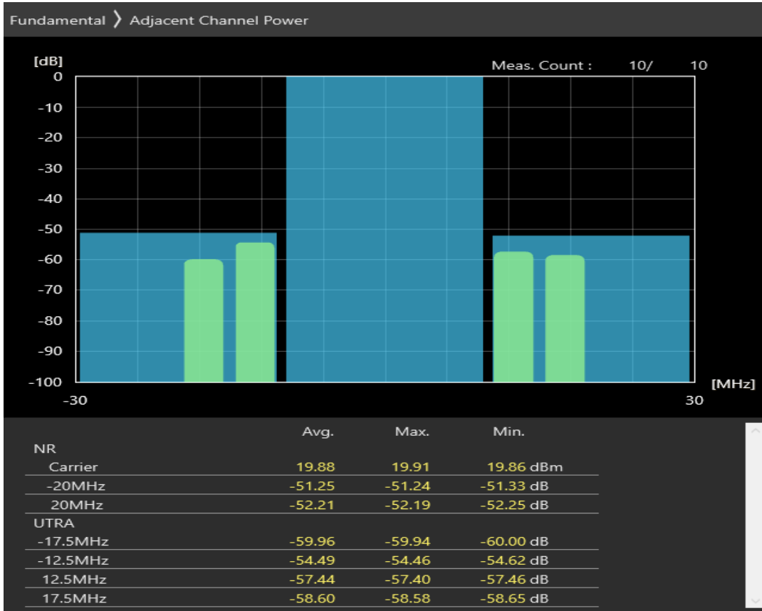
n28 SCS=30kHz DFT_BPSK BW=20MHz Channel=142600 RB=50@0
