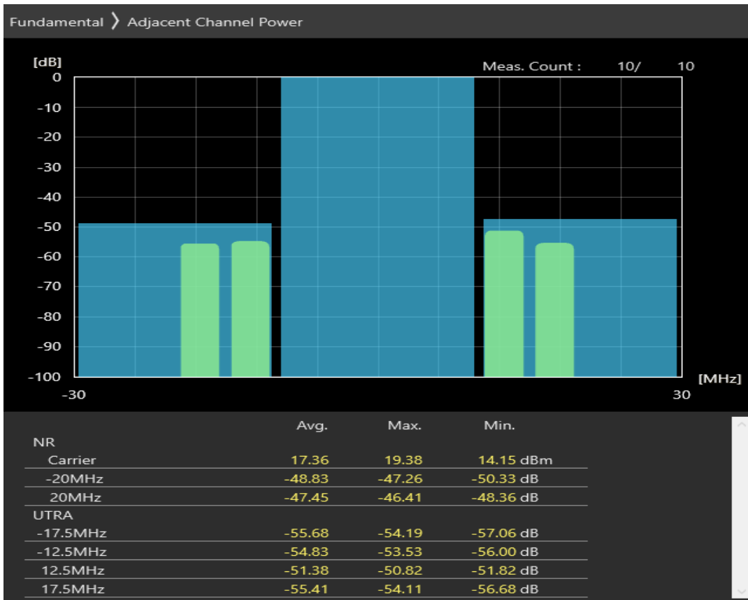
n1 SCS=30kHz DFT_QAM64 BW=20MHz Channel=394000 RB=50@0
