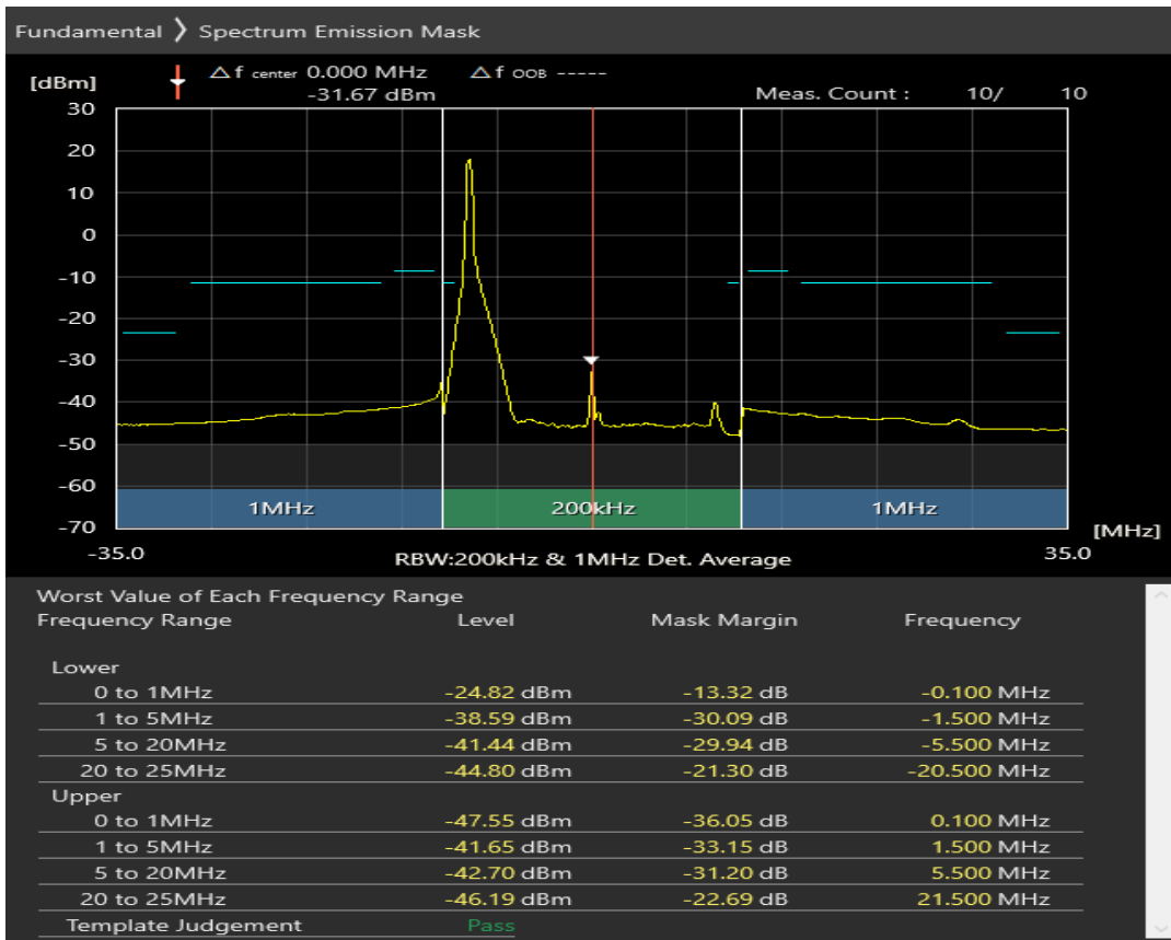
n8 SCS=30kHz CP_QAM16 BW=20MHz Channel=178000 RB=1@0
