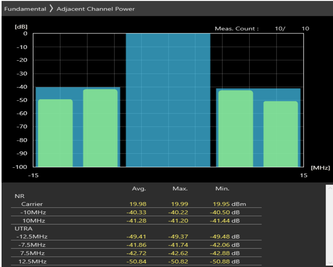
n1 SCS=30kHz CP_QPSK BW=10MHz Channel=395000 RB=1@23
