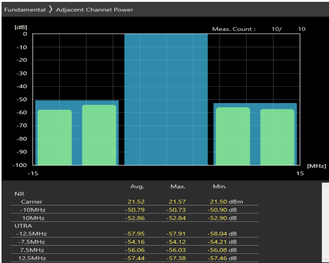
n8 SCS=30kHz DFT_QAM256 BW=10MHz Channel=177000 RB=24@0
