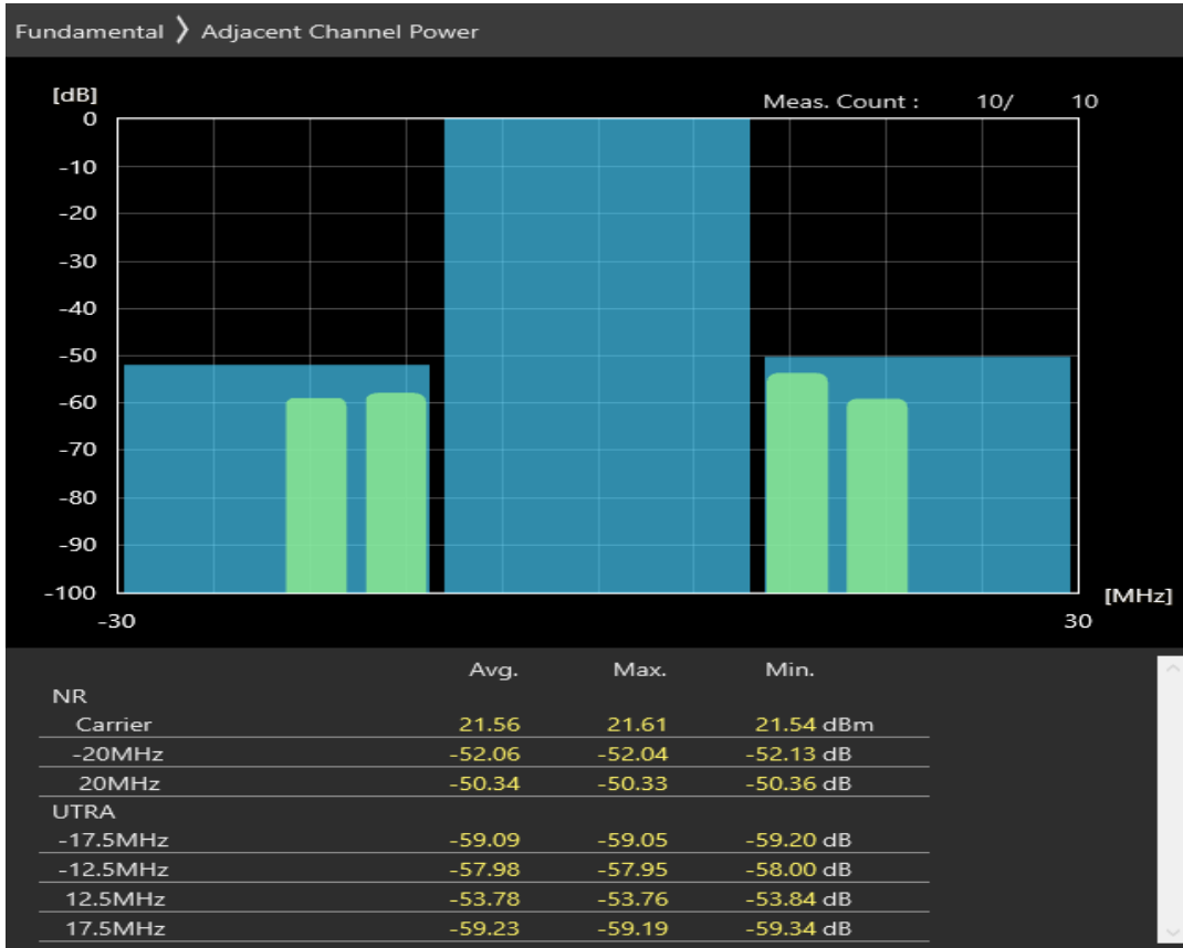
n8 SCS=30kHz DFT_QAM16 BW=20MHz Channel=181000 RB=50@0
