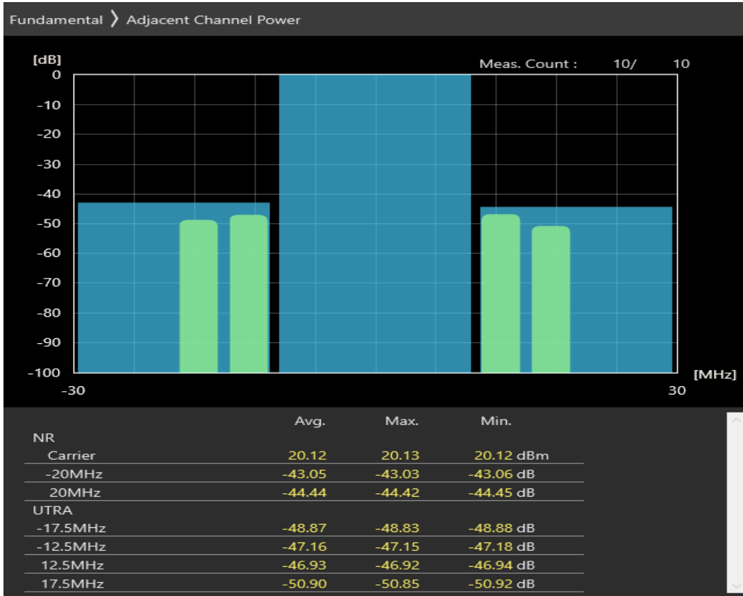
n20 SCS=30kHz CP_QPSK BW=20MHz Channel=170400 RB=25@12
