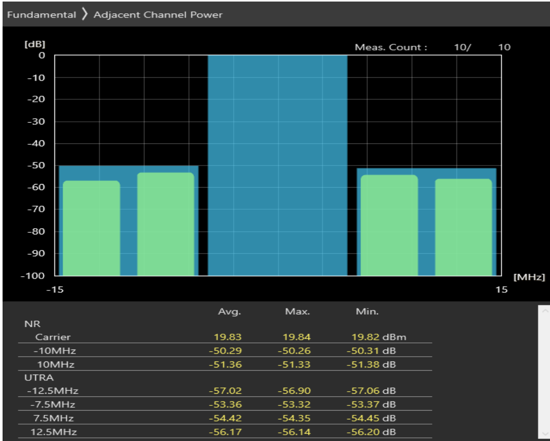
n20 SCS=30kHz CP_QAM256 BW=10MHz Channel=167400 RB=24@0
