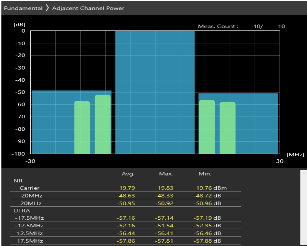
n20 SCS=30kHz CP_QAM64 BW=20MHz Channel=168400 RB=51@0
