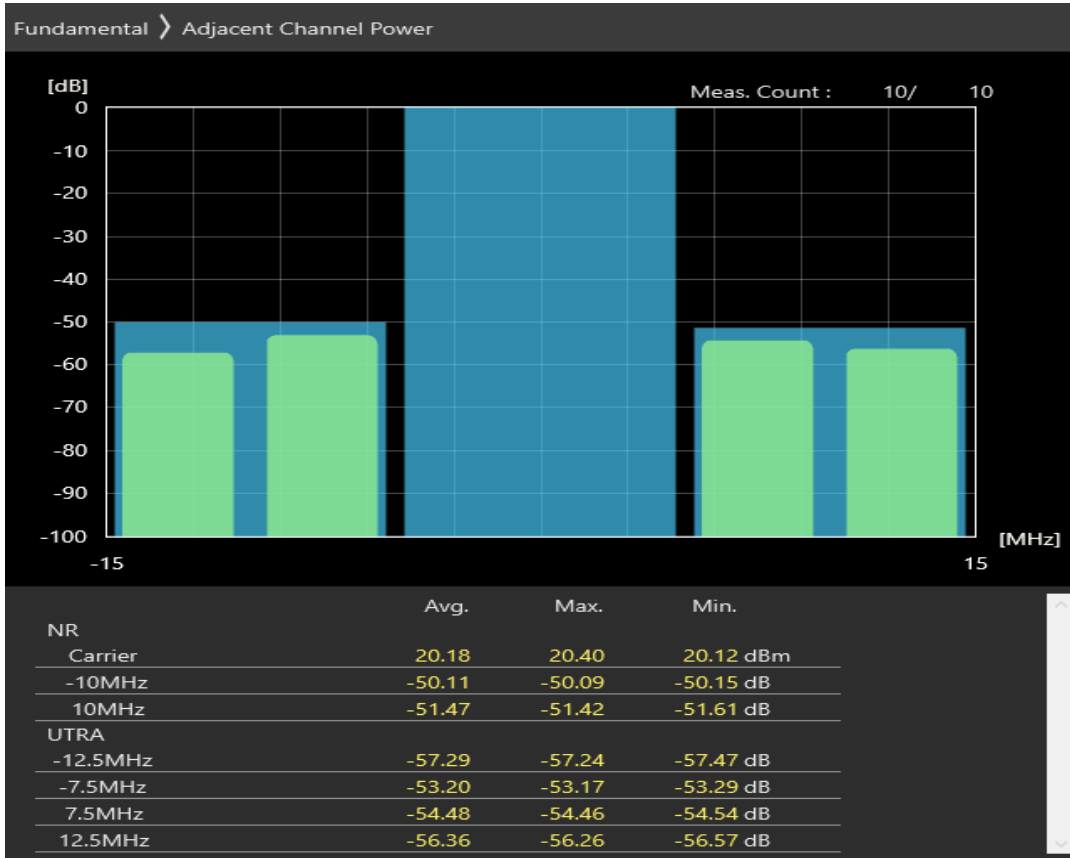
n20 SCS=30kHz CP_QAM16 BW=10MHz Channel=167400 RB=24@0
