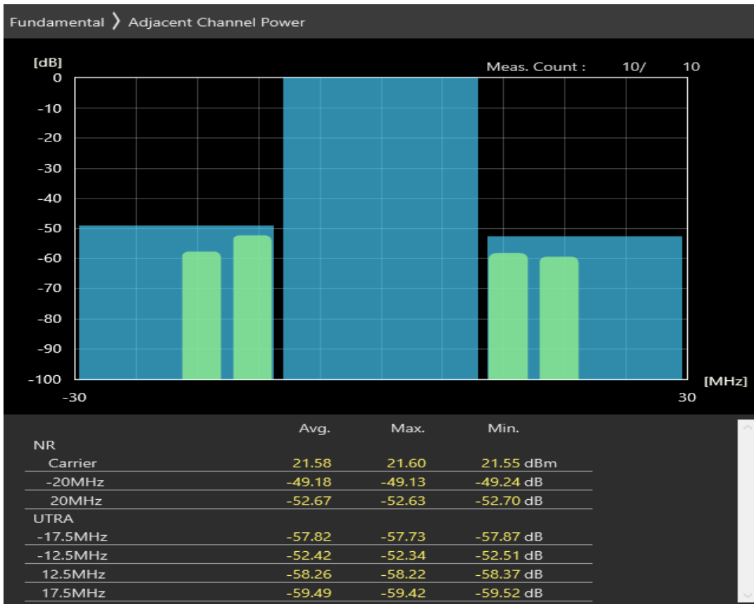
n8 SCS=30kHz DFT_QAM16 BW=20MHz Channel=178000 RB=50@0
