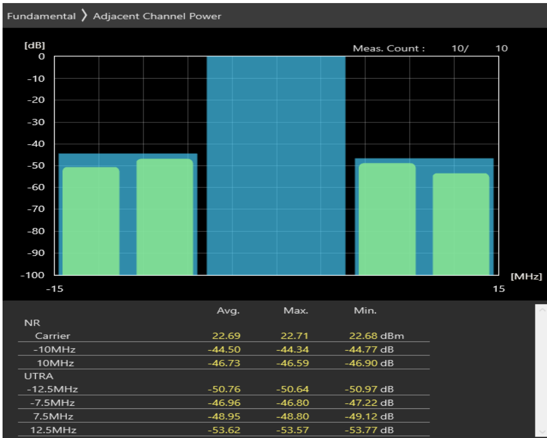
n3 SCS=30kHz DFT_BPSK BW=10MHz Channel=356000 RB=24@0
