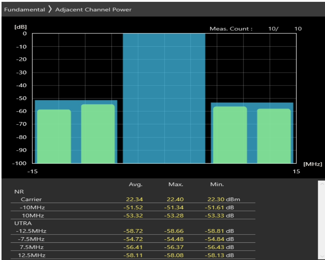
n20 SCS=30kHz DFT_QPSK BW=10MHz Channel=167400 RB=24@0
