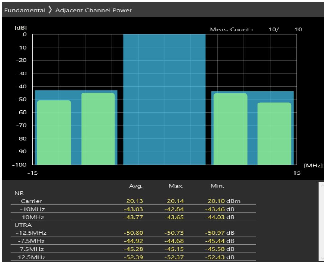
n20 SCS=30kHz DFT_BPSK BW=20MHz Channel=168400 RB=25@12
