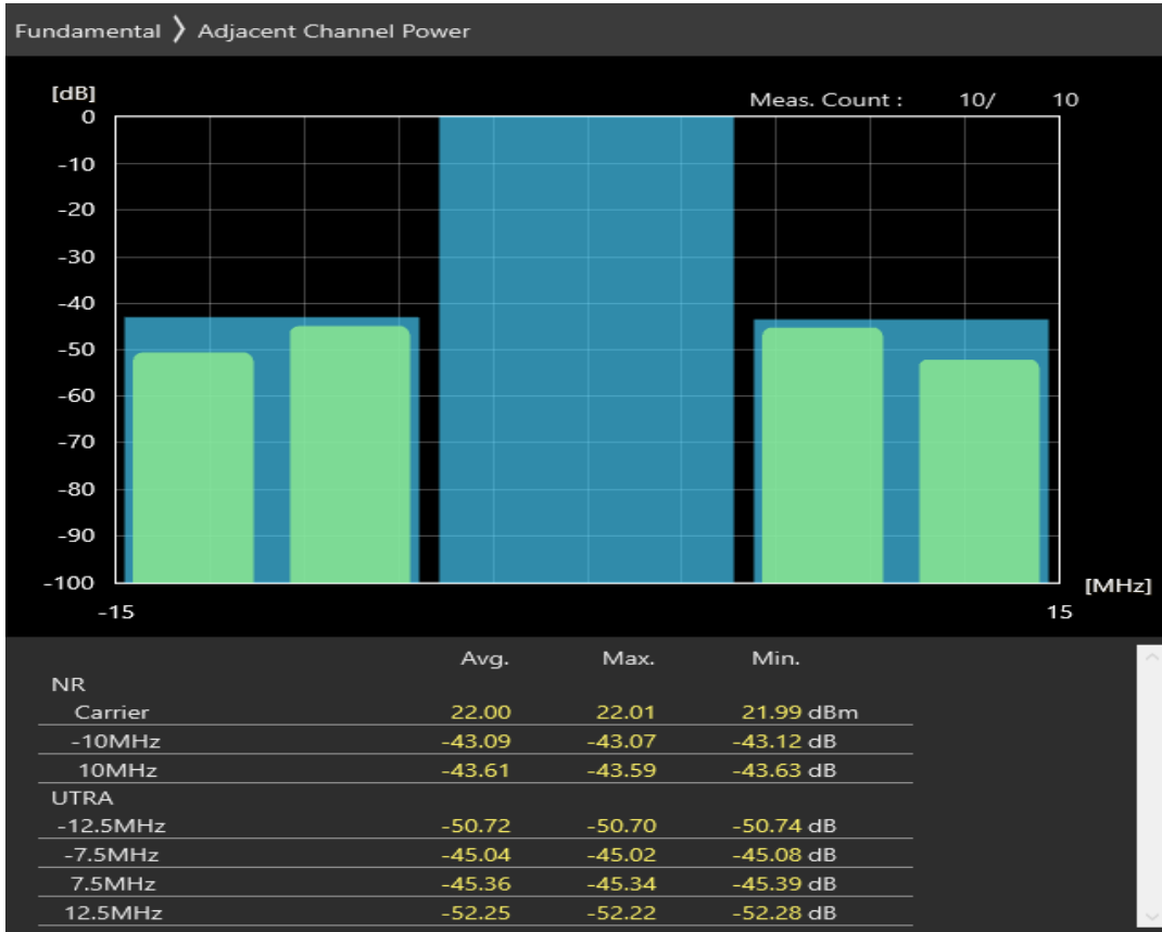
n1 SCS=30kHz DFT_QPSK BW=20MHz Channel=386000 RB=1@0
