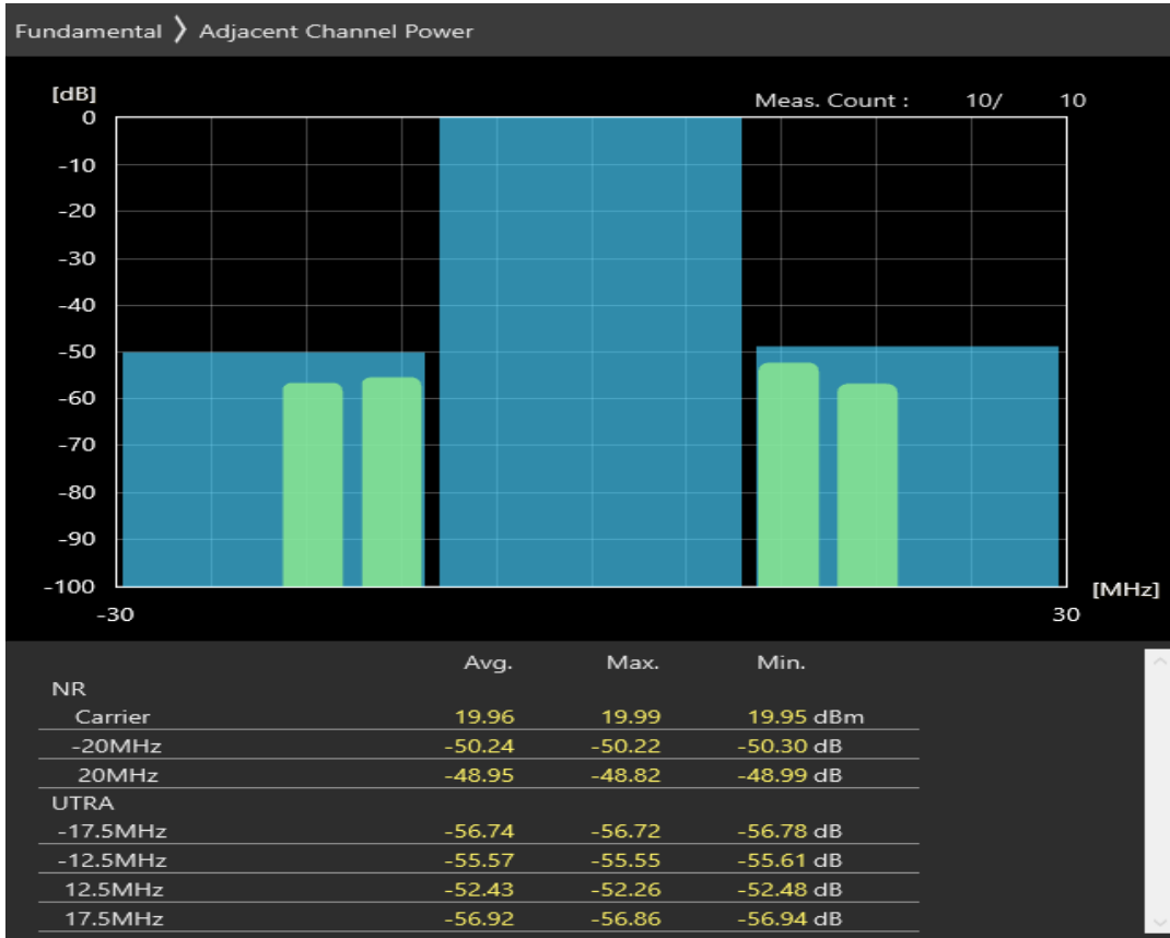
n20 SCS=30kHz DFT_QPSK BW=20MHz Channel=170400 RB=50@0
