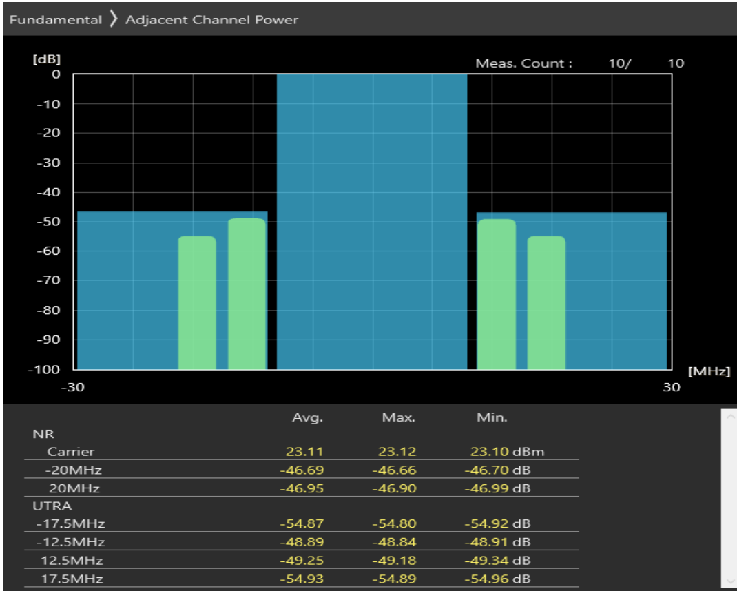
n38 SCS=30kHz CP_QPSK BW=20MHz Channel=516000 RB=1@0
