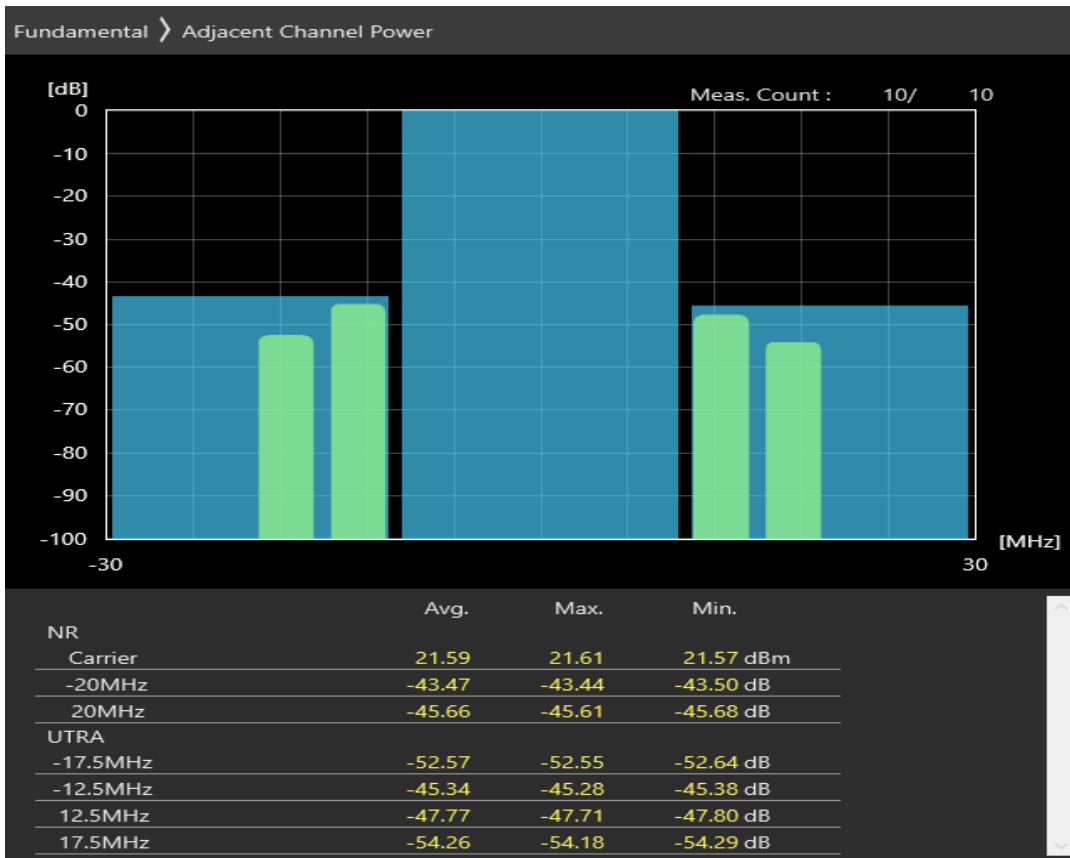
n1 SCS=30kHz CP_QPSK BW=20MHz Channel=394000 RB=51@0
