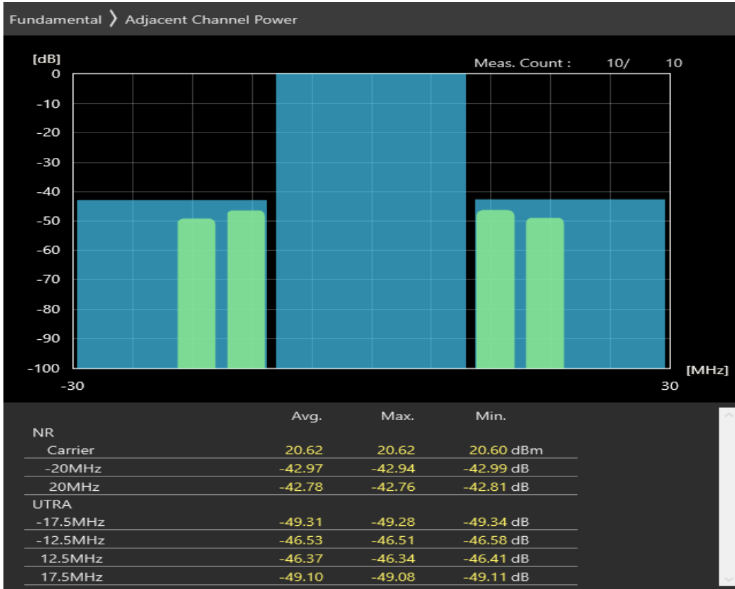
n38 SCS=30kHz CP_QPSK BW=20MHz Channel=522000 RB=25@12
