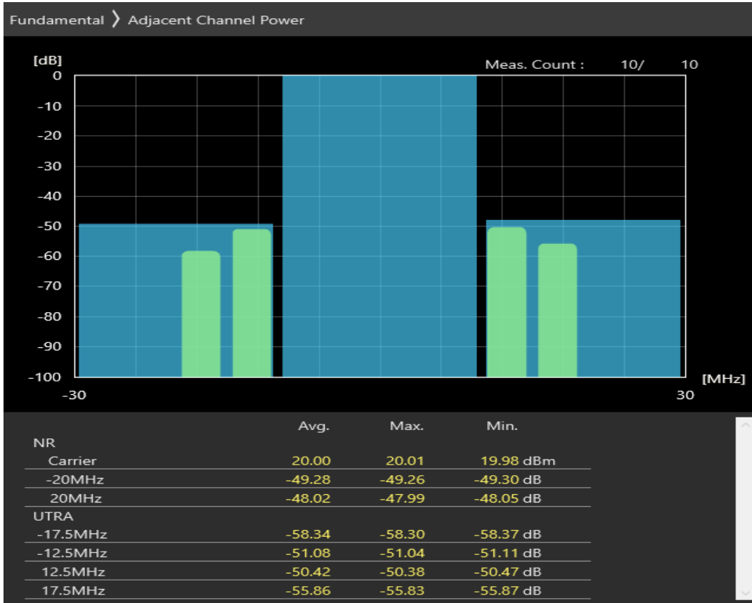
n20 SCS=30kHz DFT_QPSK BW=20MHz Channel=168400 RB=1@0
