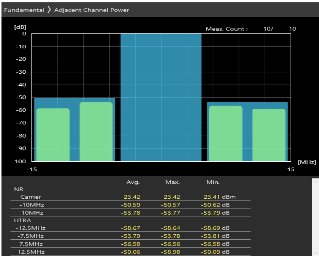
n38 SCS=30kHz DFT_QPSK BW=10MHz Channel=515000 RB=24@0
