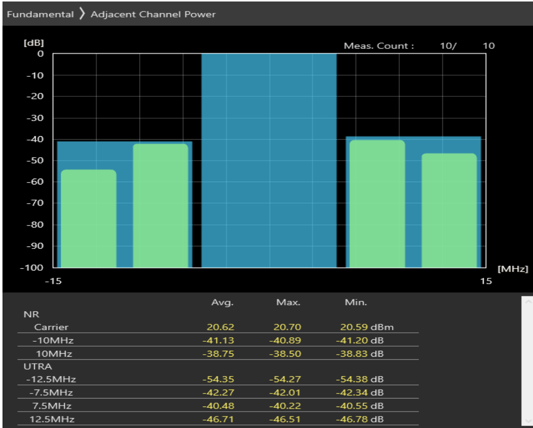
n28 SCS=30kHz CP_QPSK BW=10MHz Channel=141600 RB=1@0
