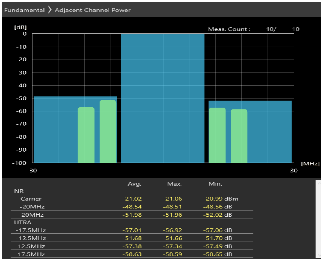
n38 SCS=30kHz CP_QAM256 BW=20MHz Channel=516000 RB=51@0
