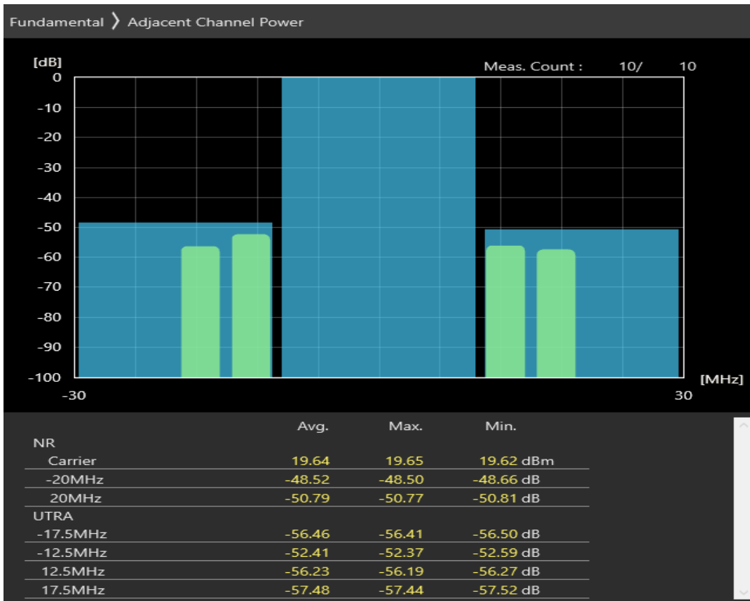
n1 SCS=30kHz DFT_QAM256 BW=20MHz Channel=386000 RB=50@0
