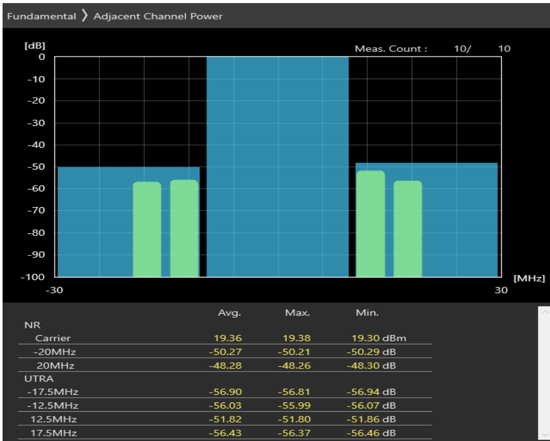
n1 SCS=30kHz DFT_QAM256 BW=20MHz Channel=394000 RB=50@0
