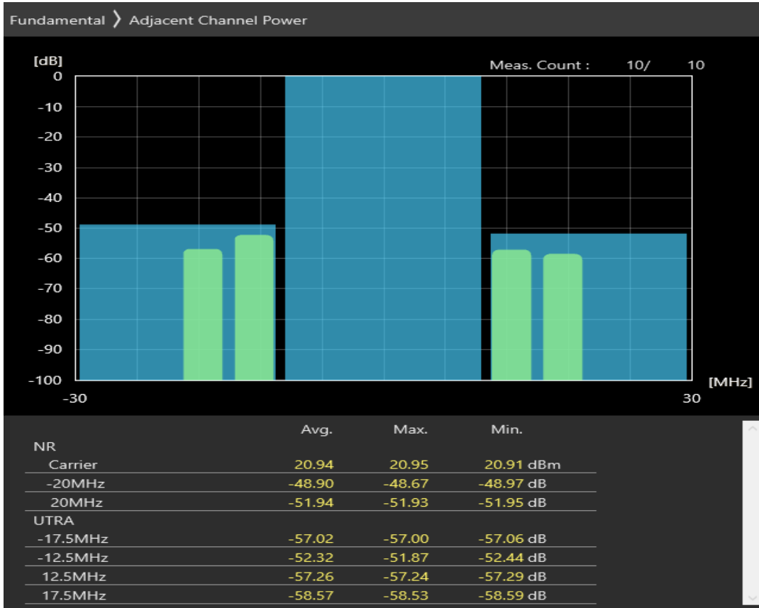
n38 SCS=30kHz DFT_QAM64 BW=20MHz Channel=516000 RB=50@0
