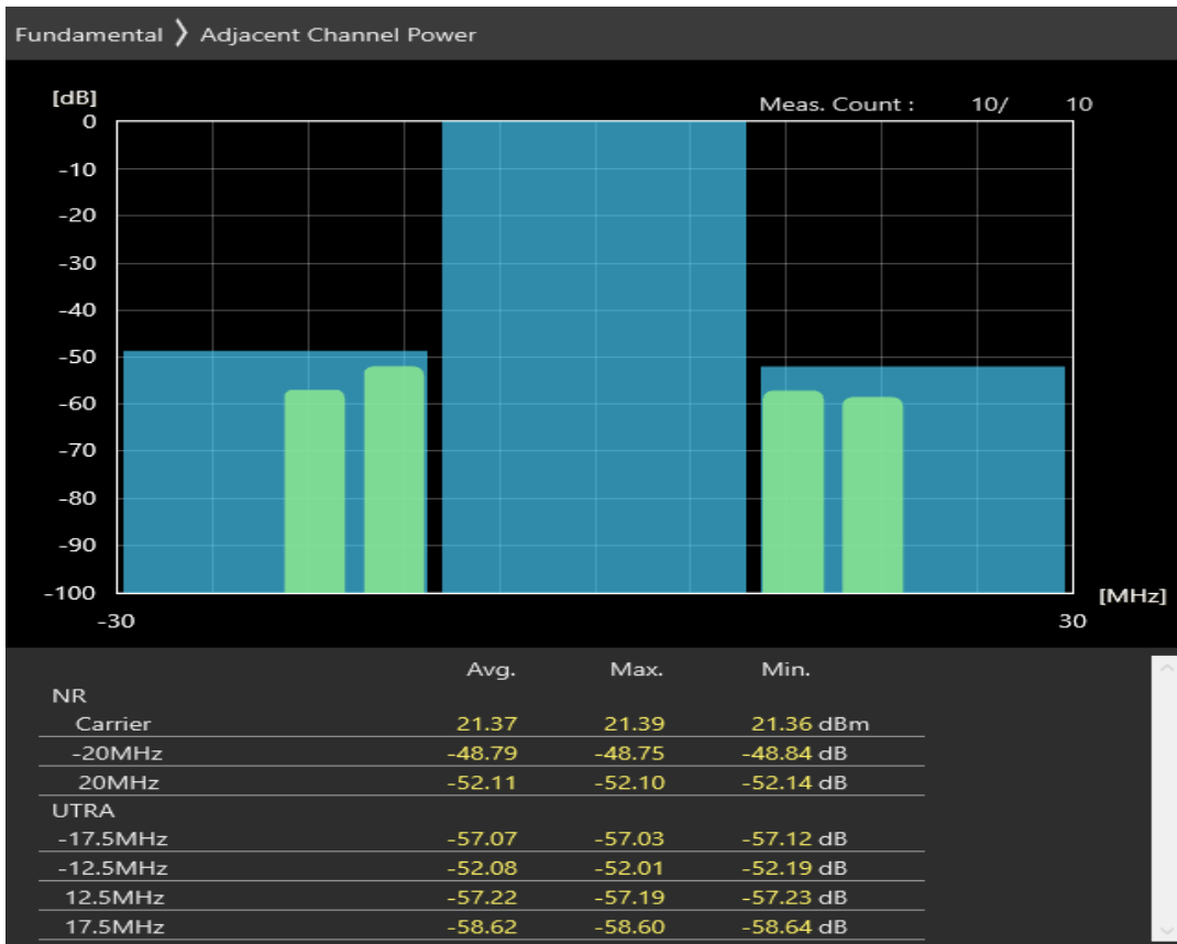
n38 SCS=30kHz CP_QPSK BW=20MHz Channel=516000 RB=51@0
