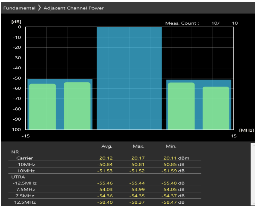
n8 SCS=30kHz CP_QAM256 BW=10MHz Channel=182000 RB=24@0
