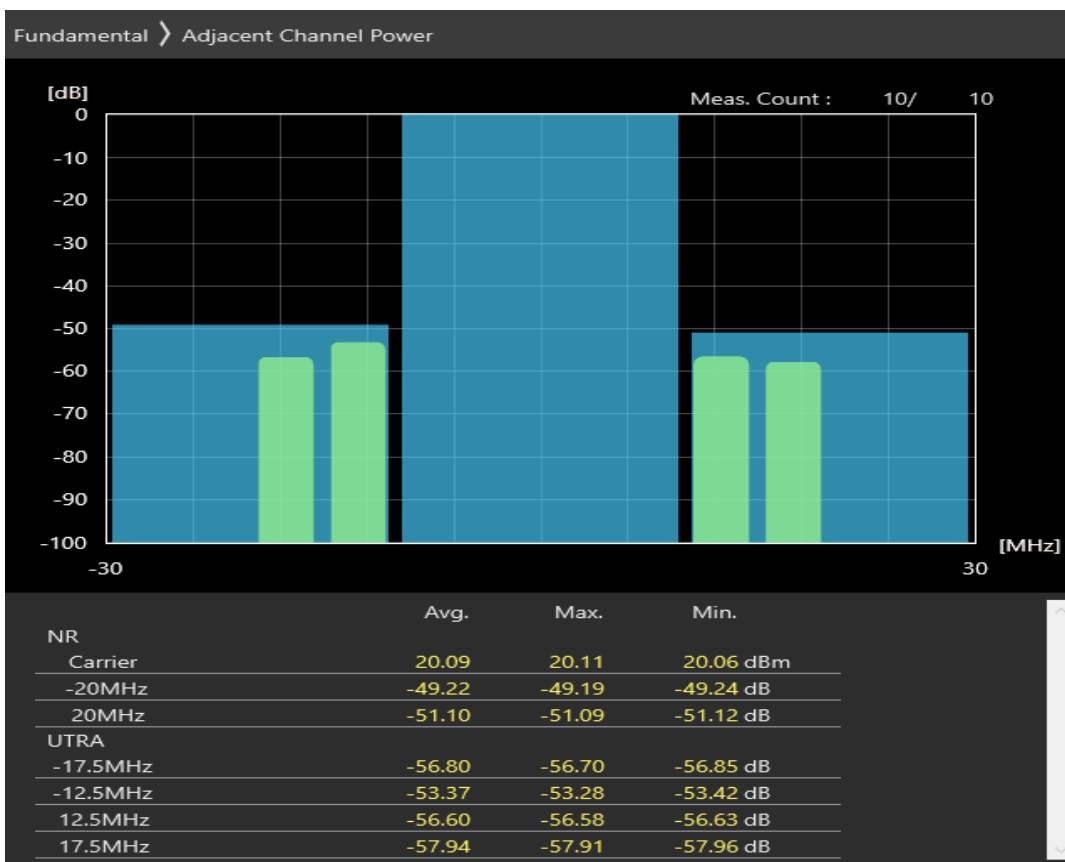
n8 SCS=30kHz DFT_BPSK BW=20MHz Channel=178000 RB=50@0
