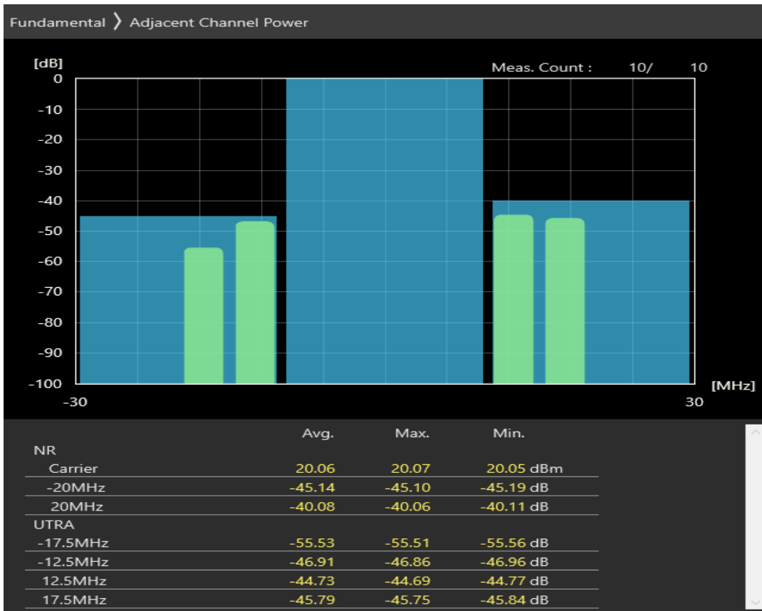
n28 SCS=30kHz DFT_QPSK BW=20MHz Channel=142600 RB=25@12
