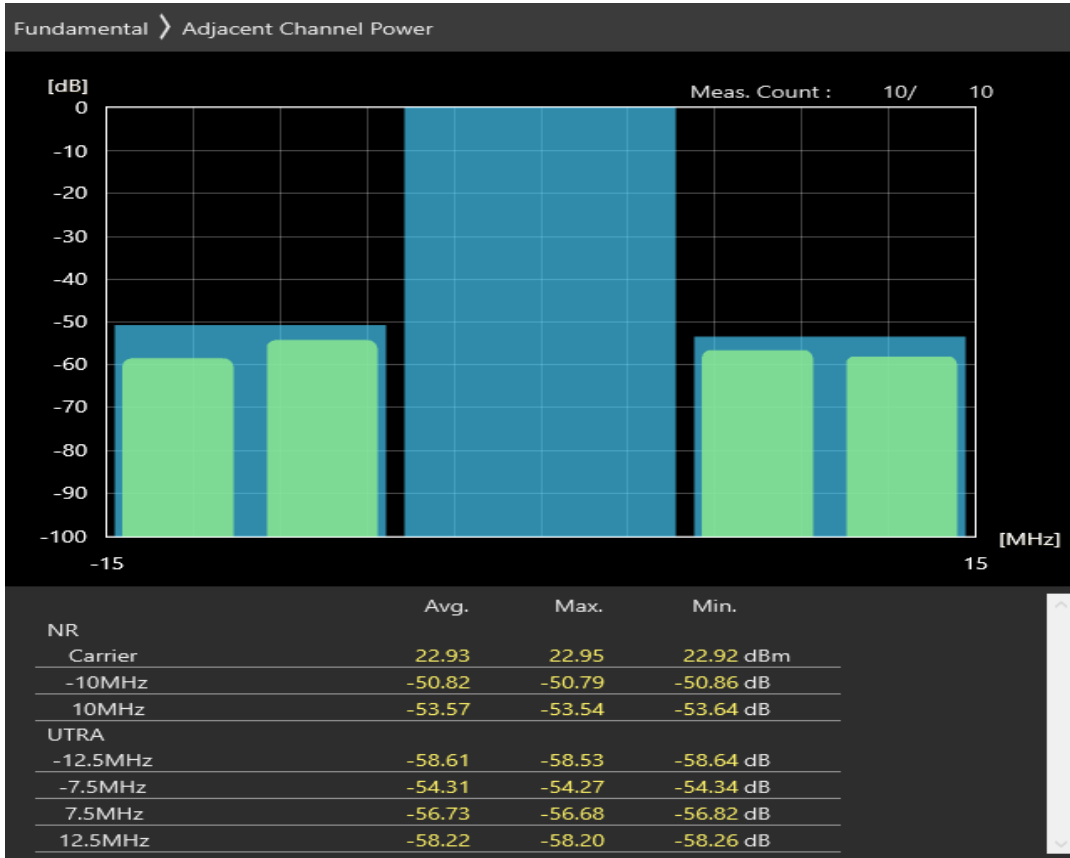
n8 SCS=30kHz DFT_QPSK BW=10MHz Channel=177000 RB=24@0
