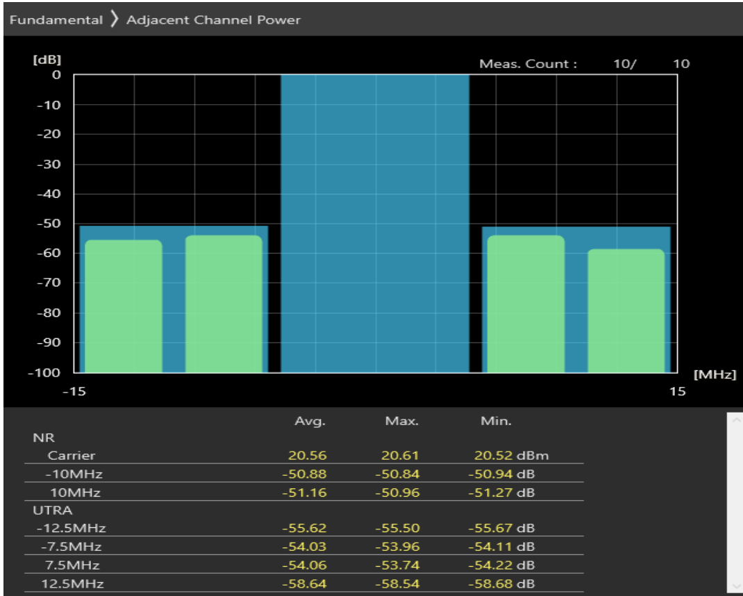
n8 SCS=30kHz CP_QAM16 BW=10MHz Channel=182000 RB=24@0
