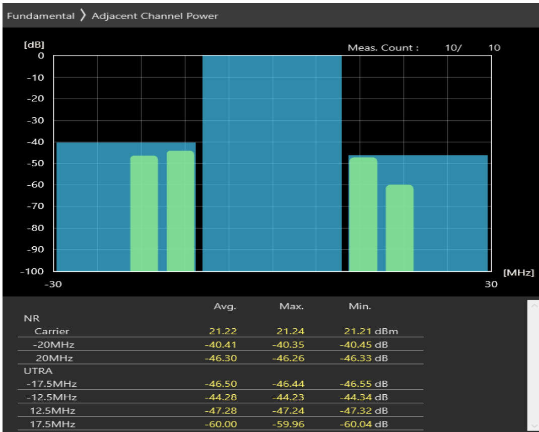
n8 SCS=30kHz CP_QPSK BW=20MHz Channel=181000 RB=25@12
