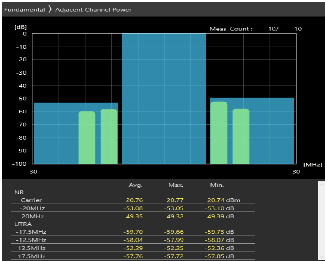
n38 SCS=30kHz DFT_BPSK BW=20MHz Channel=522000 RB=50@0
