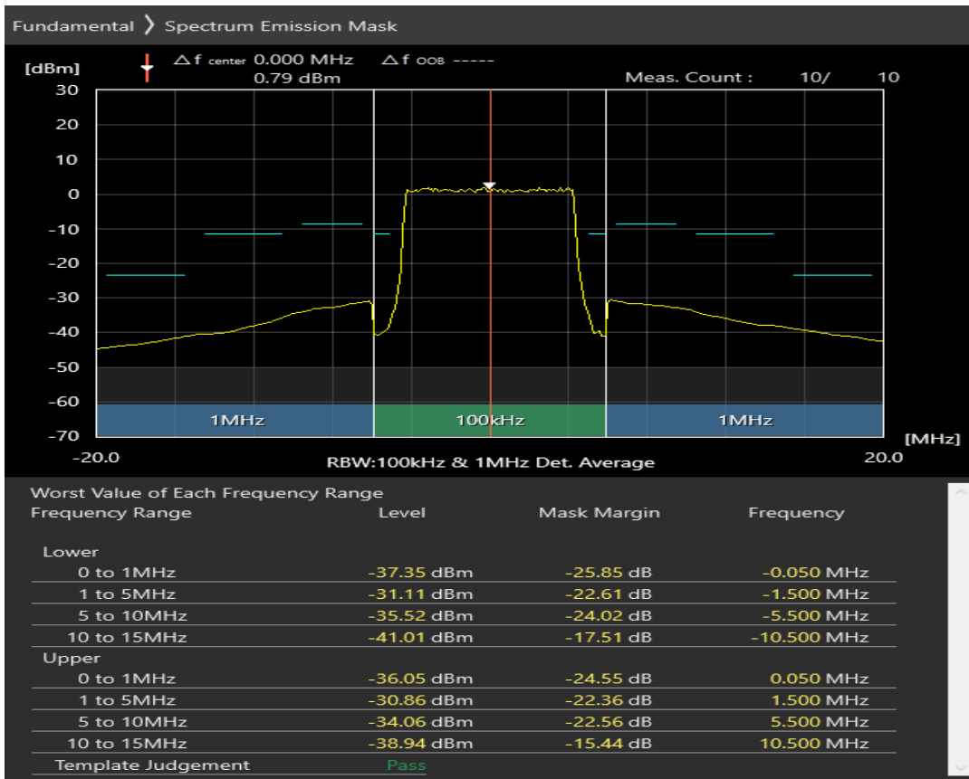
n1 SCS=30kHz CP_QPSK BW=10MHz Channel=385000 RB=1@0
