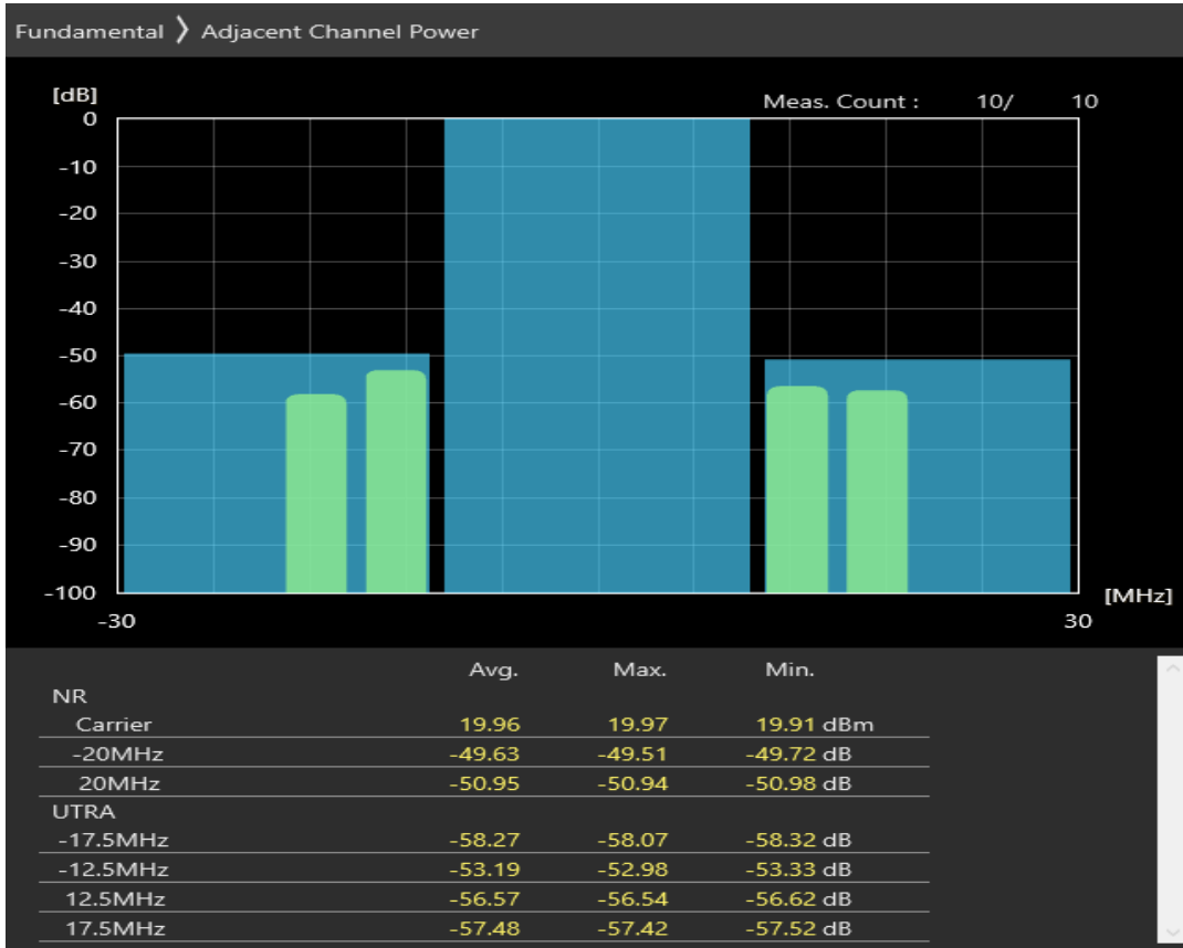
n28 SCS=30kHz DFT_QAM256 BW=20MHz Channel=142600 RB=50@0
