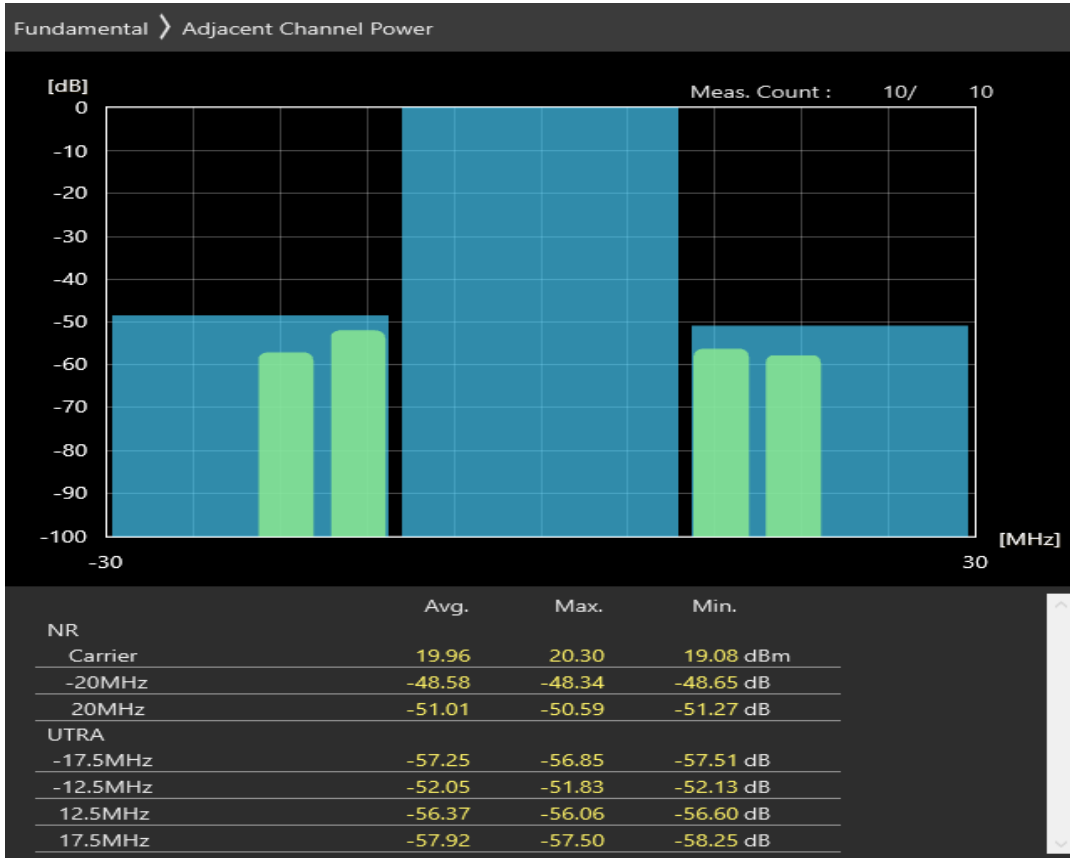
n20 SCS=30kHz CP_QAM16 BW=20MHz Channel=168400 RB=51@0
