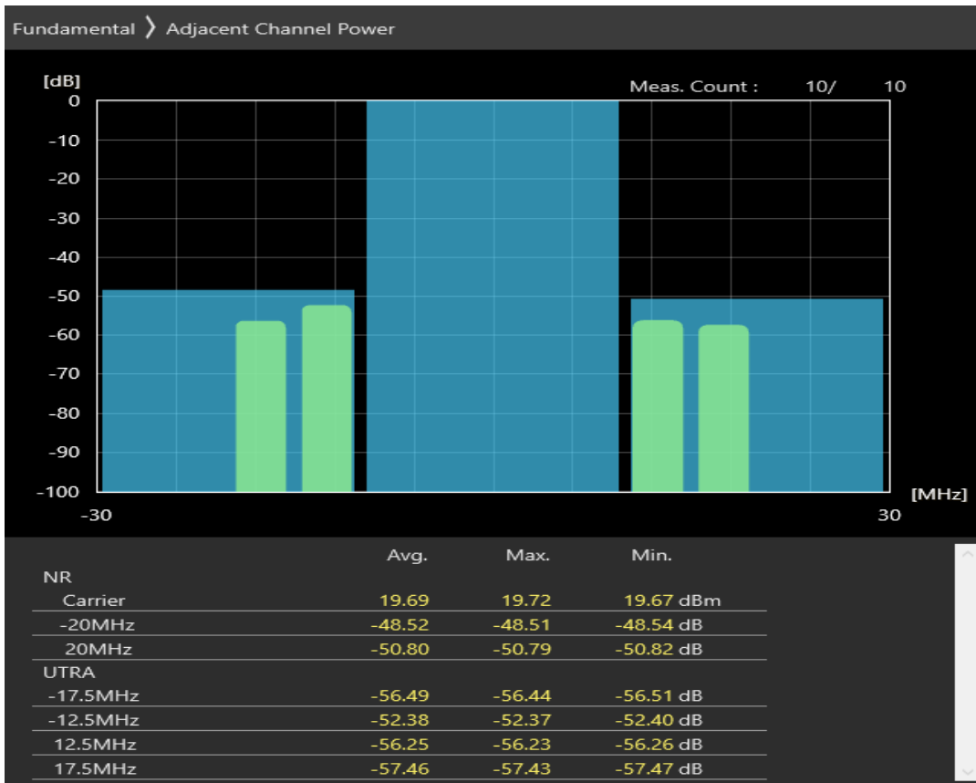
n1 SCS=30kHz DFT_QAM64 BW=20MHz Channel=386000 RB=50@0
