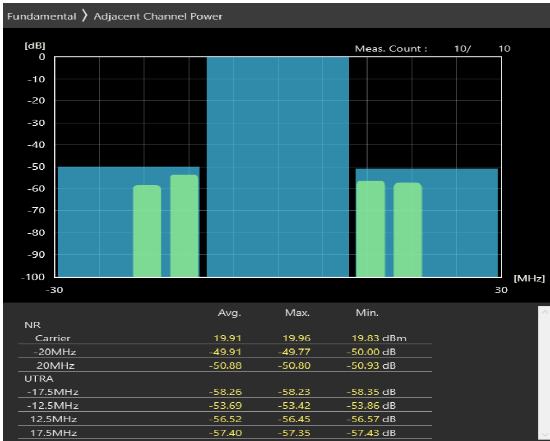
n28 SCS=30kHz DFT_QPSK BW=20MHz Channel=142600 RB=50@0
