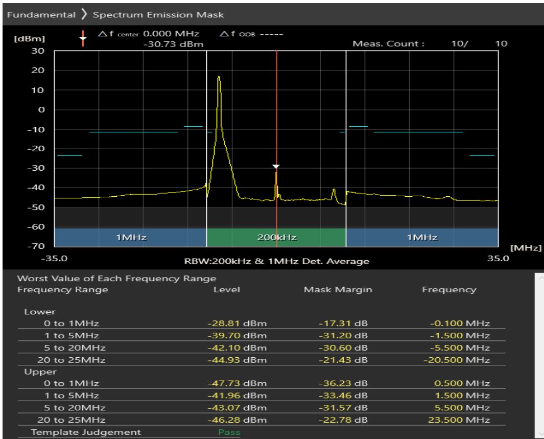
n8 SCS=30kHz CP_QAM256 BW=20MHz Channel=178000 RB=1@0
