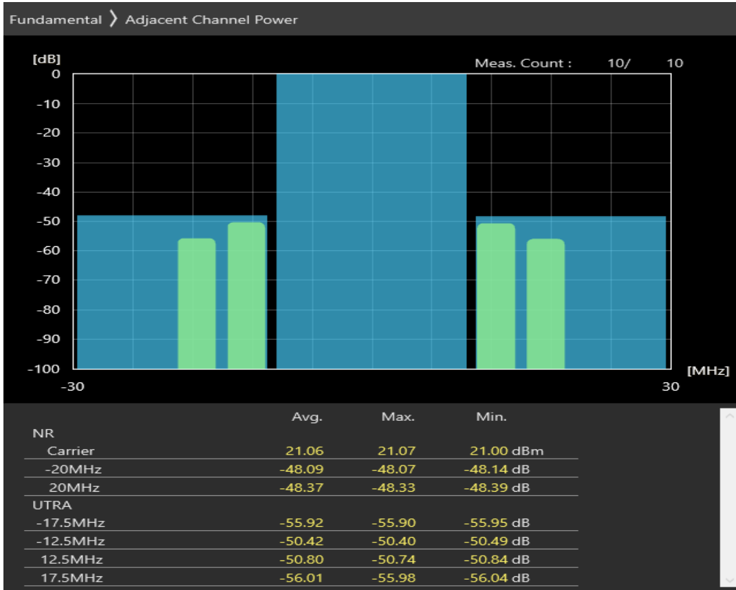
n38 SCS=30kHz DFT_QPSK BW=20MHz Channel=516000 RB=1@0
