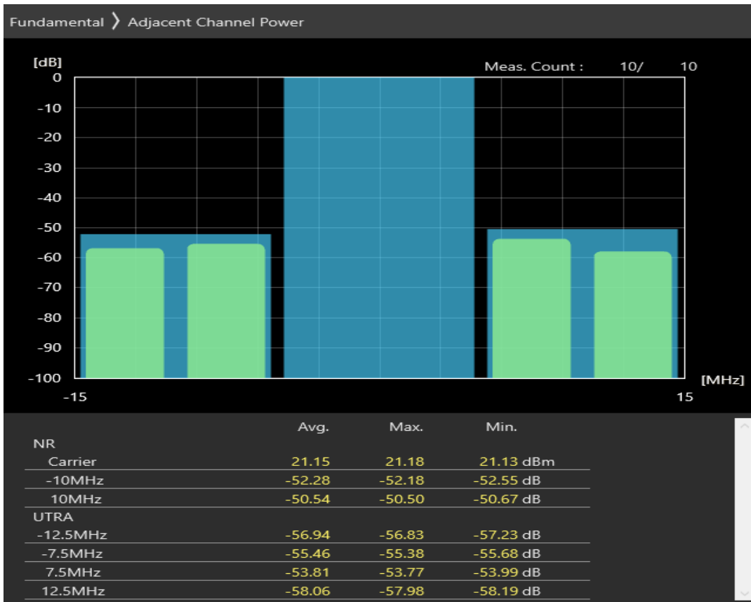
n20 SCS=30kHz DFT_QAM256 BW=10MHz Channel=171400 RB=24@0
