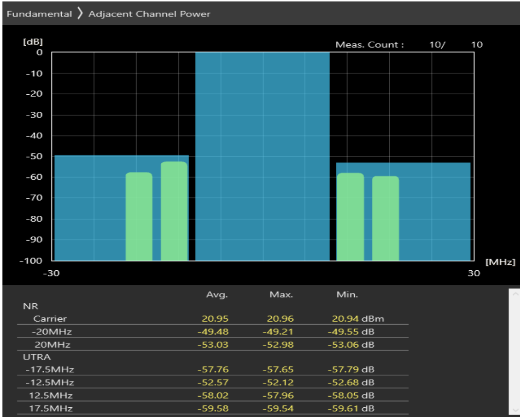
n38 SCS=30kHz DFT_BPSK BW=20MHz Channel=516000 RB=50@0
