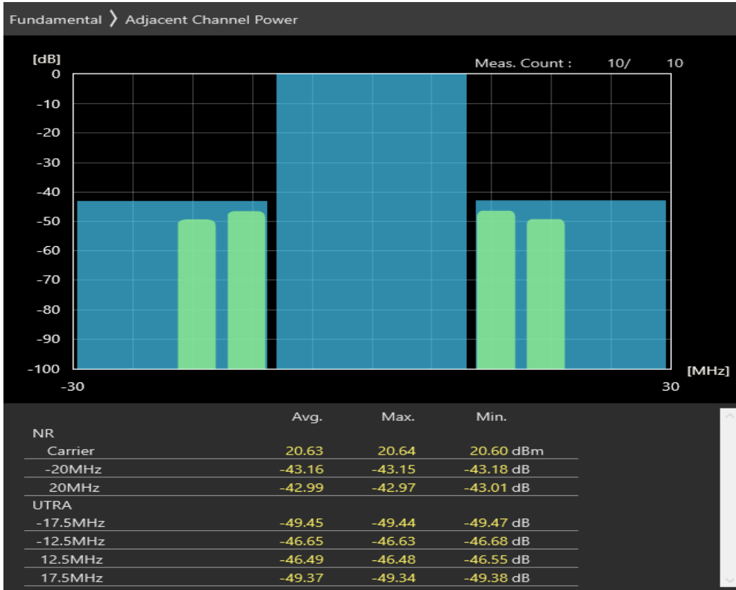
n38 SCS=30kHz DFT_QPSK BW=20MHz Channel=522000 RB=25@12
