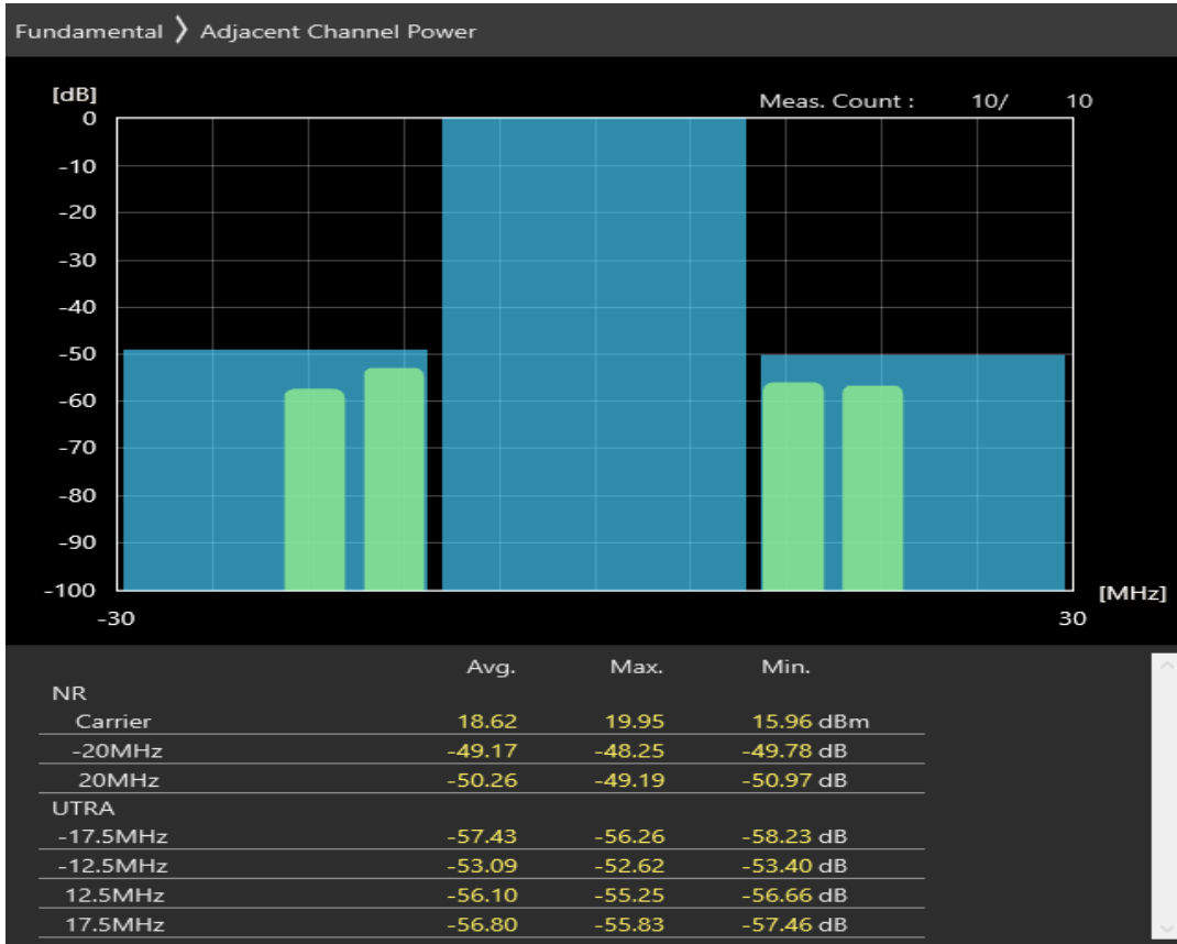
n28 SCS=30kHz DFT_QAM64 BW=20MHz Channel=142600 RB=50@0
