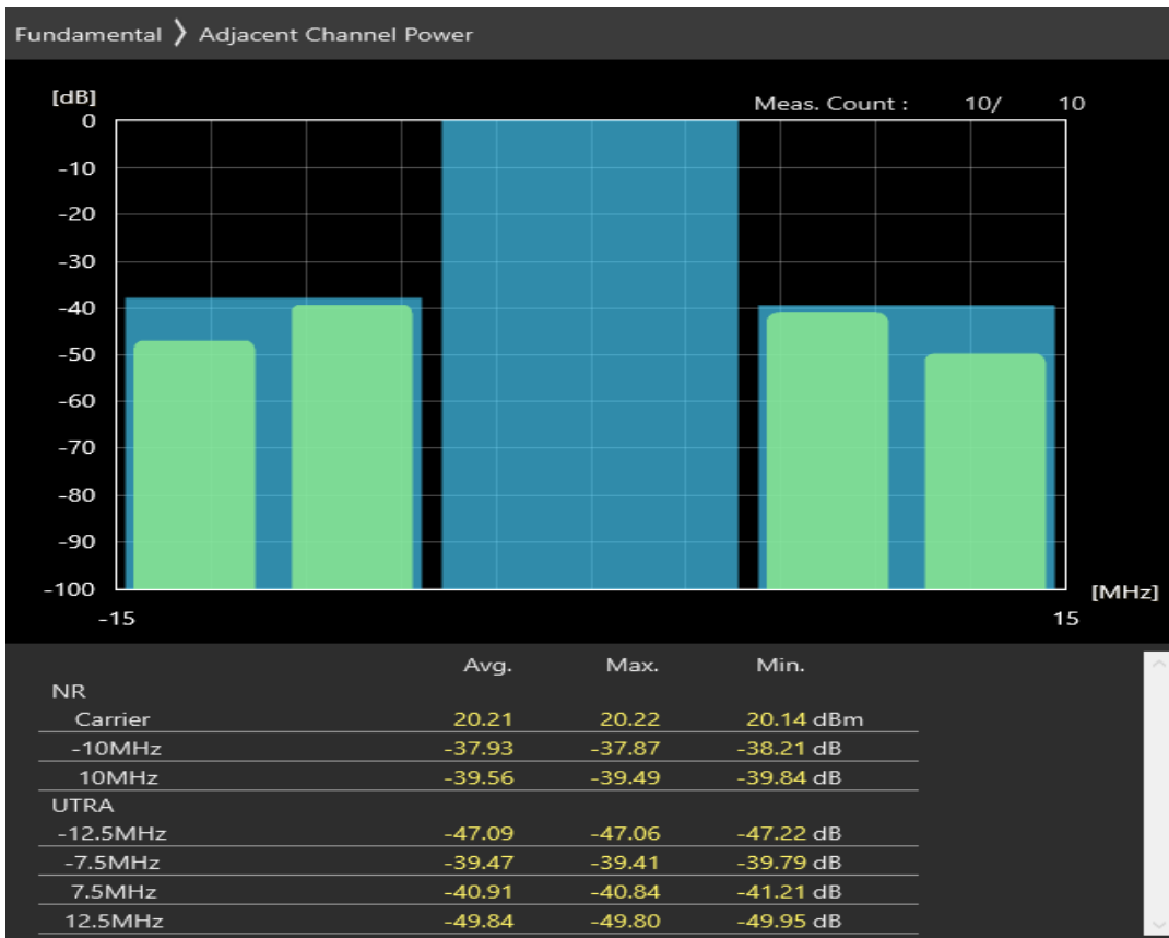
n3 SCS=30kHz CP_QPSK BW=10MHz Channel=356000 RB=1@23
