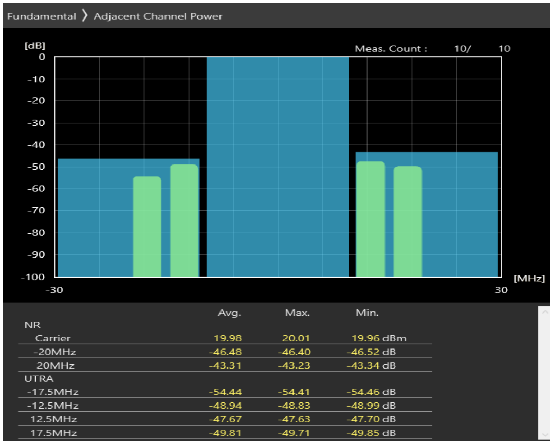
n20 SCS=30kHz CP_QPSK BW=20MHz Channel=168400 RB=25@12
