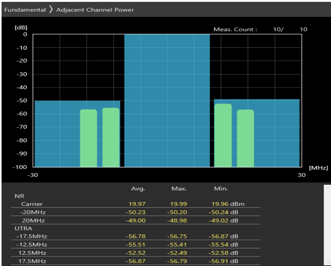
n20 SCS=30kHz DFT_QAM16 BW=20MHz Channel=170400 RB=50@0
