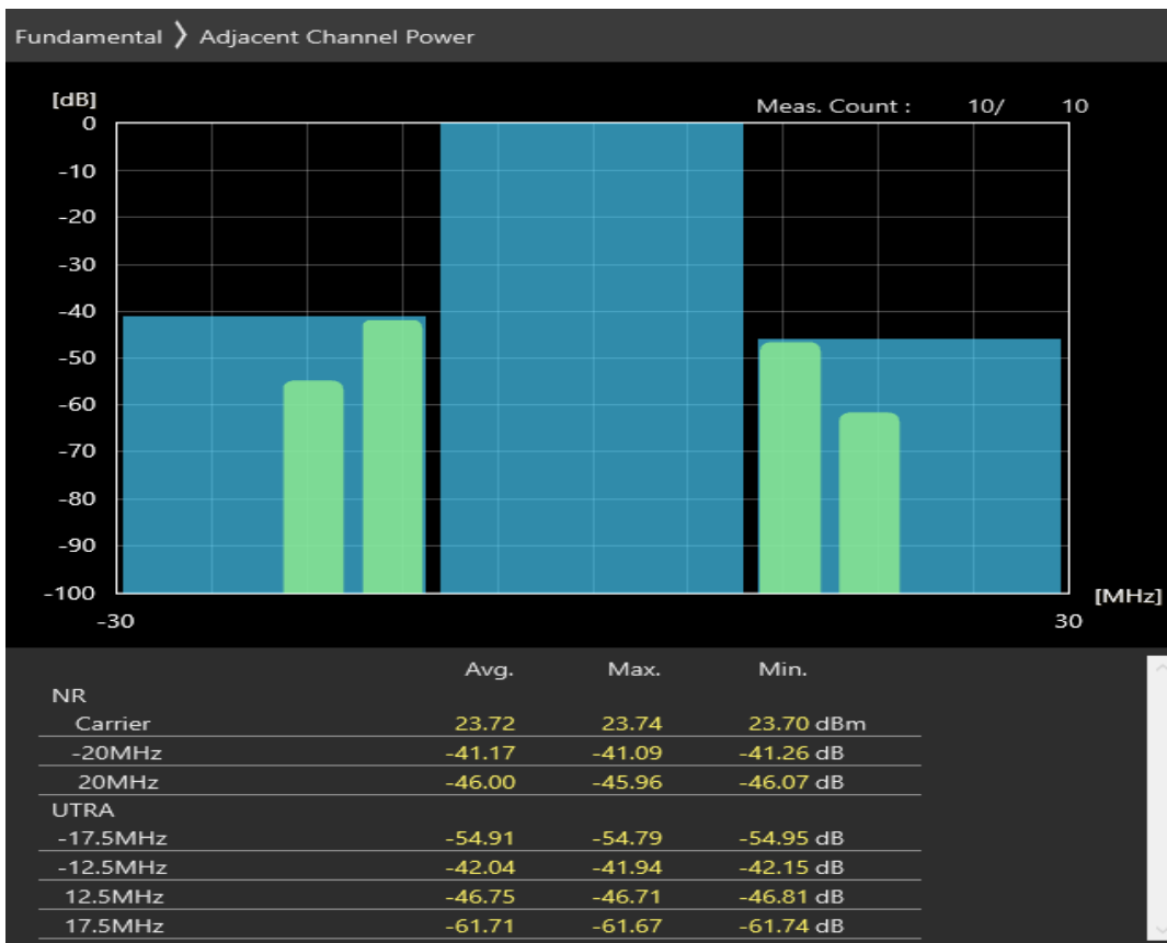
n8 SCS=30kHz DFT_QPSK BW=20MHz Channel=181000 RB=1@50
