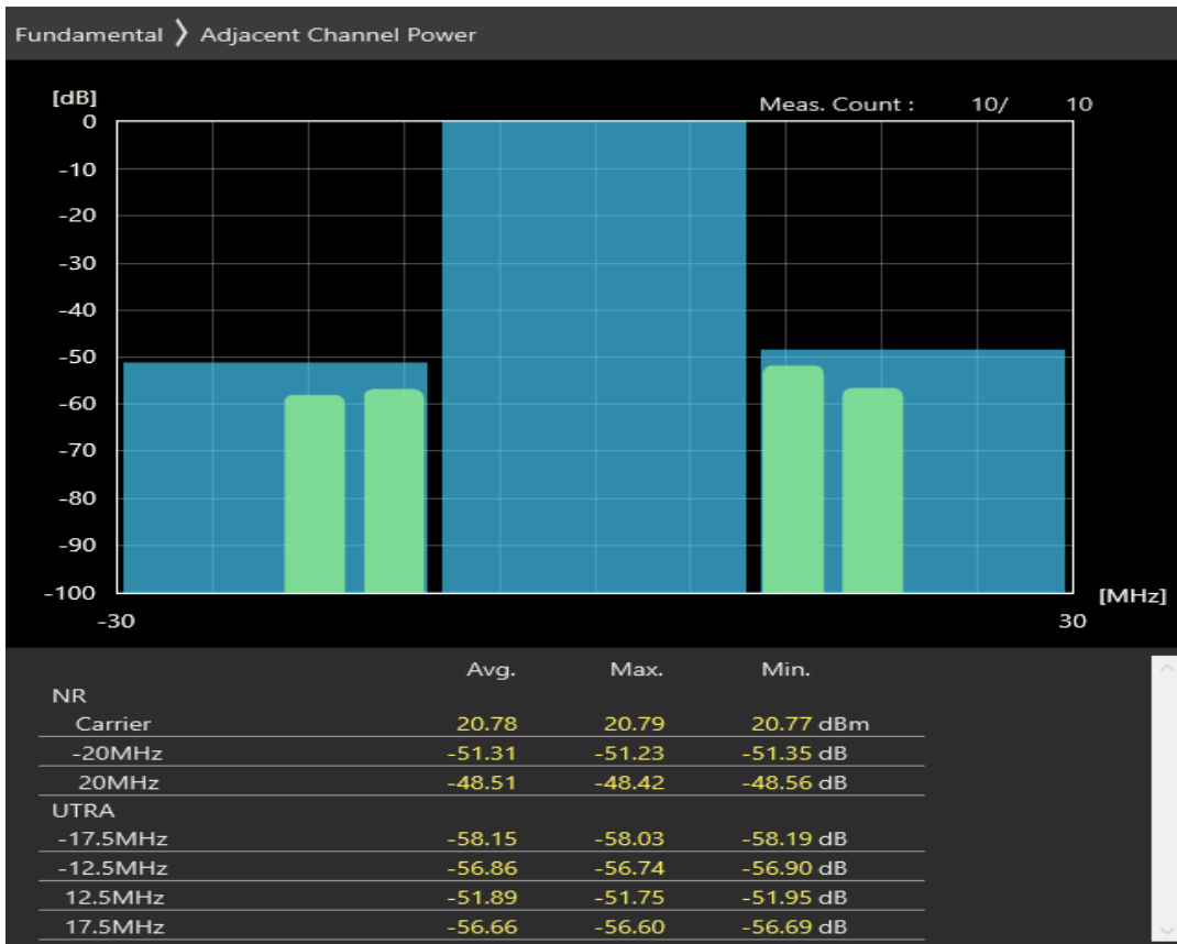
n38 SCS=30kHz DFT_QAM64 BW=20MHz Channel=522000 RB=50@0
