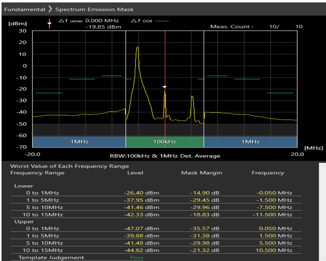
n1 SCS=30kHz DFT_QPSK BW=10MHz Channel=385000 RB=24@0
