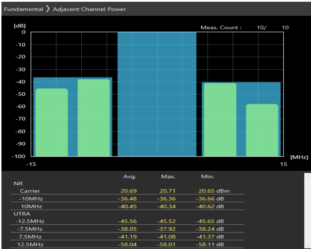
n28 SCS=30kHz CP_QPSK BW=10MHz Channel=148600 RB=1@23
