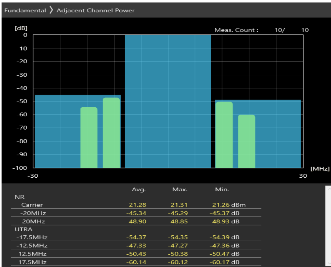
n8 SCS=30kHz CP_QPSK BW=20MHz Channel=181000 RB=1 @50
