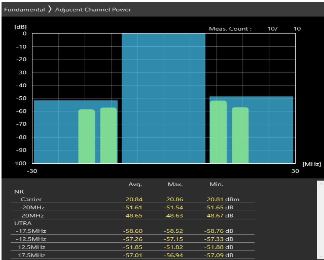
n38 SCS=30kHz DFT_QAM256 BW=20MHz Channel=522000 RB=50@0
