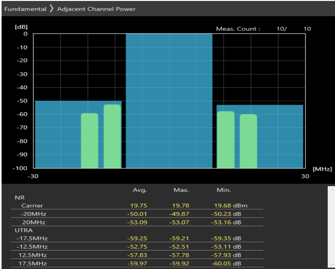
n20 SCS=30kHz DFT_QAM256 BW=20MHz Channel=168400 RB=50@0
