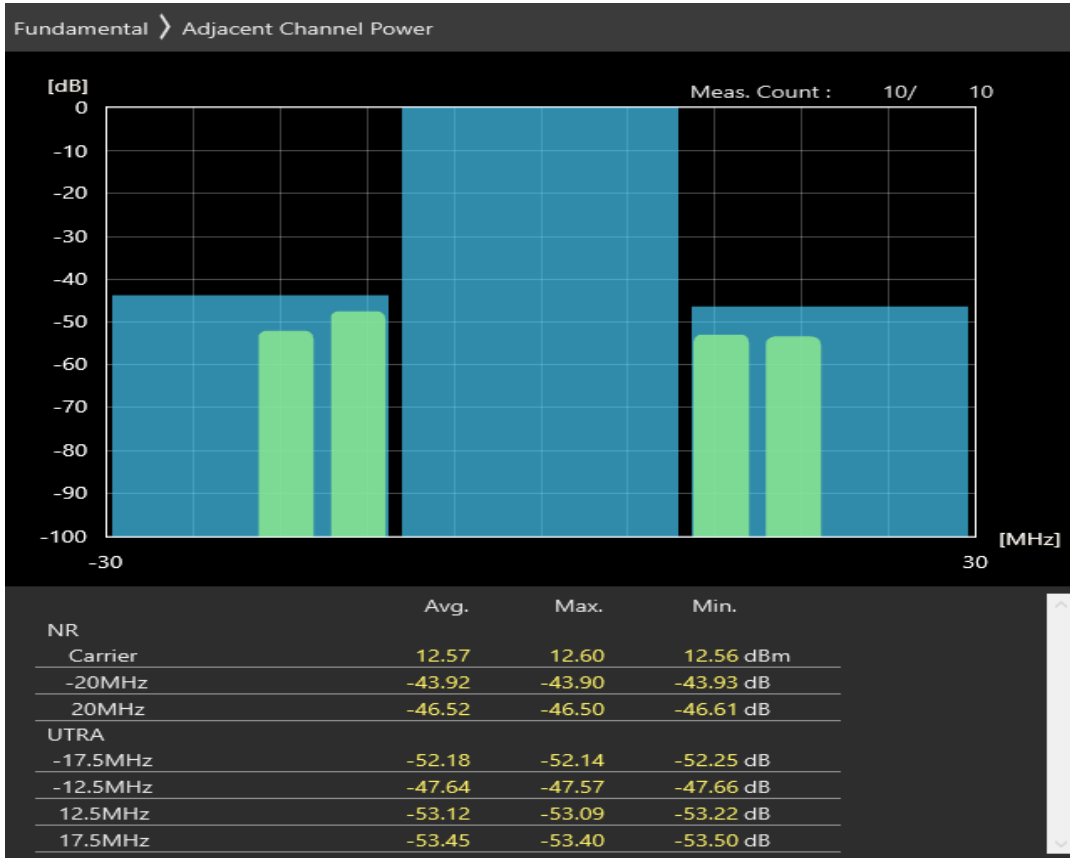
n8 SCS=30kHz CP_QAM256 BW=20MHz Channel=178000 RB=1@0
