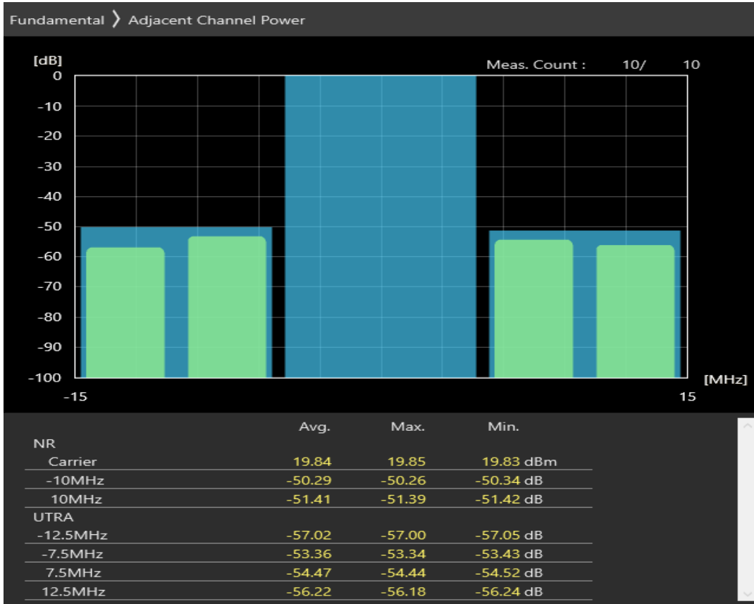
n20 SCS=30kHz CP_QAM64 BW=10MHz Channel=167400 RB=24@0
