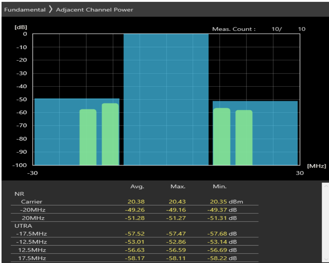
n20 SCS=30kHz CP_QPSK BW=20MHz Channel=168400 RB=51@0
