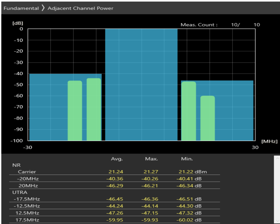
n8 SCS=30kHz DFT_QAM256 BW=20MHz Channel=181000 RB=1@50
