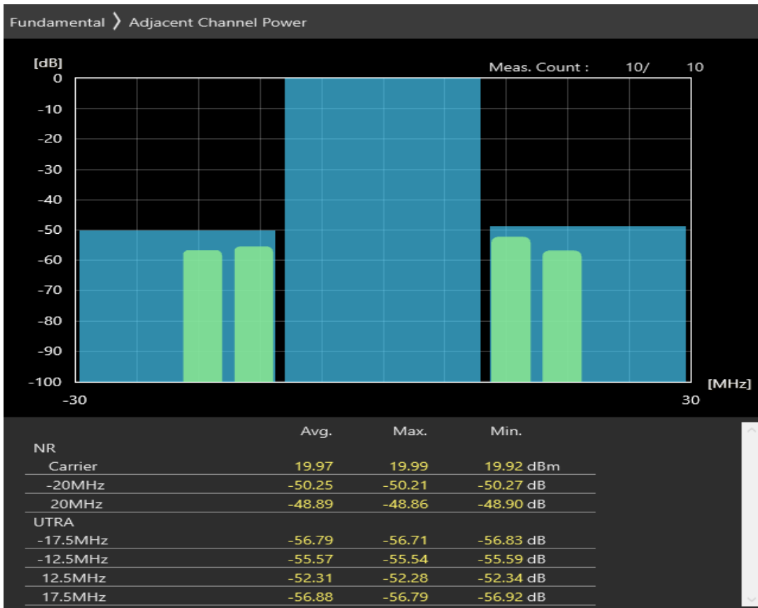
n20 SCS=30kHz CP_QAM256 BW=20MHz Channel=170400 RB=51@0
