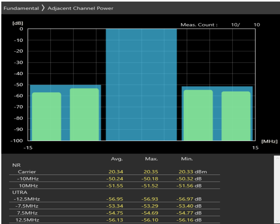
n8 SCS=30kHz CP_QAM256 BW=10MHz Channel=177000 RB=24@0
