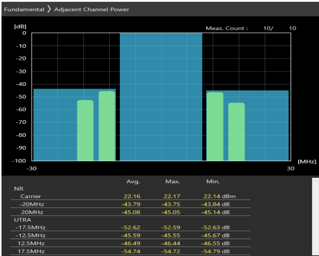
n20 SCS=30kHz CP_QPSK BW=20MHz Channel=170400 RB=1@50
