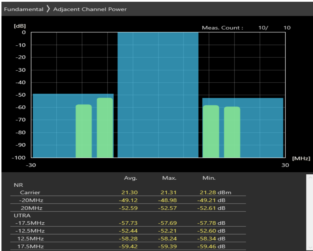
n8 SCS=30kHz DFT_QAM64 BW=20MHz Channel=178000 RB=50@0
