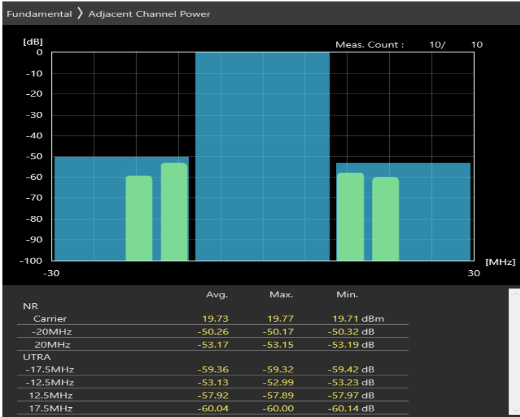
n20 SCS=30kHz DFT_QAM64 BW=20MHz Channel=168400 RB=50@0
