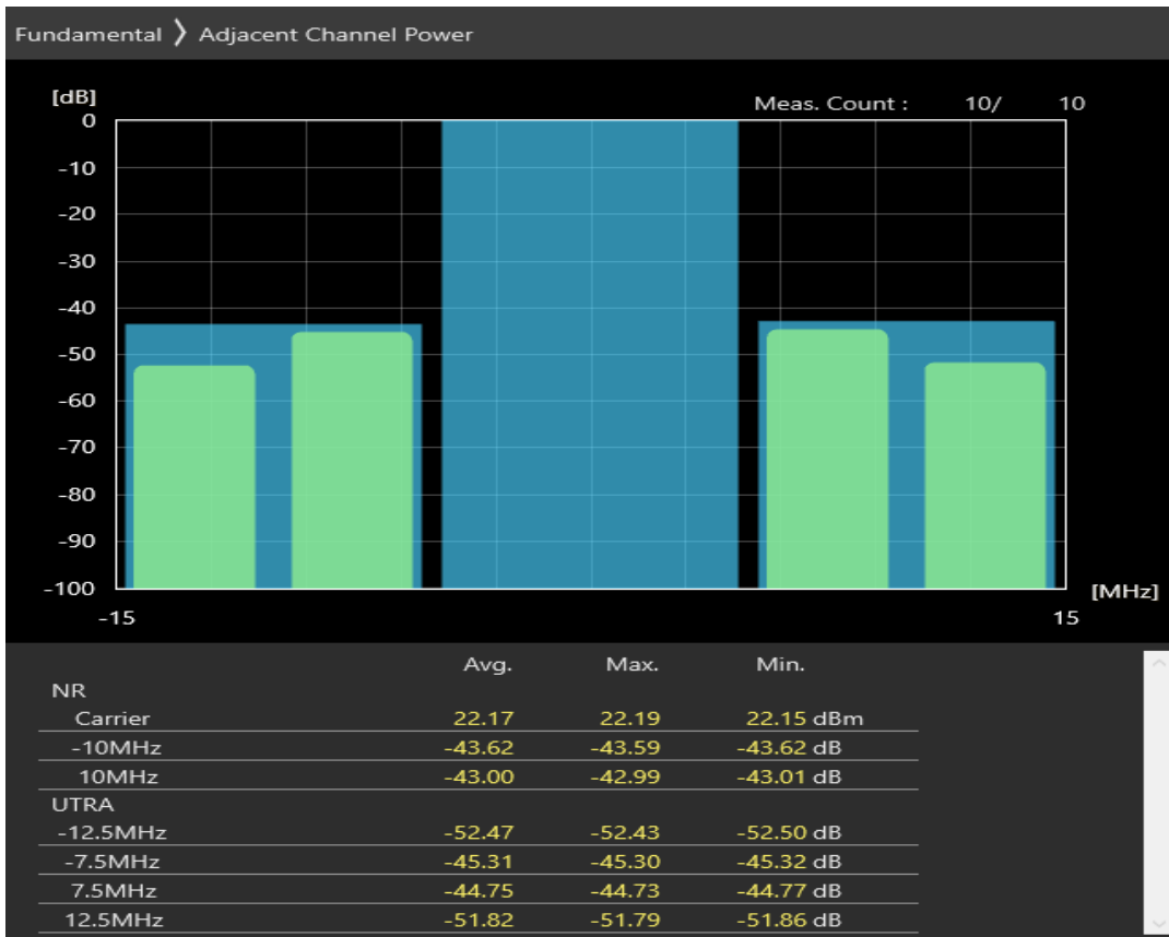
n38 SCS=30kHz DFT_QAM256 BW=10MHz Channel=515000 RB=1@0
