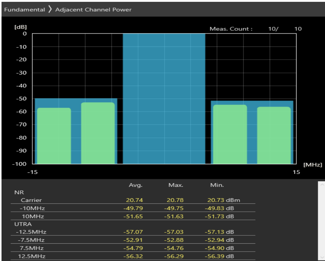
n8 SCS=30kHz CP_QAM16 BW=10MHz Channel=177000 RB=24@0
