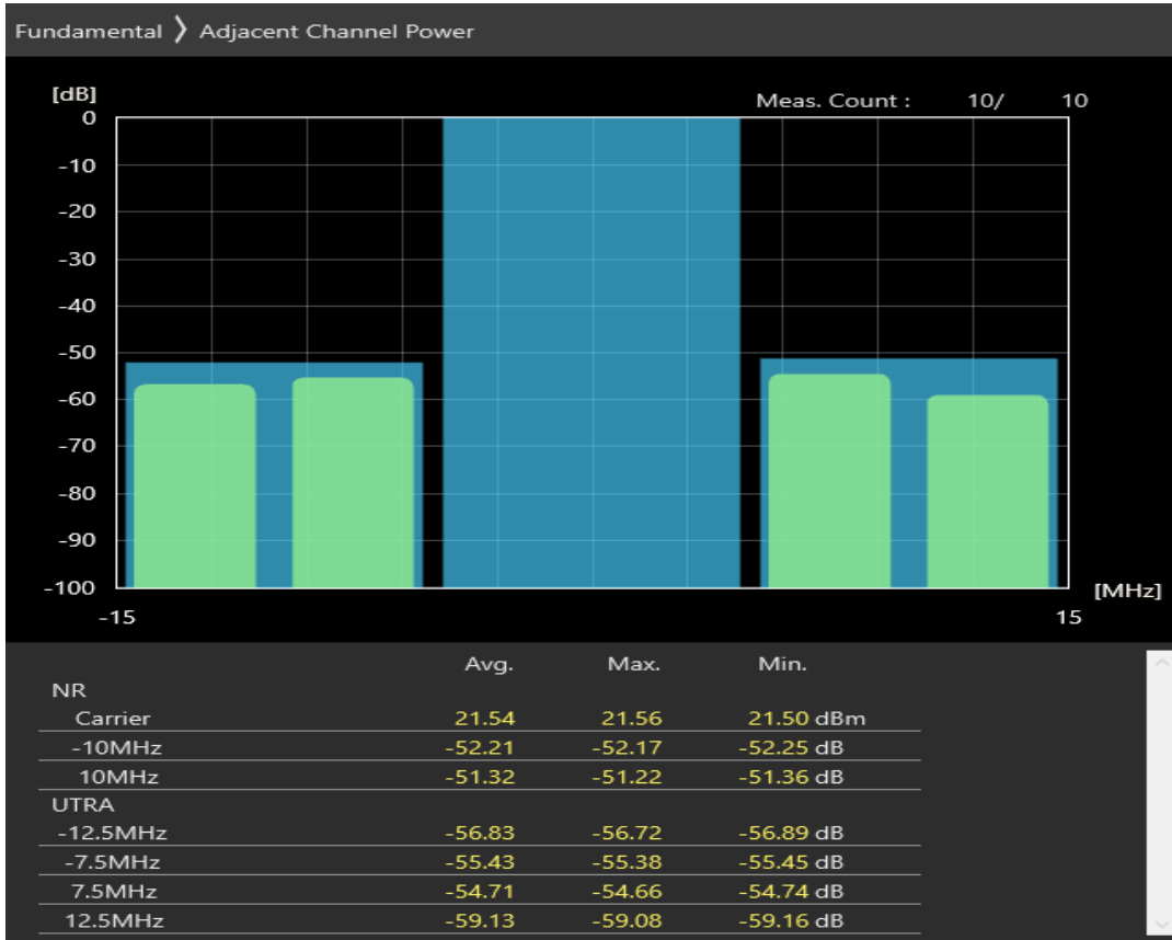
n8 SCS=30kHz DFT_QAM256 BW=10MHz Channel=182000 RB=24@0
