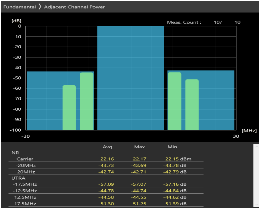
n28 SCS=30kHz CP_QPSK BW=20MHz Channel=142600 RB=1@0
