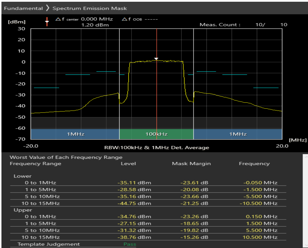
n28 SCS=30kHz DFT_QPSK BW=10MHz Channel=141600 RB=1@0
