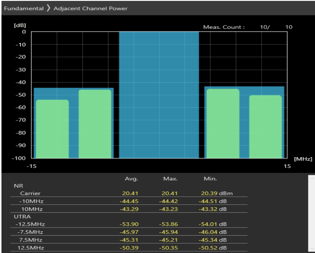
n20 SCS=30kHz CP_QPSK BW=10MHz Channel=167400 RB=1@0
