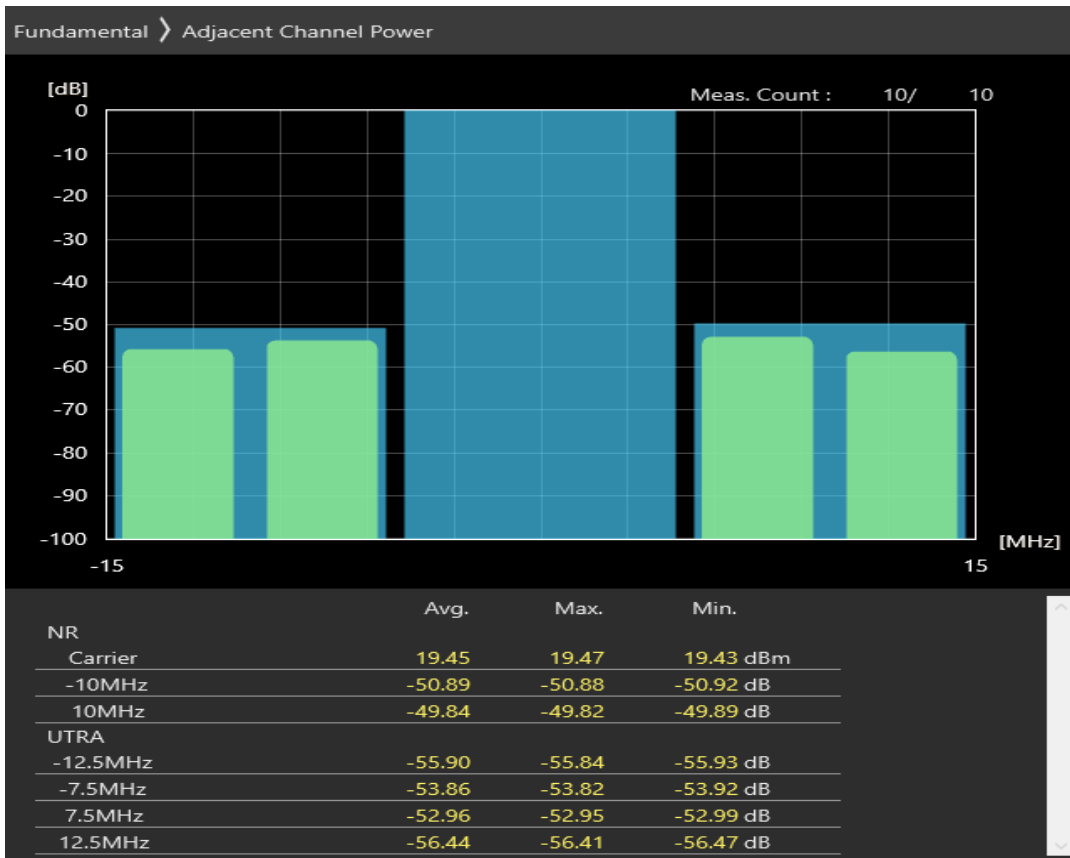
n1 SCS=30kHz DFT_BPSK BW=10MHz Channel=395000 RB=24@0
