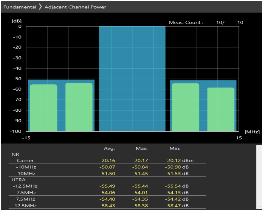
n8 SCS=30kHz CP_QAM64 BW=10MHz Channel=182000 RB=24@0
