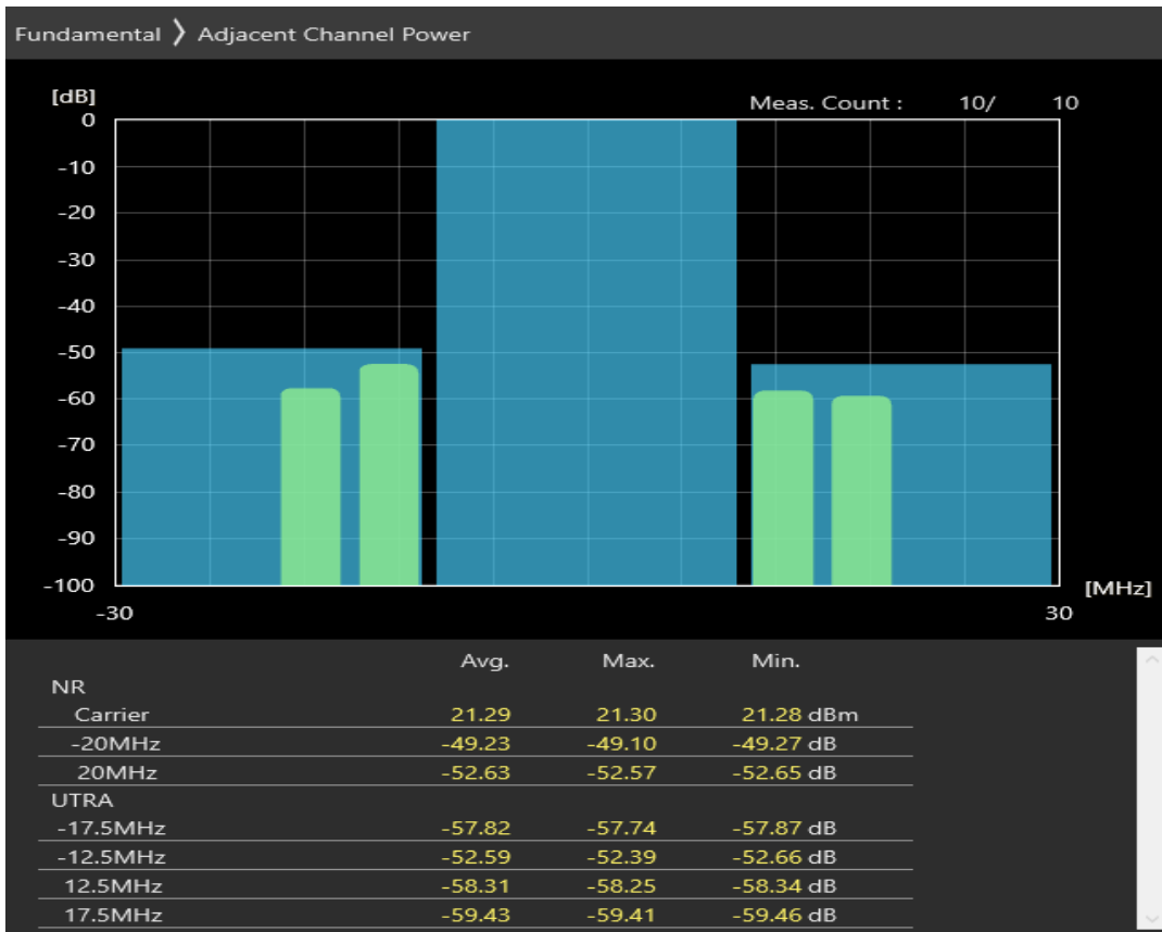
n8 SCS=30kHz CP_QAM16 BW=20MHz Channel=178000 RB=51@0
