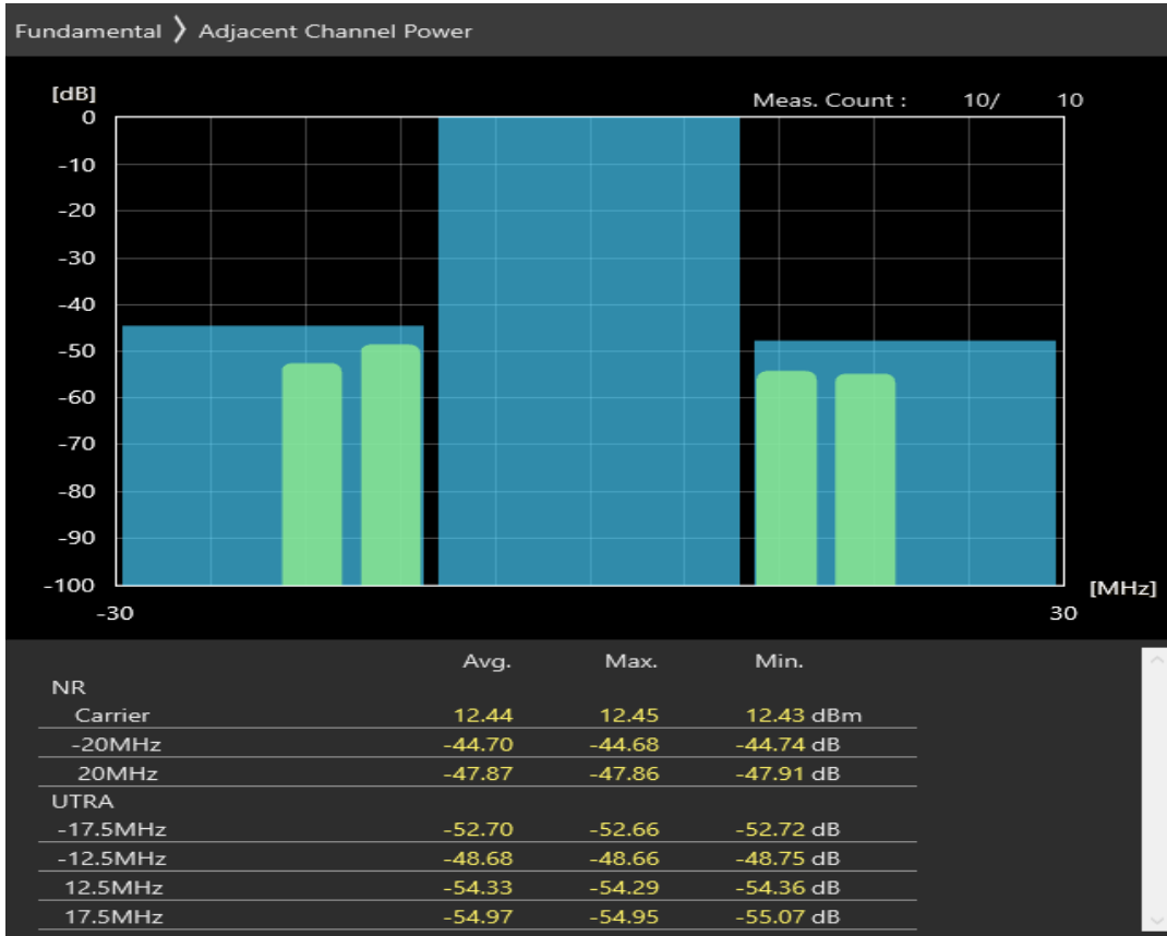
n28 SCS=30kHz CP_QPSK BW=20MHz Channel=147600 RB=25@12
