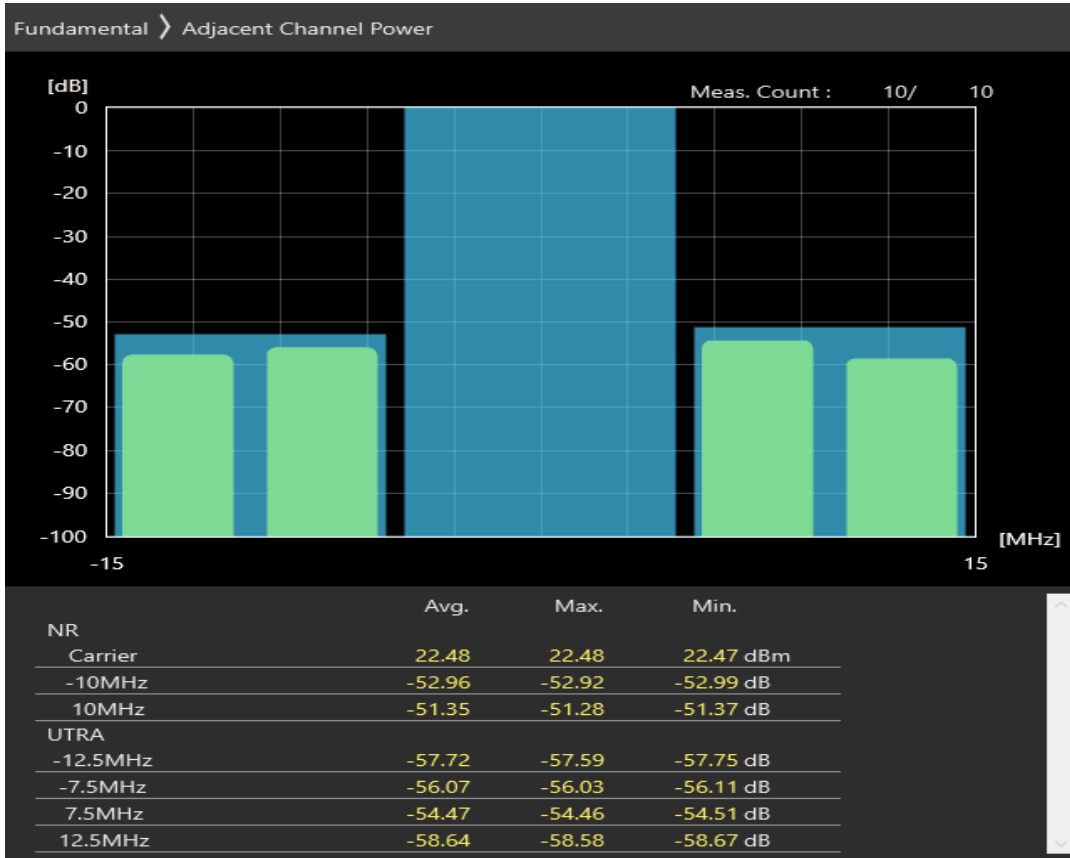
n20 SCS=30kHz DFT_QPSK BW=10MHz Channel=171400 RB=24@0
