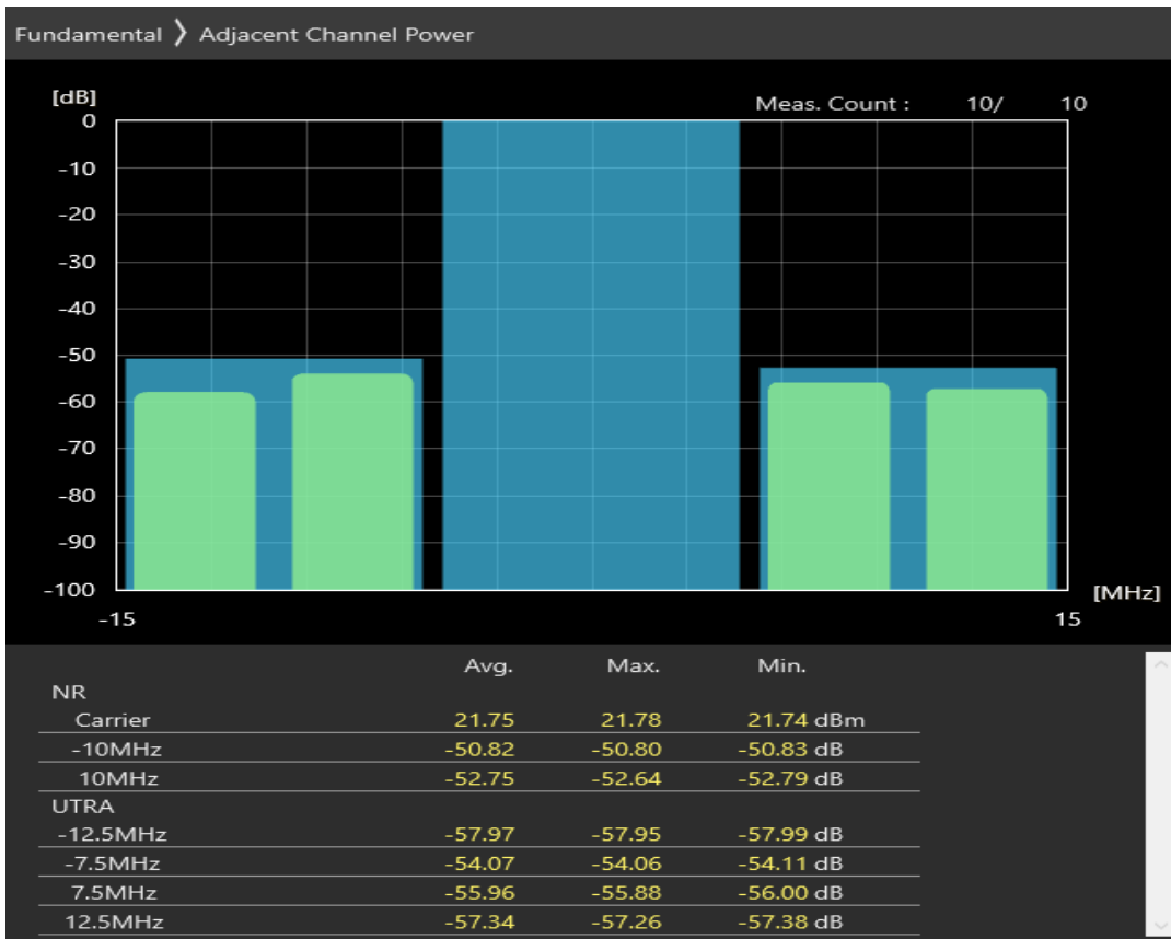
n8 SCS=30kHz DFT_QAM16 BW=10MHz Channel=177000 RB=24@0
