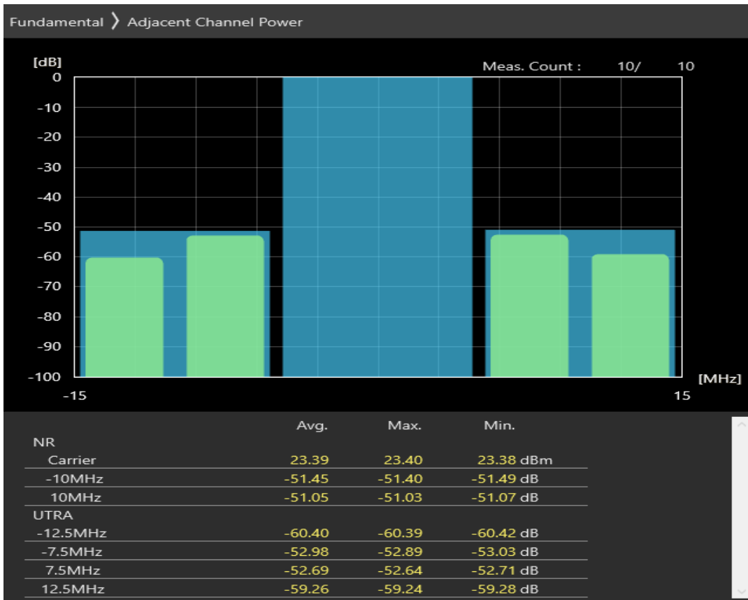
n20 SCS=30kHz DFT_BPSK BW=10MHz Channel=167400 RB=1@0
