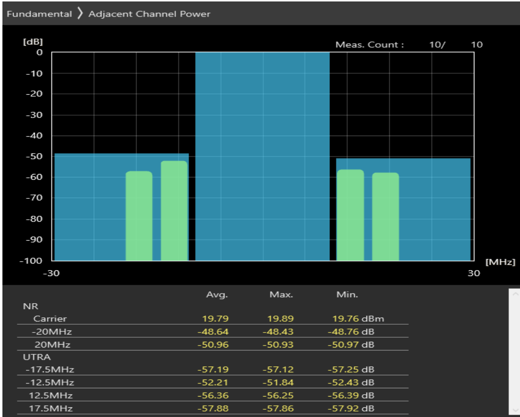
n20 SCS=30kHz CP_QAM256 BW=20MHz Channel=168400 RB=51@0
