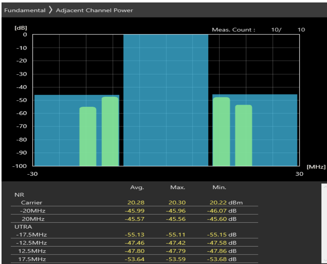
n8 SCS=30kHz DFT_BPSK BW=20MHz Channel=178000 RB=1@0
