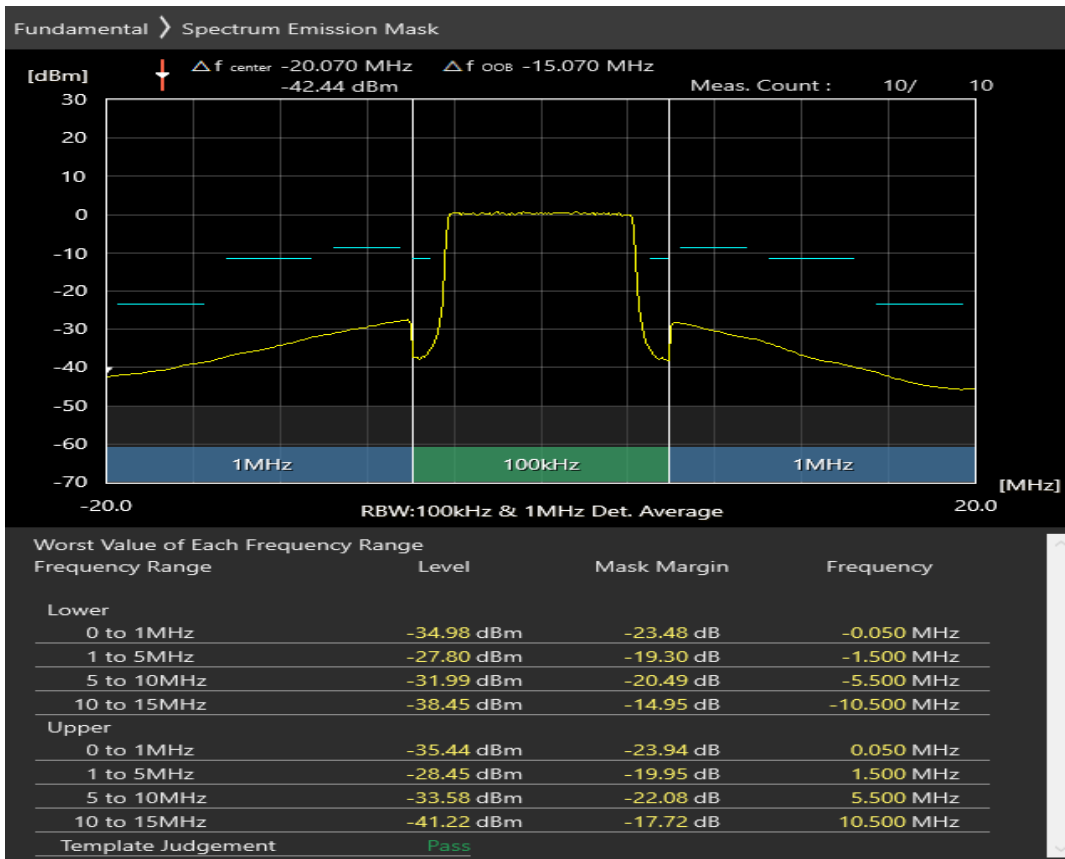
n3 SCS=30kHz DFT_QPSK BW=10MHz Channel=356000 RB=1@23
