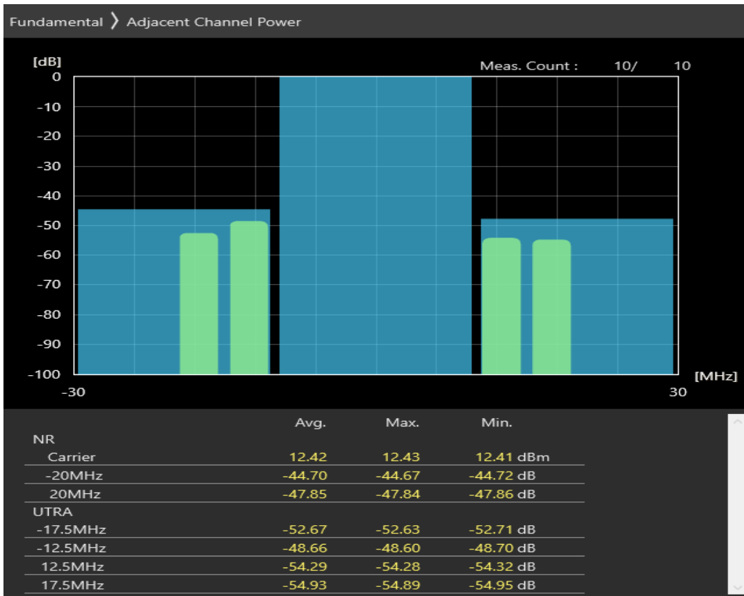
n28 SCS=30kHz CP_QPSK BW=20MHz Channel=147600 RB=1@50
