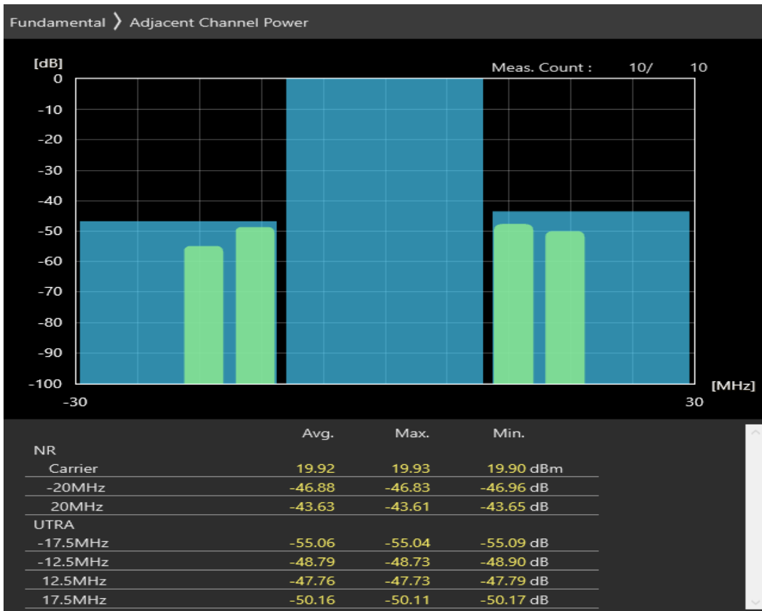
n20 SCS=30kHz DFT_QPSK BW=20MHz Channel=168400 RB=25@12
