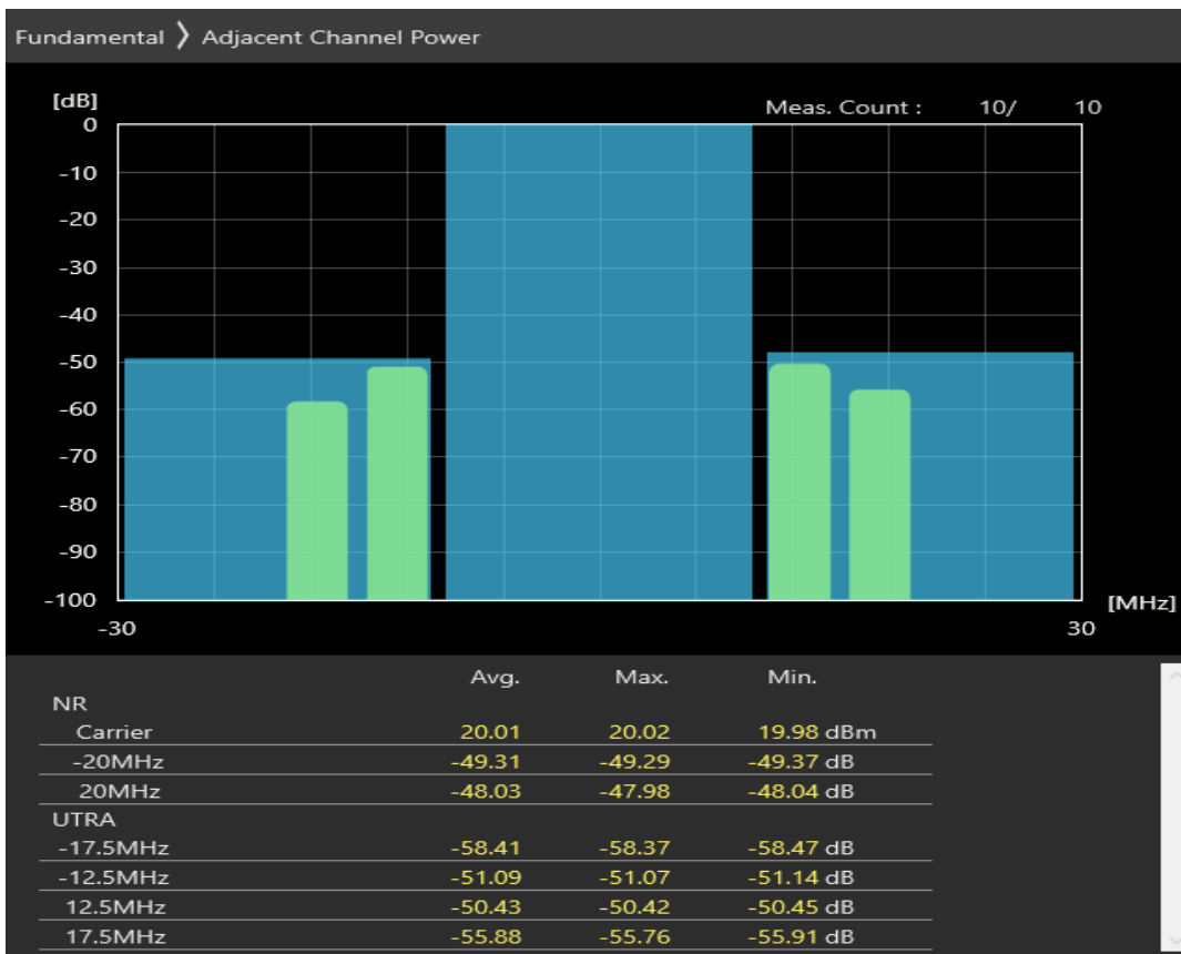
n20 SCS=30kHz DFT_BPSK BW=20MHz Channel=168400 RB=1@0
