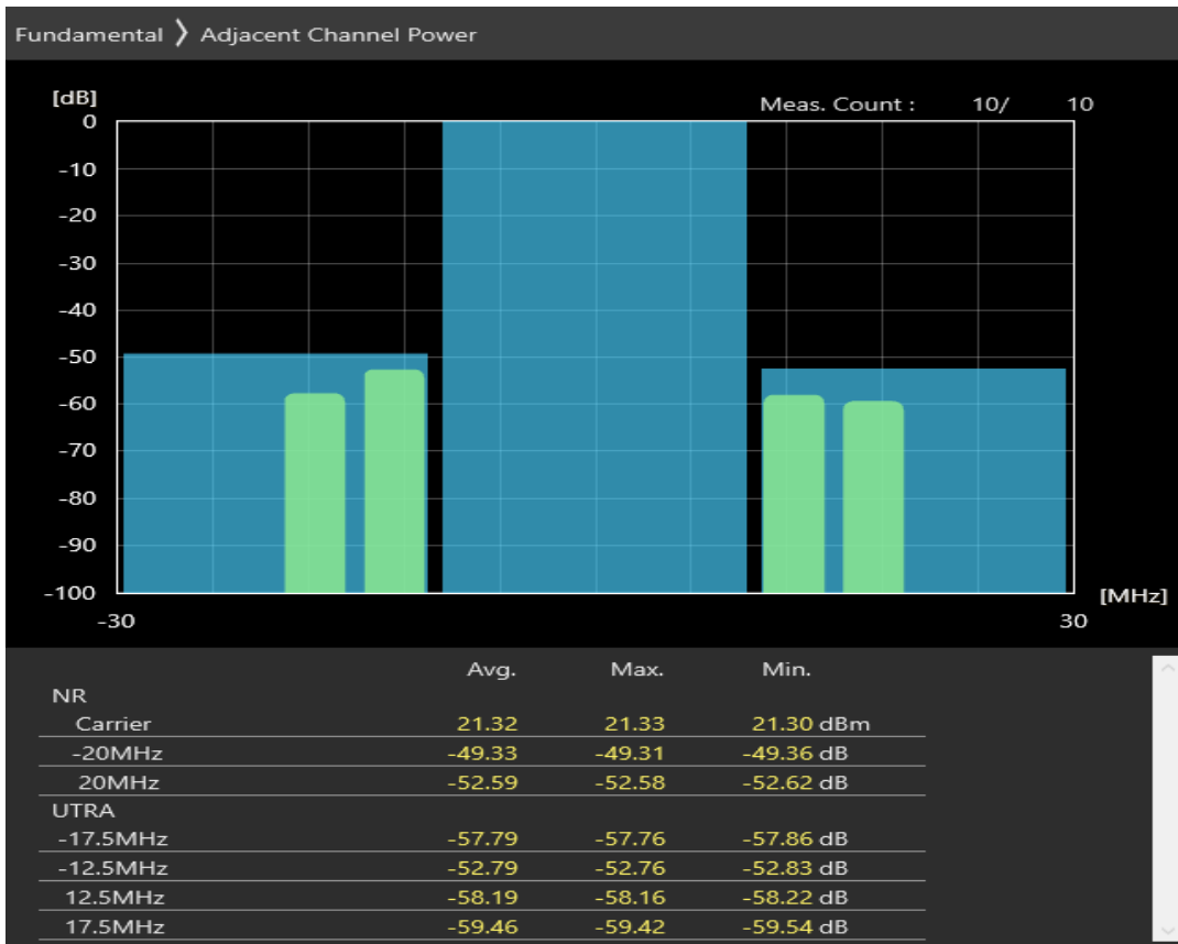
n8 SCS=30kHz CP_QAM256 BW=20MHz Channel=178000 RB=51@0
