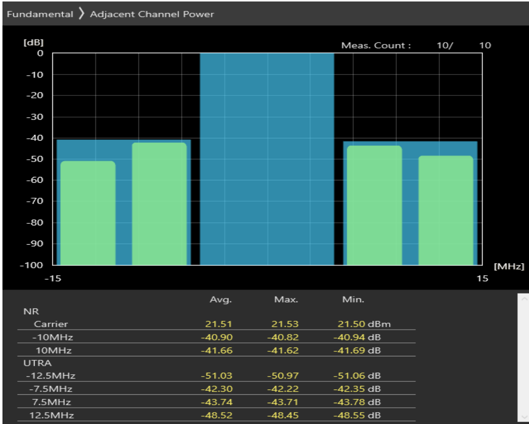
n8 SCS=30kHz CP_QPSK BW=10MHz Channel=177000 RB=12@6
