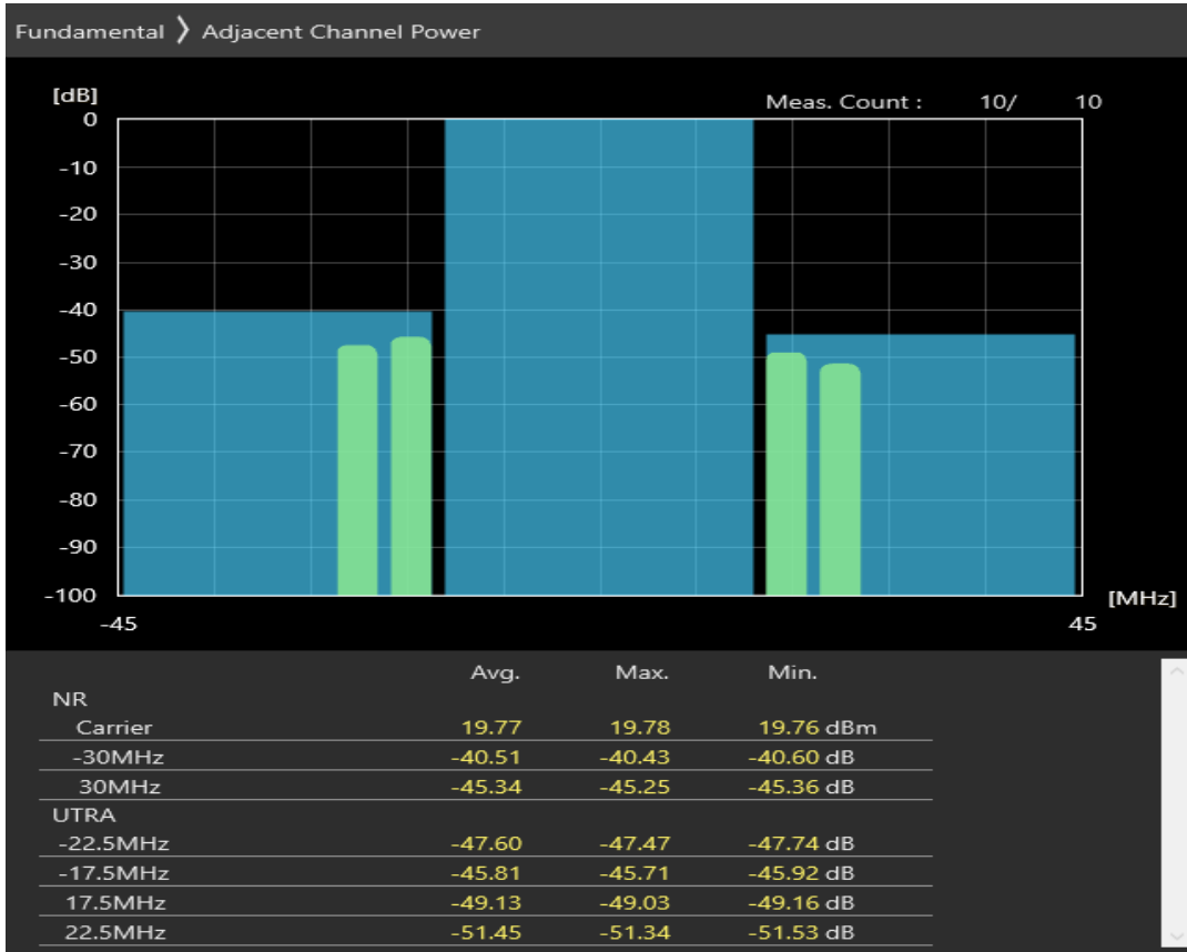
n3 SCS=30kHz CP_QPSK BW=30MHz Channel=354000 RB=39@19
