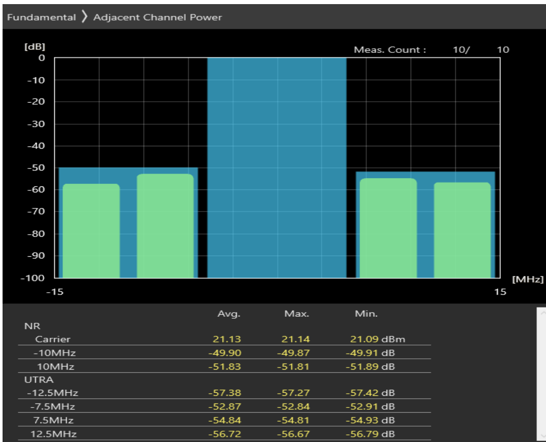
n38 SCS=30kHz CP_QAM256 BW=10MHz Channel=515000 RB=24@0
