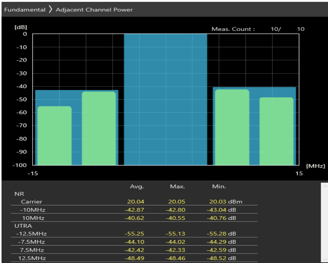
n28 SCS=30kHz CP_QAM256 BW=10MHz Channel=141600 RB=1@0
