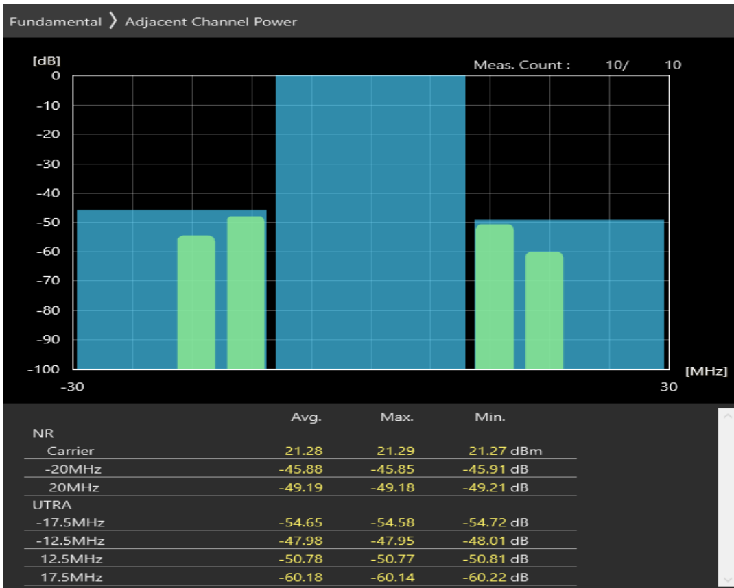
n8 SCS=30kHz DFT_BPSK BW=20MHz Channel=181000 RB=1@50
