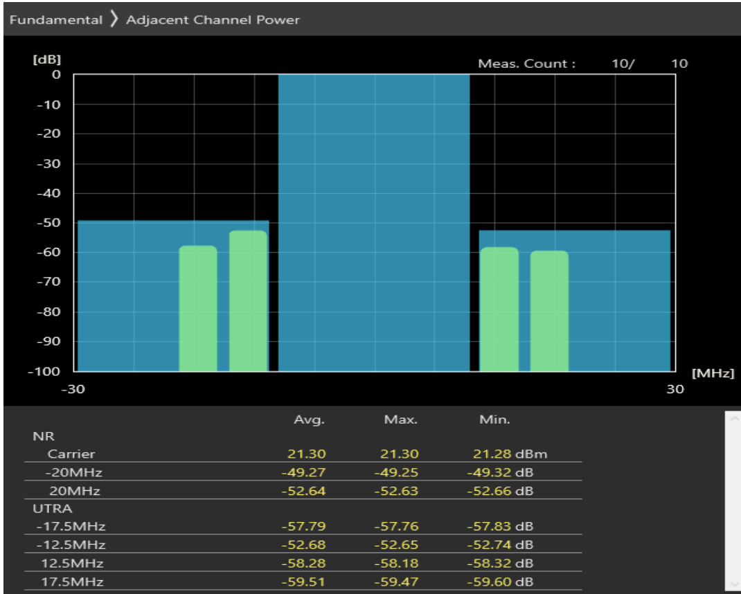
n8 SCS=30kHz CP_QPSK BW=20MHz Channel=178000 RB=51 @0
