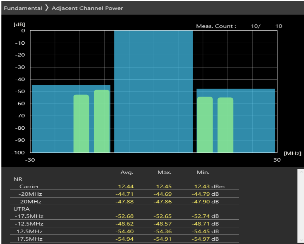
n28 SCS=30kHz CP_QPSK BW=20MHz Channel=147600 RB=51@0
