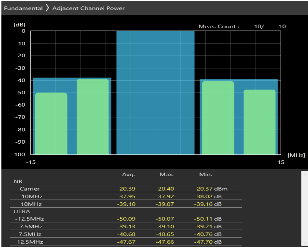
n8 SCS=30kHz CP_QAM256 BW=10MHz Channel=177000 RB=1@0
