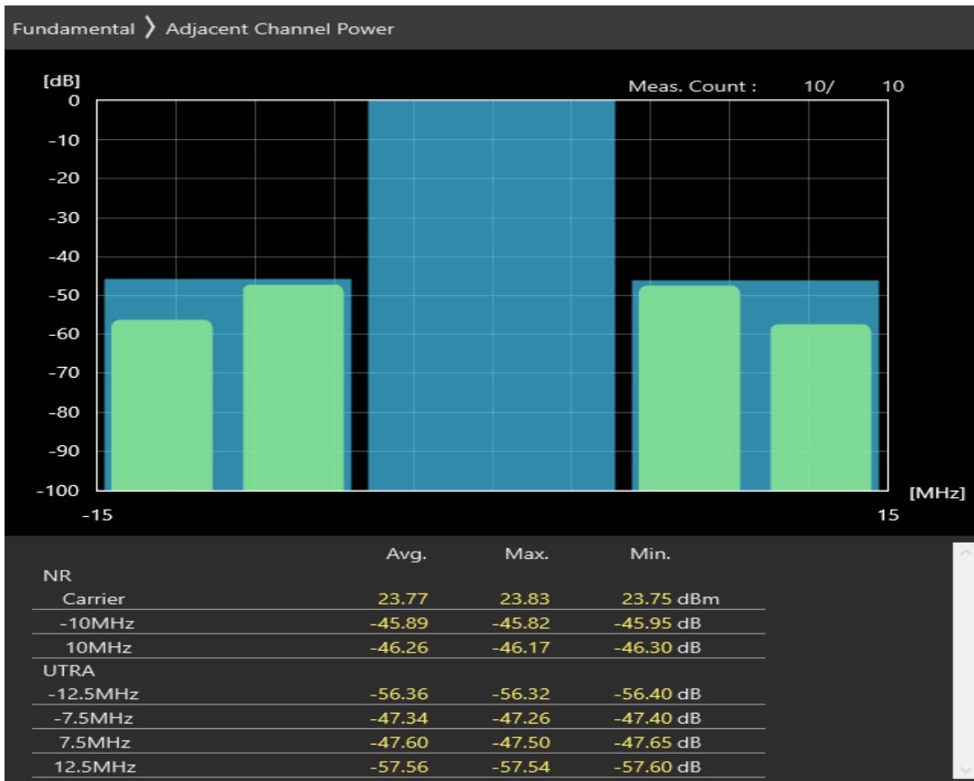
n20 SCS=30kHz DFT_QPSK BW=10MHz Channel=171400 RB=1@23
