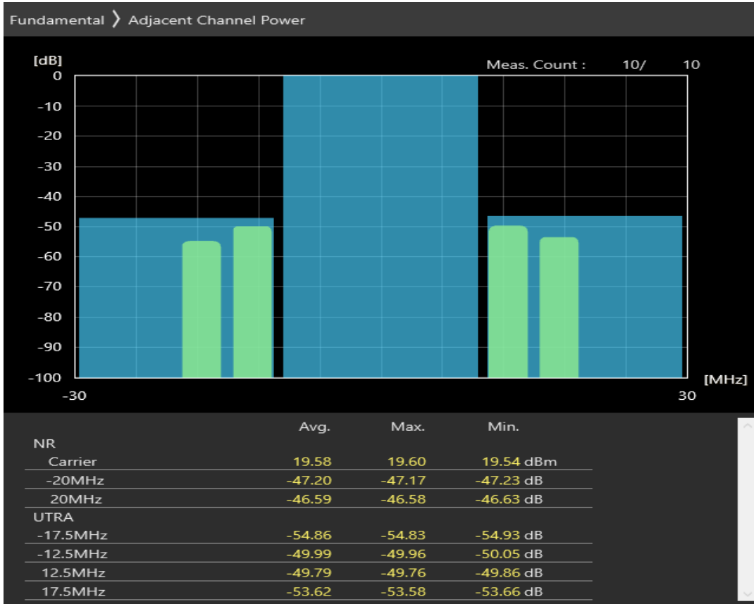
n1 SCS=30kHz DFT_QAM16 BW=20MHz Channel=386000 RB=50@0
