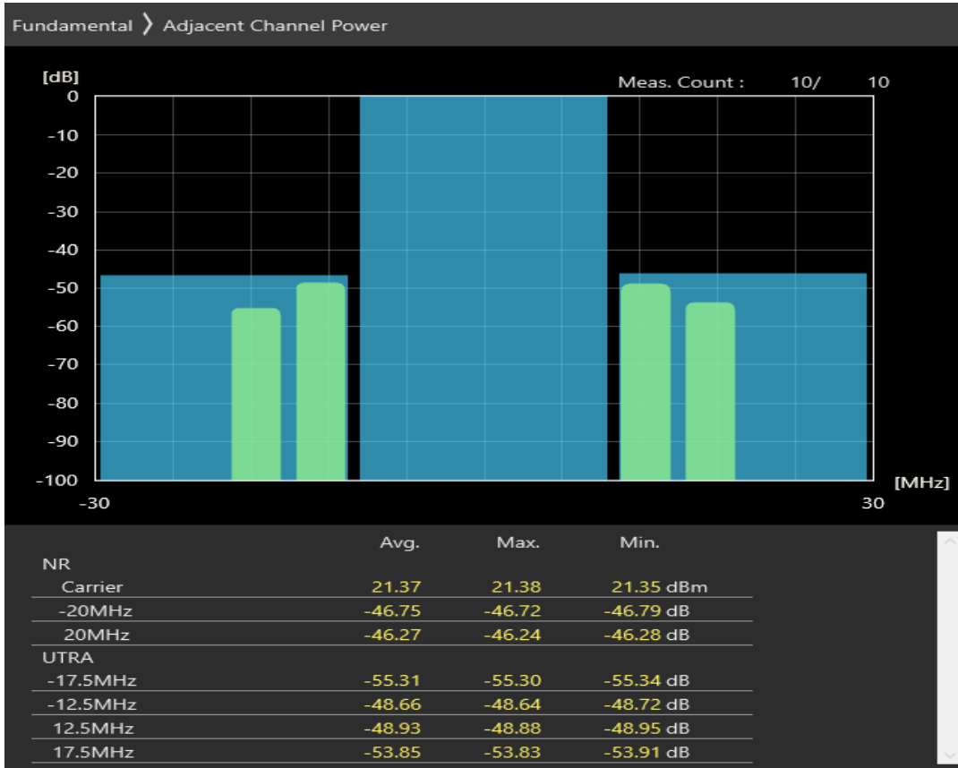
n8 SCS=30kHz CP_QAM16 BW=20MHz Channel=178000 RB=1@0
