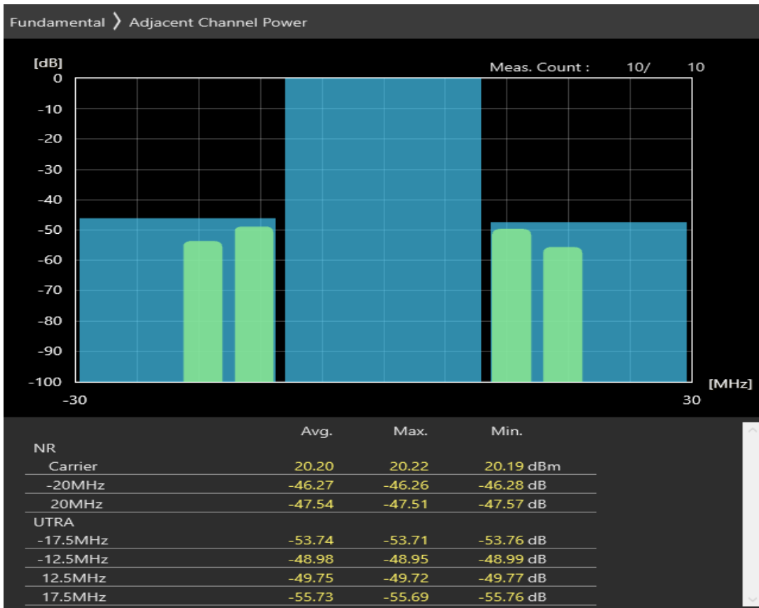
n20 SCS=30kHz DFT_QPSK BW=20MHz Channel=170400 RB=1@50
