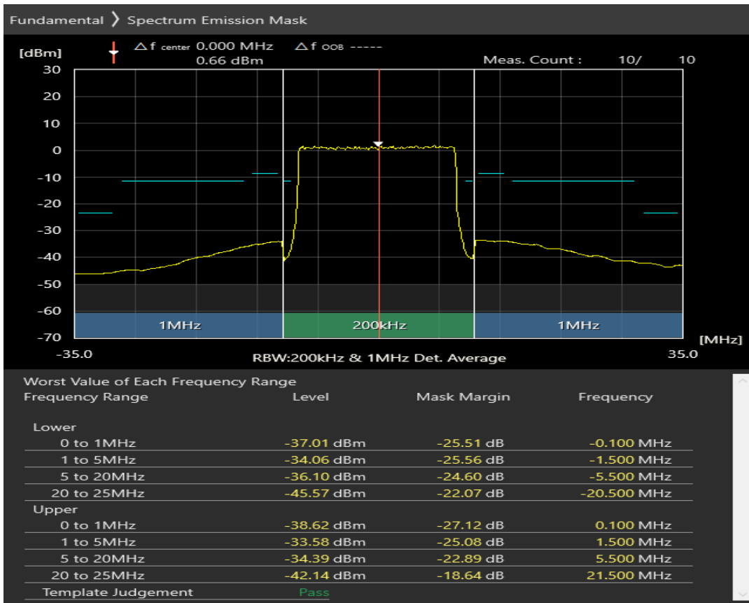
n1 SCS=30kHz CP_QPSK BW=20MHz Channel=386000 RB=1@0
