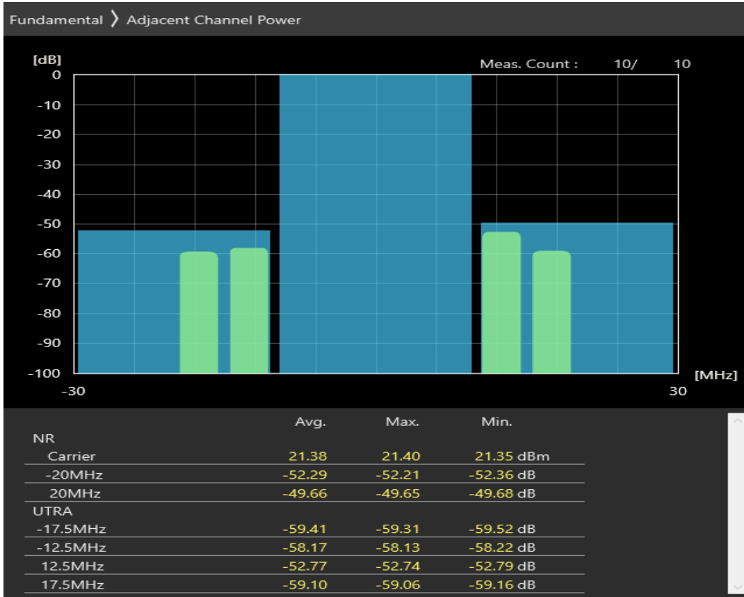
n8 SCS=30kHz DFT_BPSK BW=20MHz Channel=181000 RB=50@0
