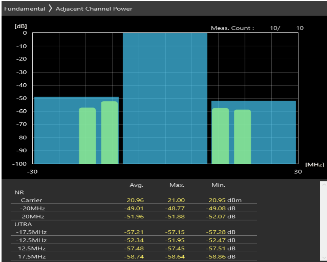
n38 SCS=30kHz DFT_QAM256 BW=20MHz Channel=516000 RB=50@0
