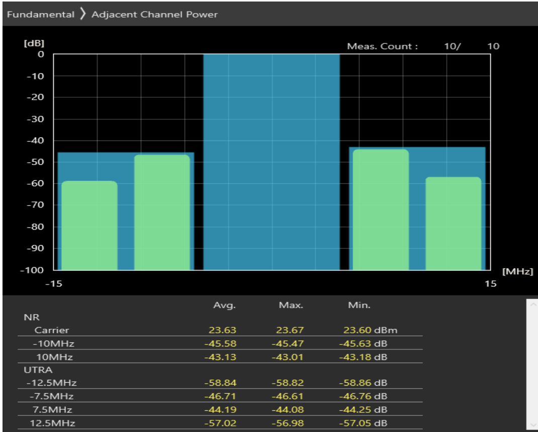
n28 SCS=30kHz DFT_QPSK BW=10MHz Channel=141600 RB=1@0
