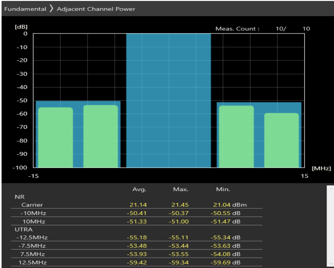
n28 SCS=30kHz CP_QPSK BW=10MHz Channel=148600 RB=24@0
