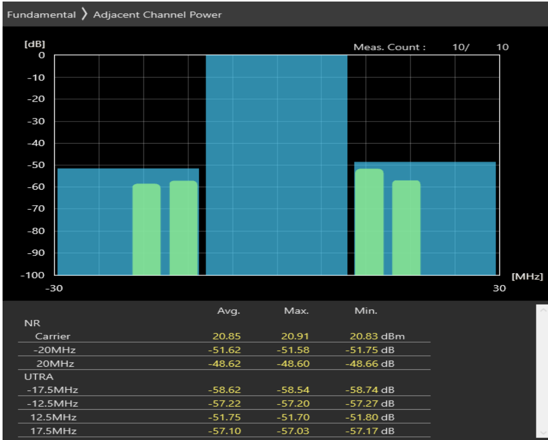
n38 SCS=30kHz DFT_QPSK BW=20MHz Channel=522000 RB=50@0
