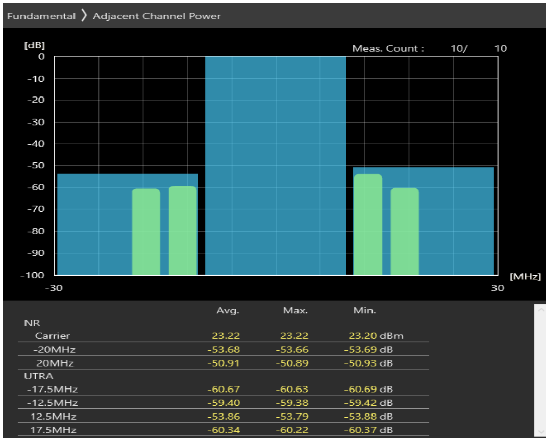
n28 SCS=30kHz DFT_BPSK BW=20MHz Channel=147600 RB=50@0
