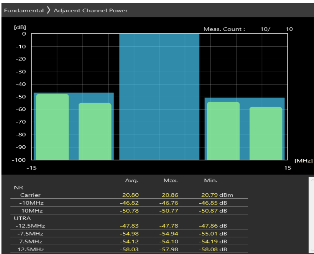
n3 SCS=30kHz DFT_QAM256 BW=10MHz Channel=356000 RB=24@0
