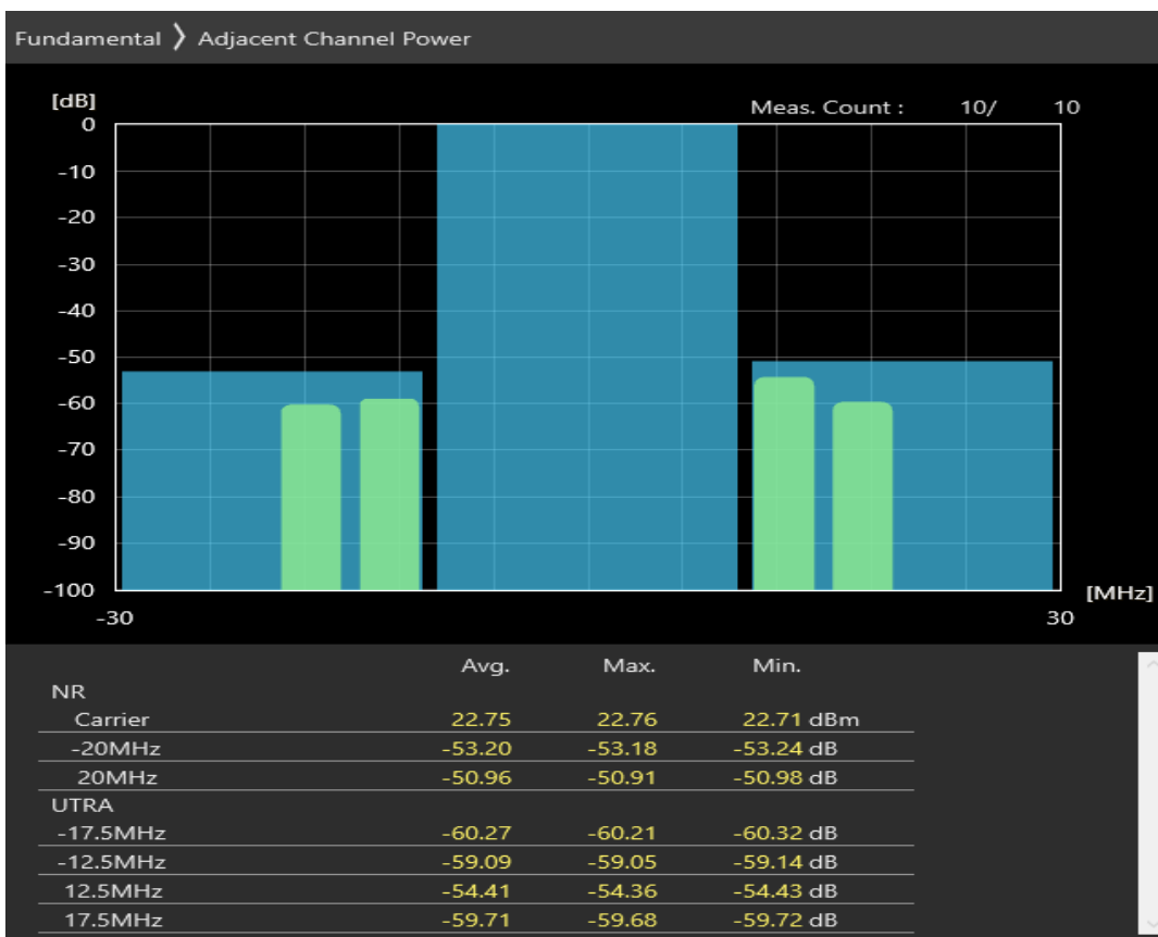
n8 SCS=30kHz DFT_QPSK BW=20MHz Channel=181000 RB=50@0
