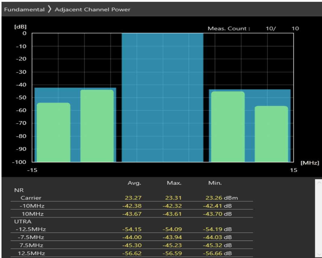
n3 SCS=30kHz DFT_QPSK BW=10MHz Channel=356000 RB=1@23
