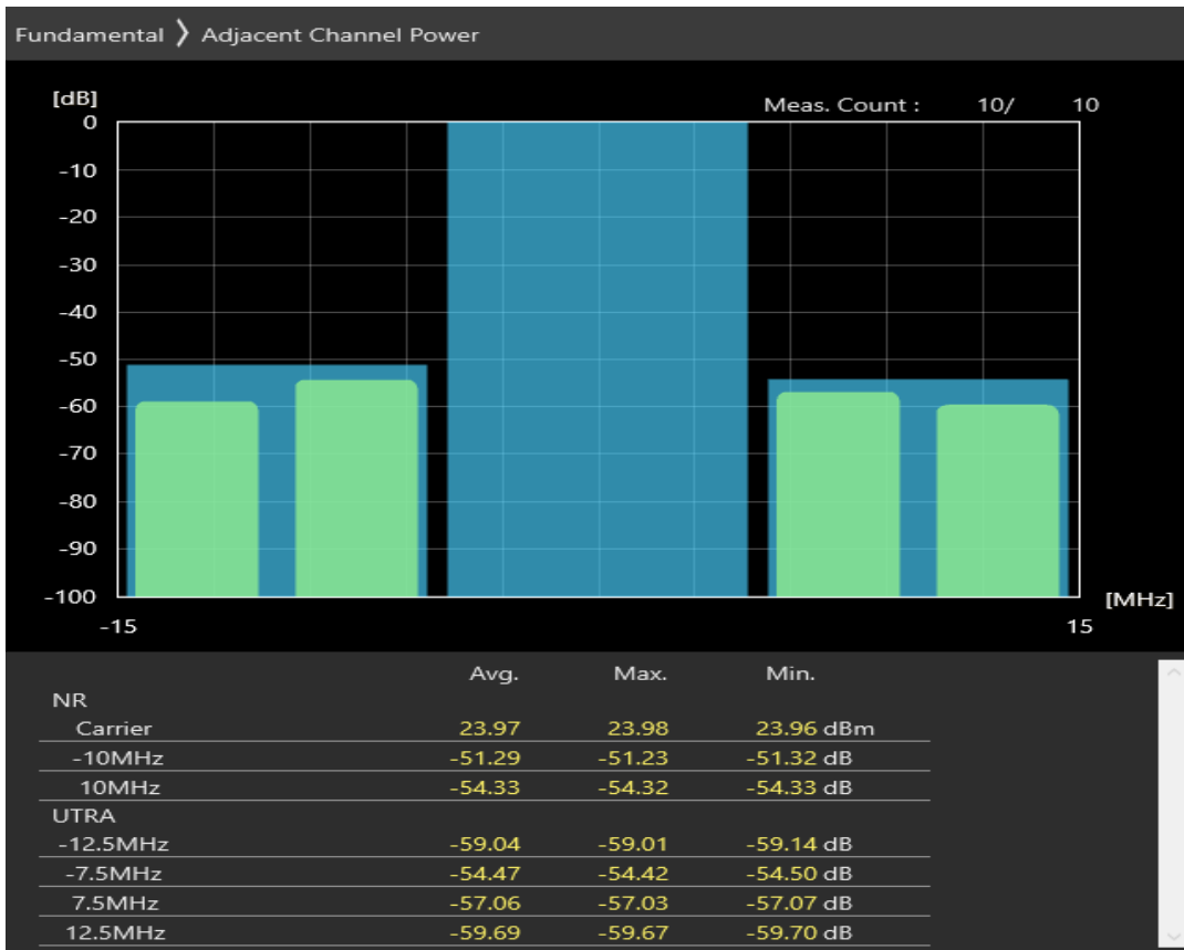
n38 SCS=30kHz DFT_BPSK BW=10MHz Channel=515000 RB=24@0
