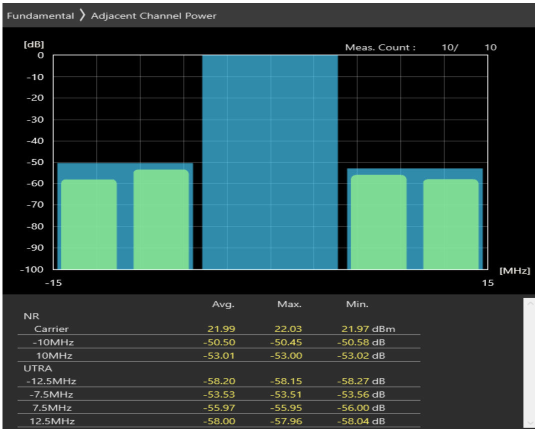
n38 SCS=30kHz CP_QPSK BW=10MHz Channel=515000 RB=24@0
