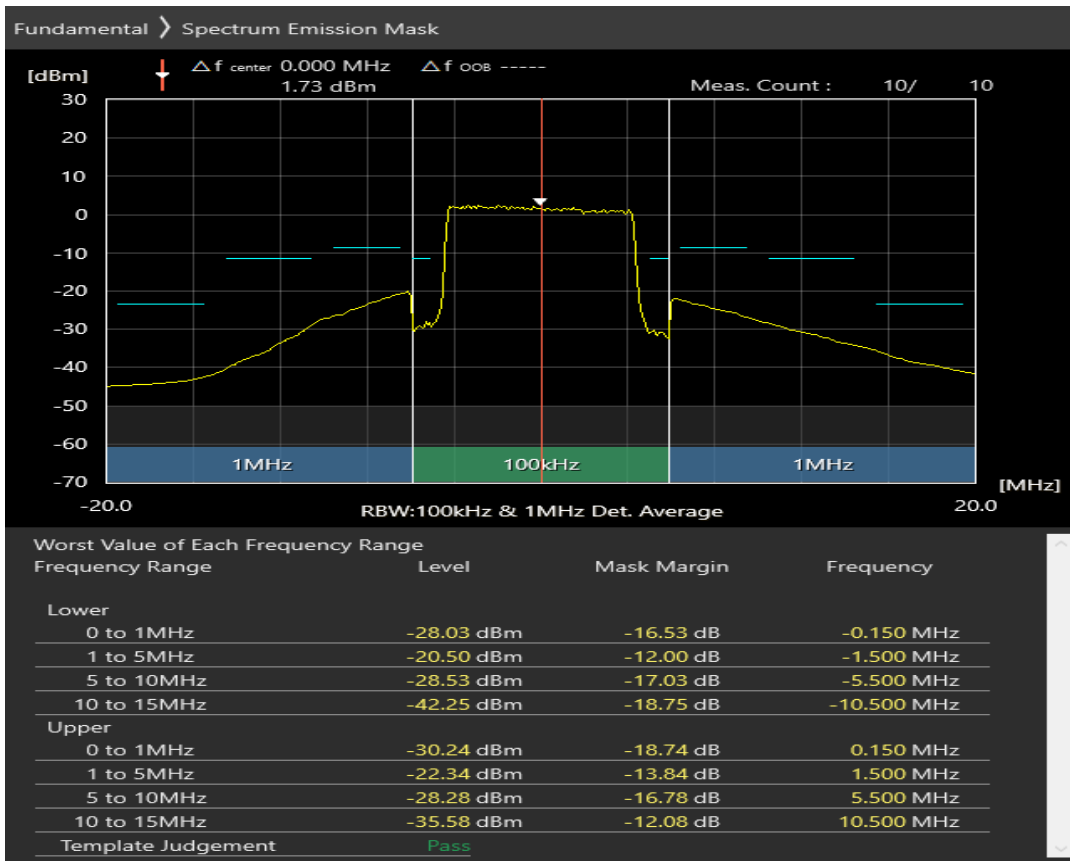
n8 SCS=30kHz CP_QAM64 BW=10MHz Channel=177000 RB=1@0
