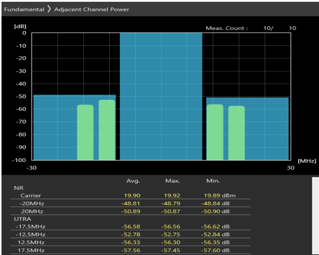
n1 SCS=30kHz CP_QPSK BW=20MHz Channel=386000 RB=25@12
