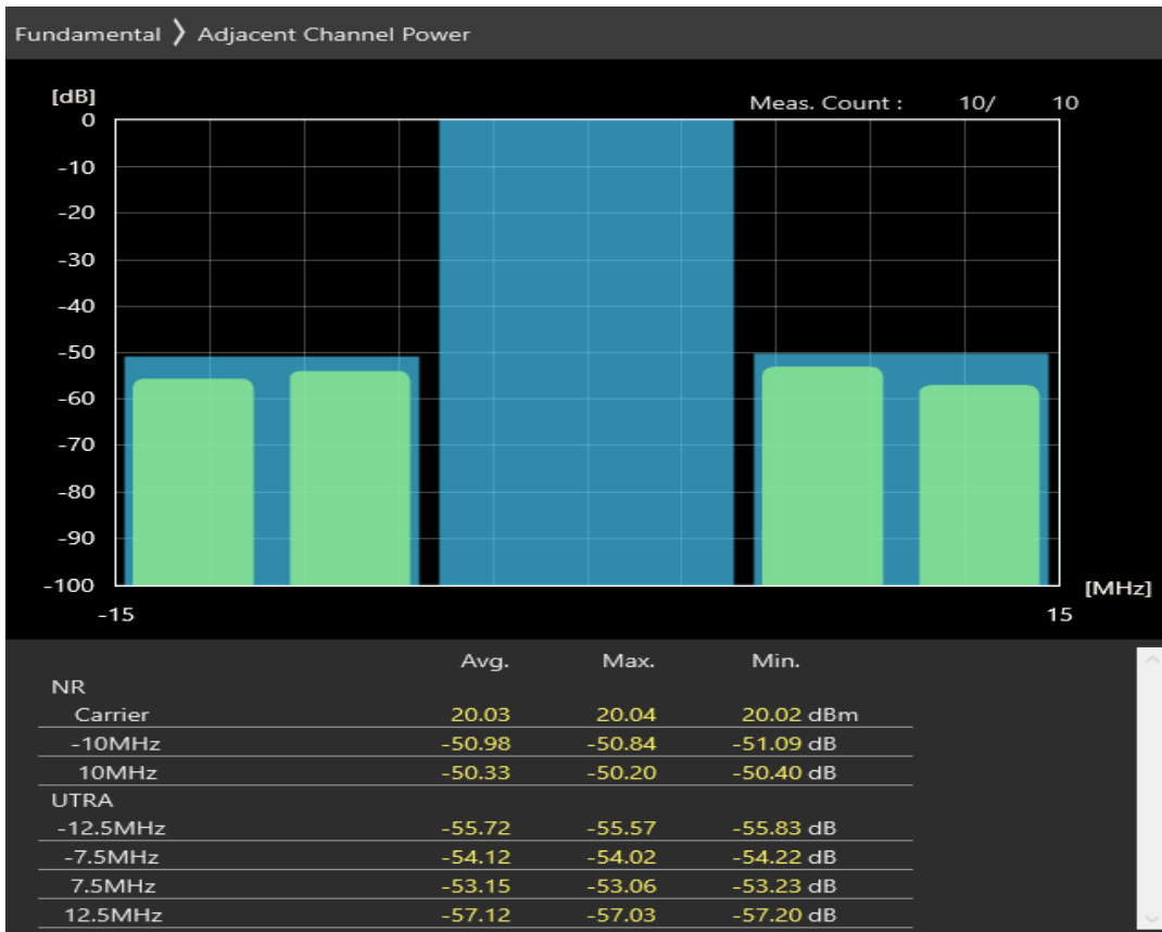
n20 SCS=30kHz CP_QAM256 BW=10MHz Channel=171400 RB=24@0
