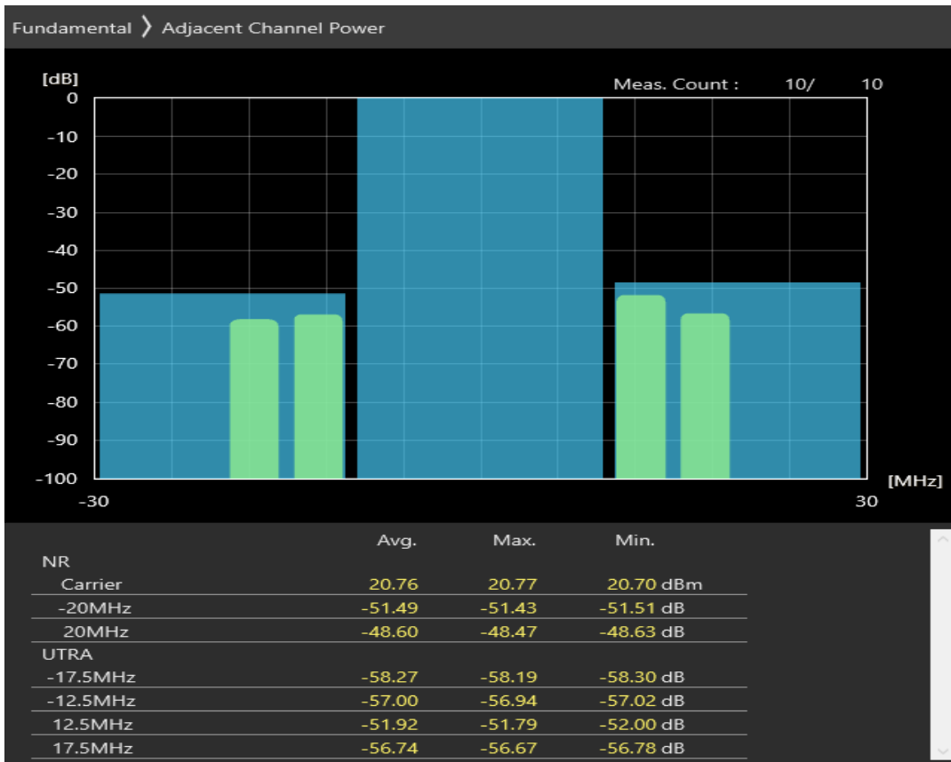
n38 SCS=30kHz DFT_QAM16 BW=20MHz Channel=522000 RB=50@0
