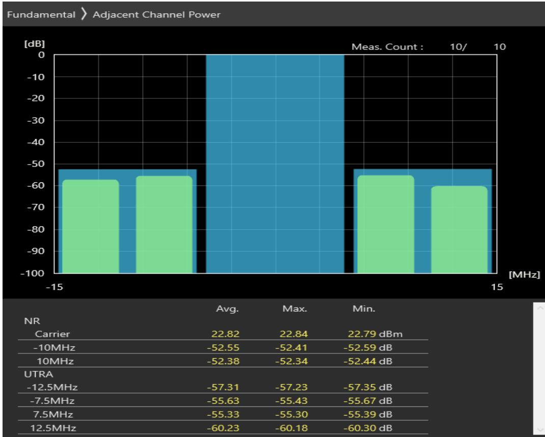
n28 SCS=30kHz DFT_QPSK BW=10MHz Channel=148600 RB=24@0
