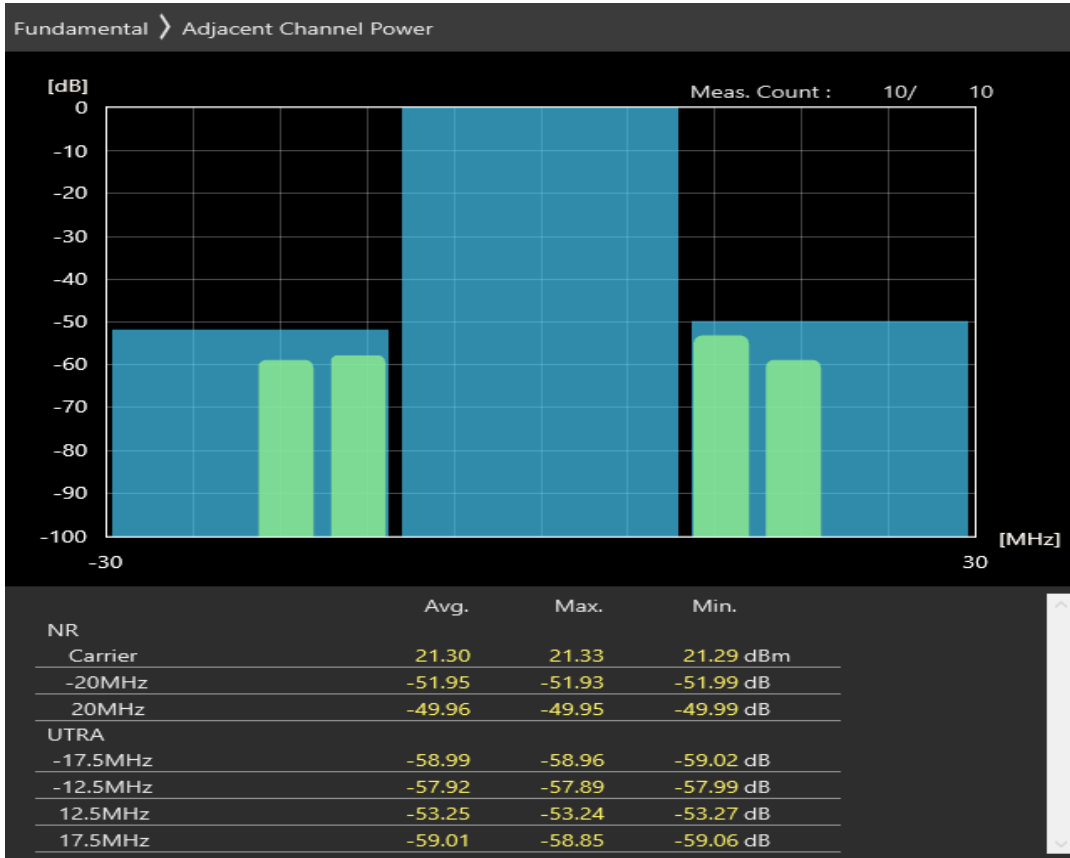
n8 SCS=30kHz DFT_QAM256 BW=20MHz Channel=181000 RB=50@0
