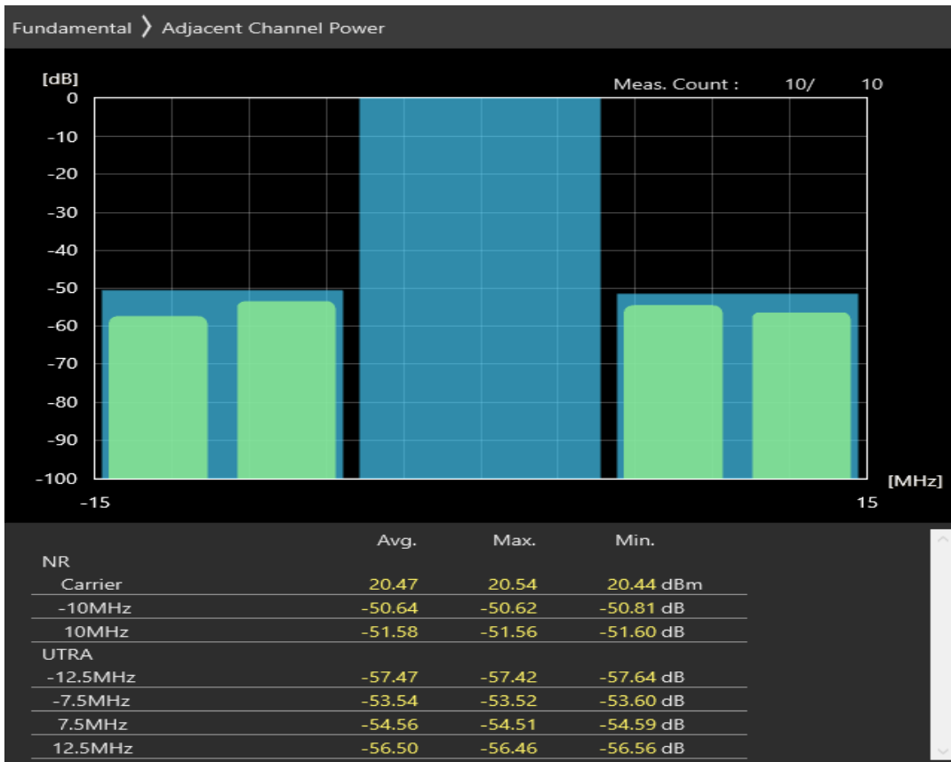
n20 SCS=30kHz CP_QPSK BW=10MHz Channel=167400 RB=24@0
