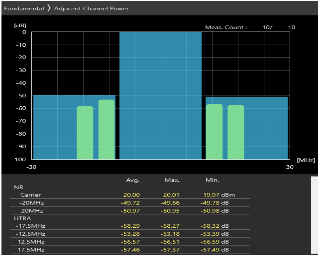
n28 SCS=30kHz DFT_QAM16 BW=20MHz Channel=142600 RB=50@0
