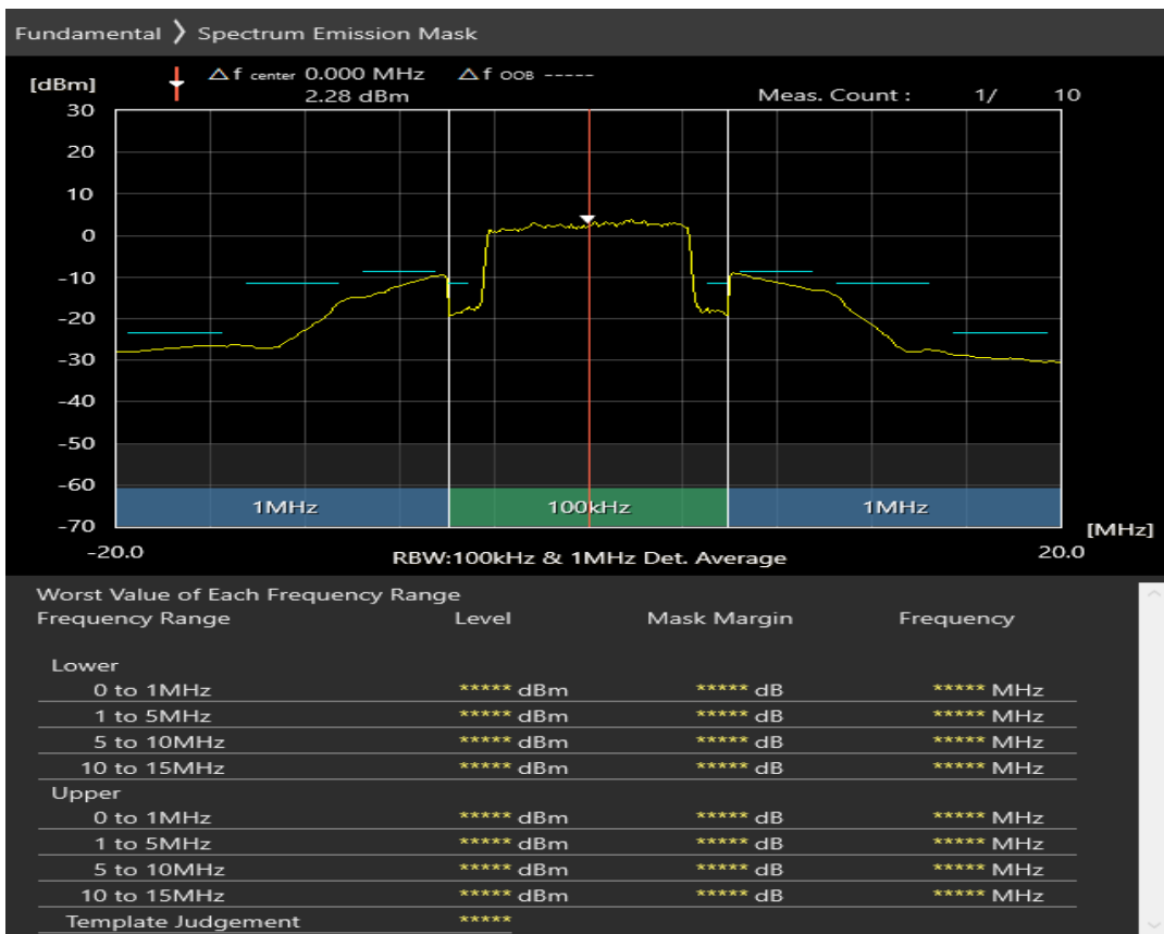
n3 SCS=30kHz DFT_BPSK BW=10MHz Channel=343000 RB=24@0
