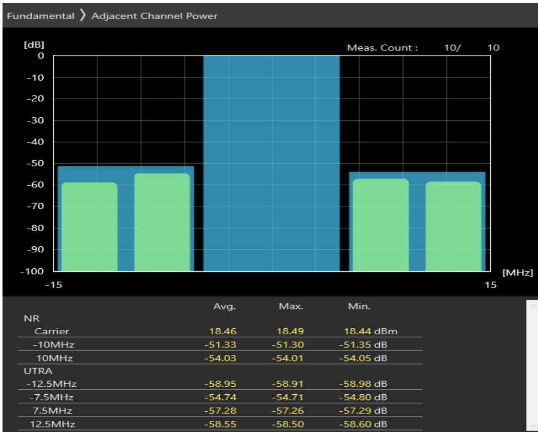
n8 SCS=30kHz DFT_BPSK BW=10MHz Channel=177000 RB=24@0
