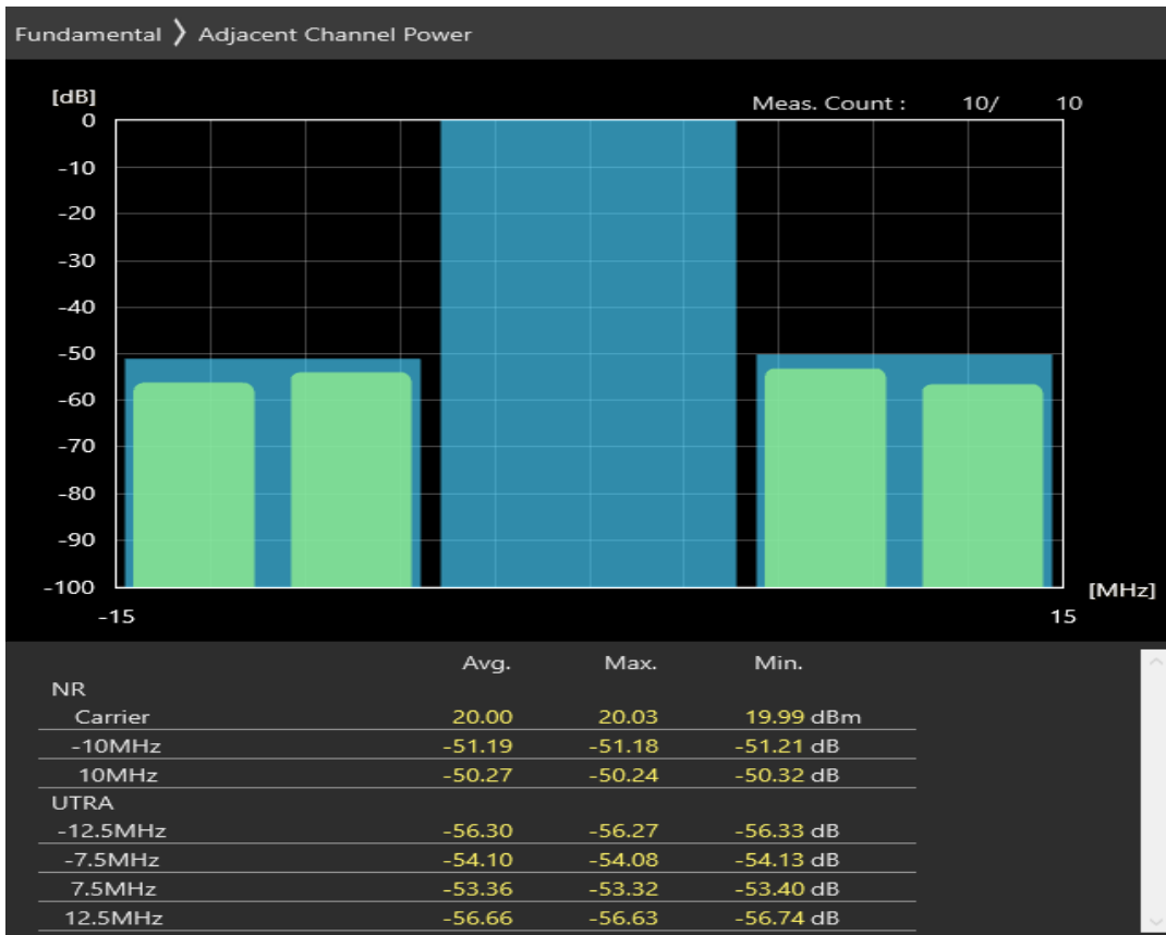
n1 SCS=30kHz CP_QPSK BW=10MHz Channel=395000 RB=24@0
