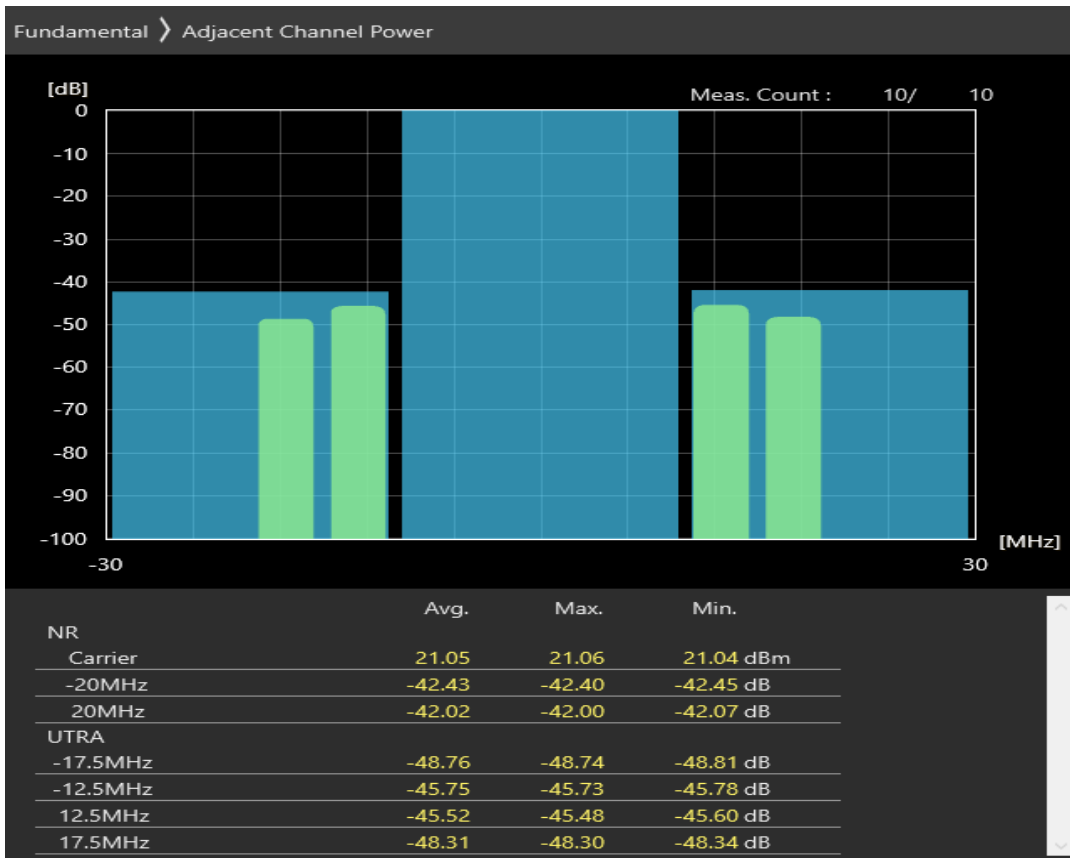
n38 SCS=30kHz DFT_QPSK BW=20MHz Channel=516000 RB=25@12
