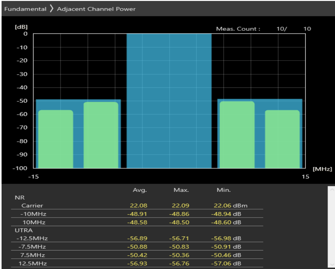
n38 SCS=30kHz CP_QPSK BW=10MHz Channel=515000 RB=1@0
