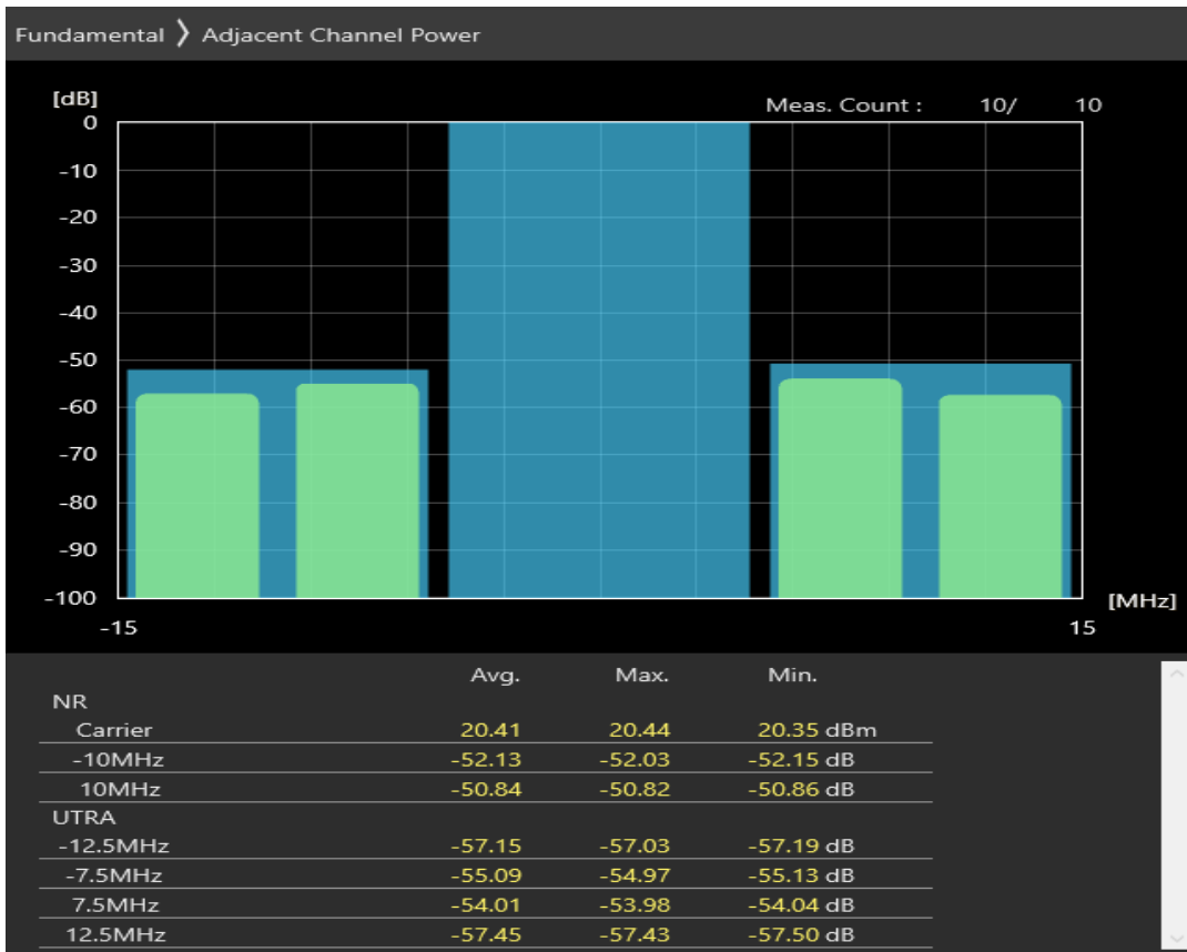
n1 SCS=30kHz DFT_QAM256 BW=10MHz Channel=395000 RB=24@0
