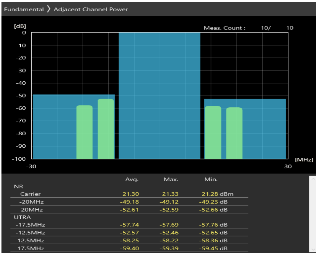
n8 SCS=30kHz DFT_QAM256 BW=20MHz Channel=178000 RB=50@0
