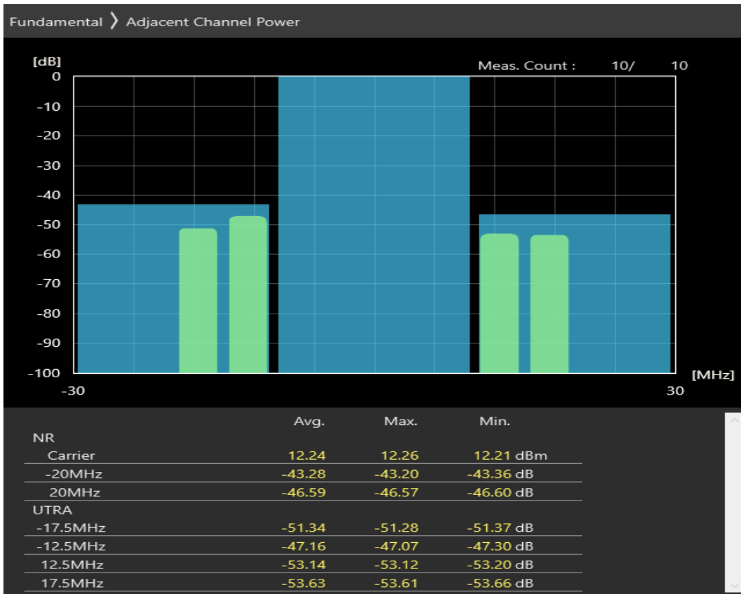
n8 SCS=30kHz CP_QAM256 BW=20MHz Channel=181000 RB=1 @50
