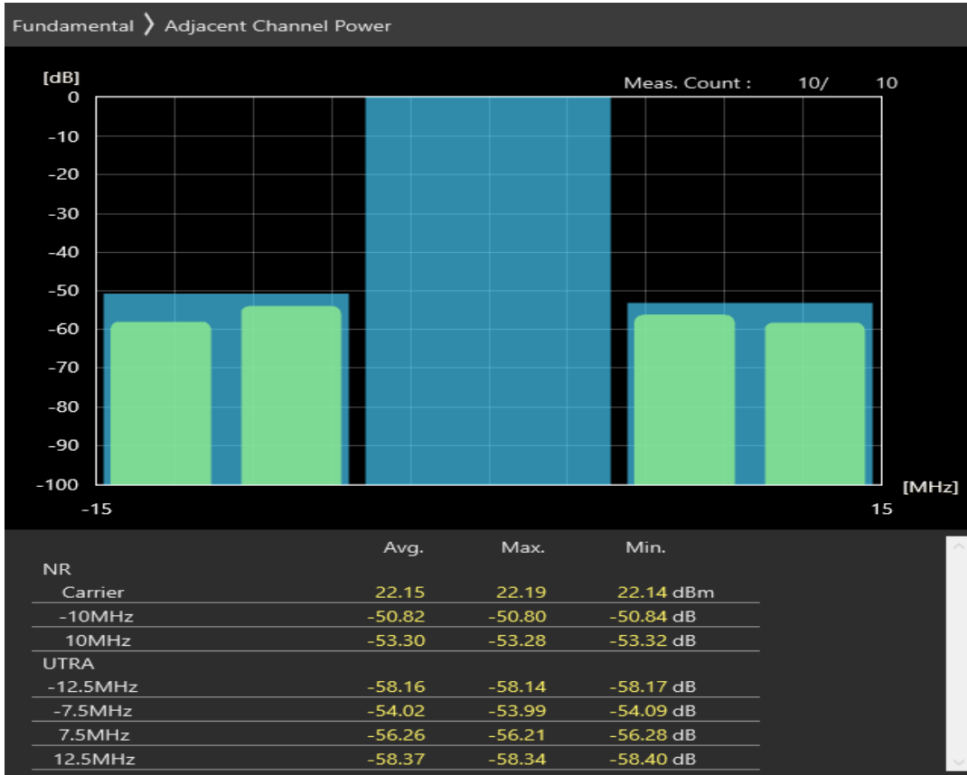
n1 SCS=30kHz DFT_QPSK BW=10MHz Channel=385000 RB=24@0
