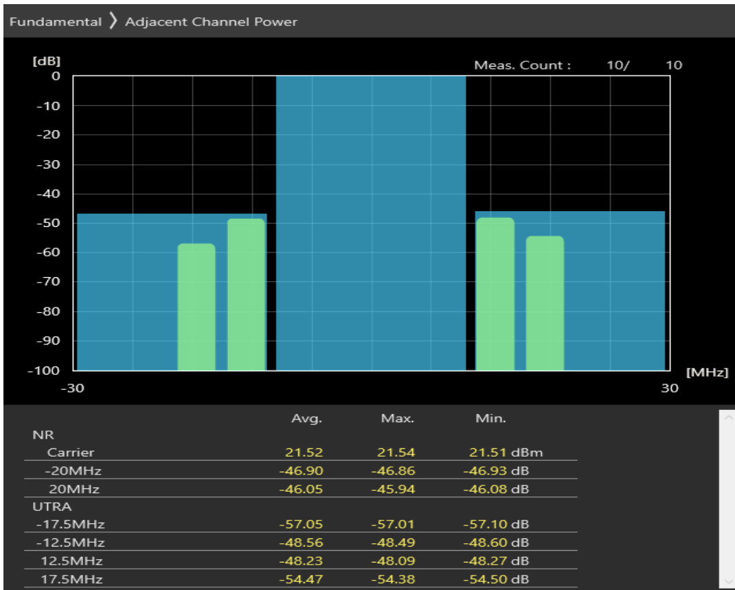
n20 SCS=30kHz CP_QAM16 BW=20MHz Channel=168400 RB=1@0
