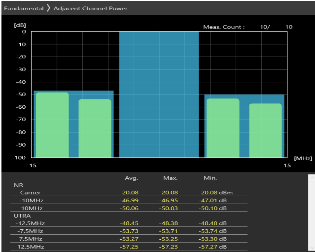
n3 SCS=30kHz CP_QPSK BW=10MHz Channel=356000 RB=24@0
