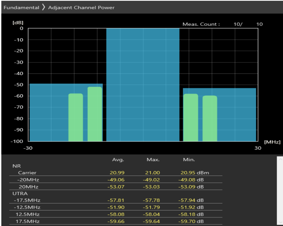
n38 SCS=30kHz DFT_QAM16 BW=20MHz Channel=516000 RB=50@0
