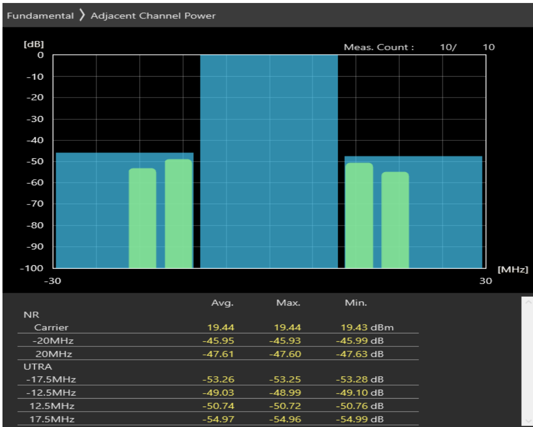
n1 SCS=30kHz DFT_QAM16 BW=20MHz Channel=394000 RB=50@0
