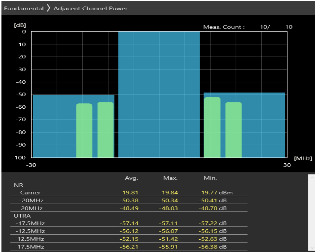
n1 SCS=30kHz CP_QPSK BW=20MHz Channel=394000 RB=25@12
