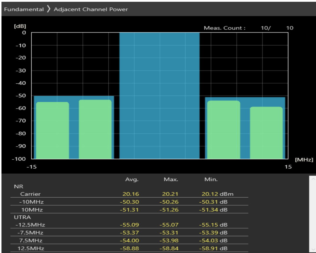
n28 SCS=30kHz CP_QAM256 BW=10MHz Channel=148600 RB=24@0
