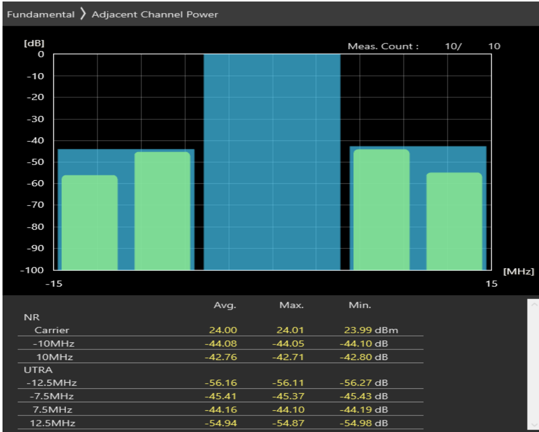
n3 SCS=30kHz DFT_QPSK BW=10MHz Channel=343000 RB=1@0
