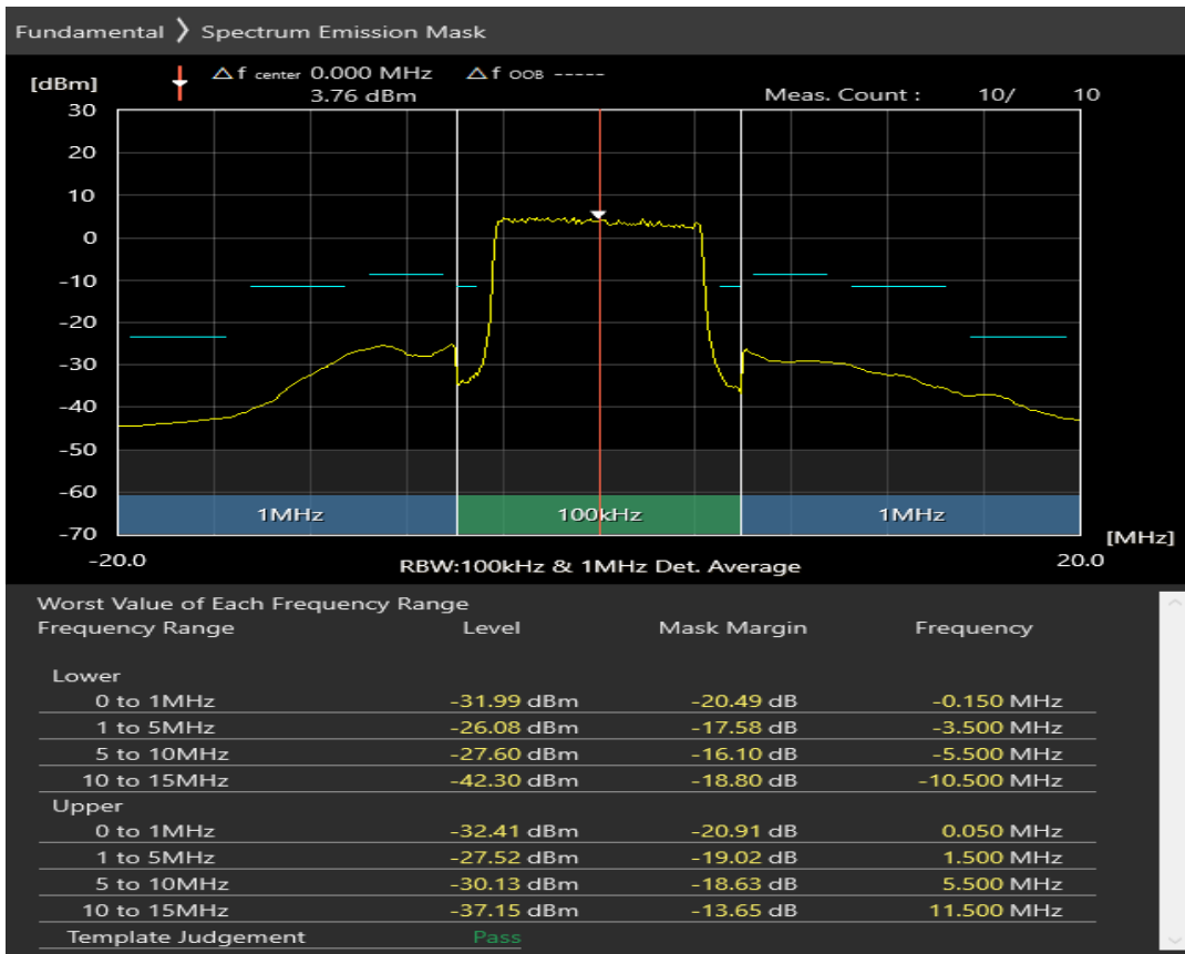
n8 SCS=30kHz DFT_QPSK BW=10MHz Channel=177000 RB=1@0
