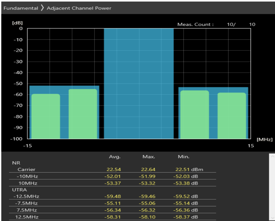
n28 SCS=30kHz DFT_QPSK BW=10MHz Channel=141600 RB=24@0
