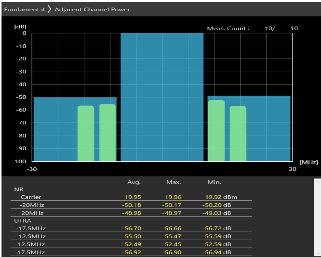
n20 SCS=30kHz DFT_BPSK BW=20MHz Channel=170400 RB=50@0
