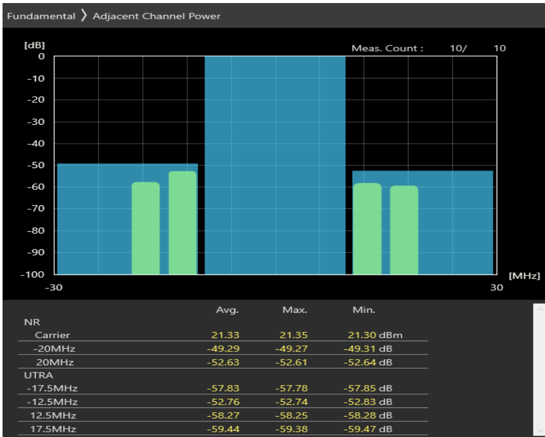
n8 SCS=30kHz CP_QAM64 BW=20MHz Channel=178000 RB=51 @0
