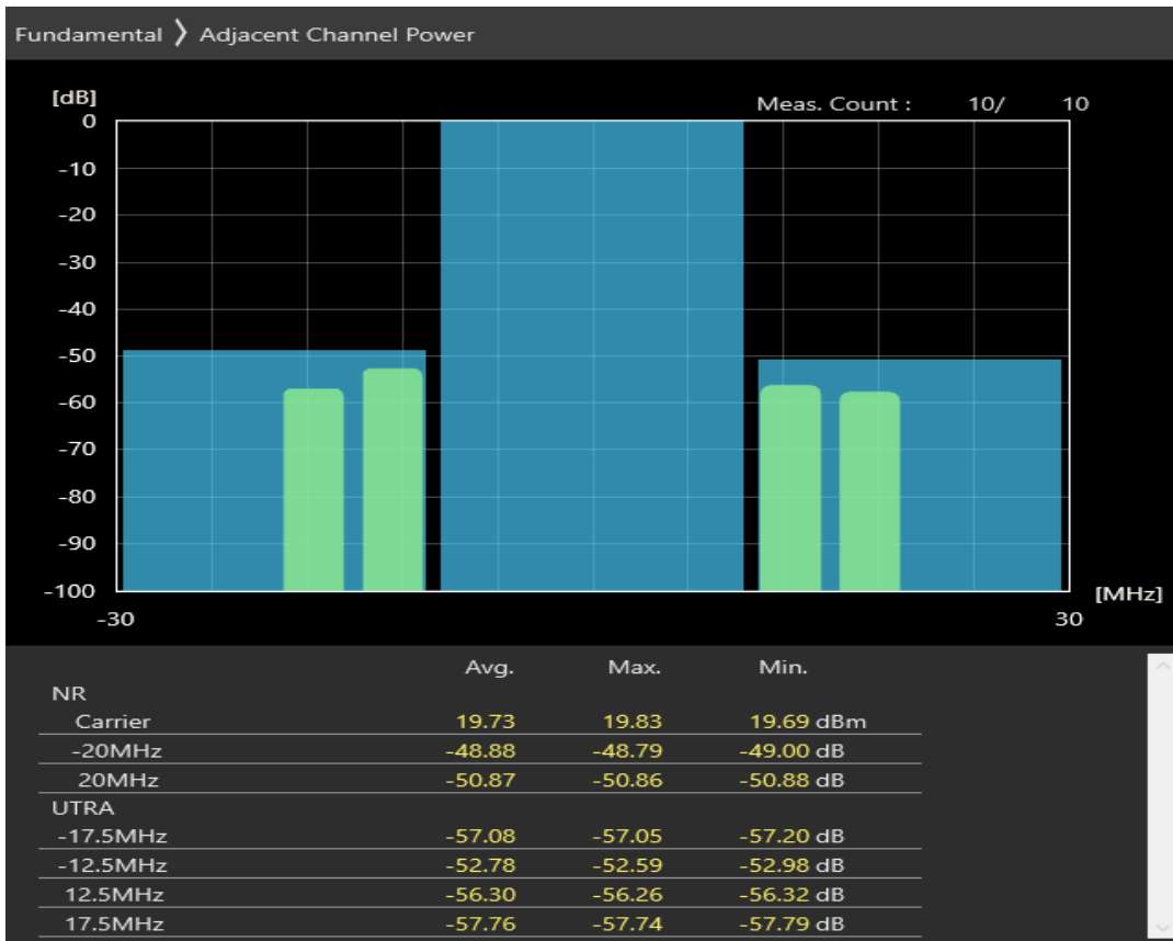
n20 SCS=30kHz DFT_BPSK BW=20MHz Channel=170400 RB=25@12
