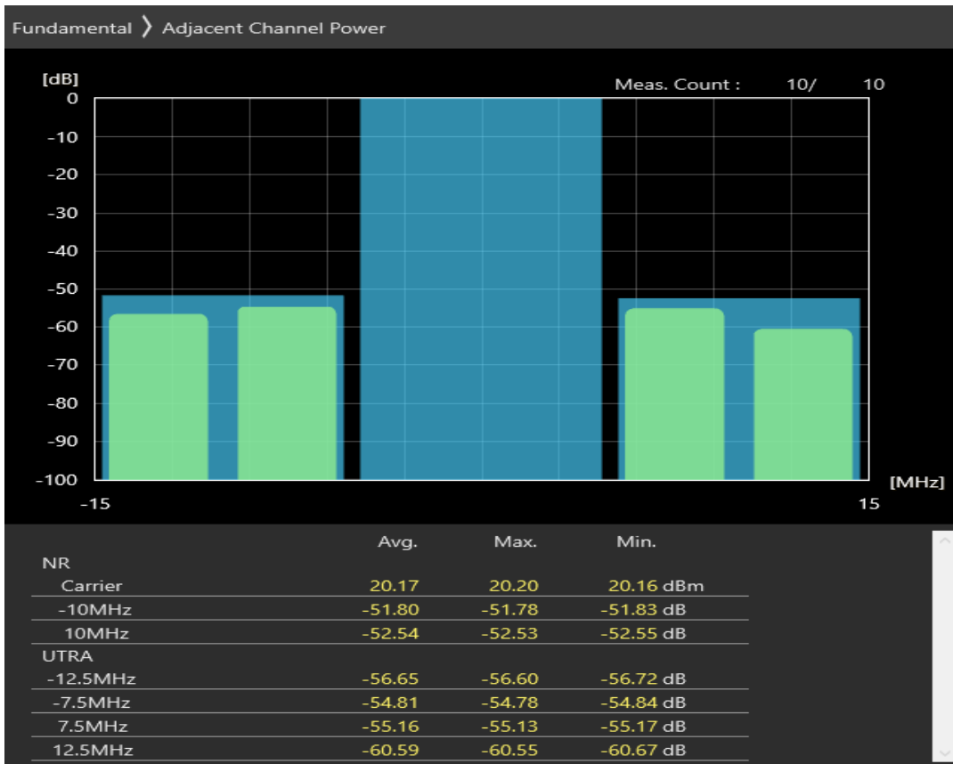
n8 SCS=30kHz DFT_QPSK BW=10MHz Channel=182000 RB=24@0
