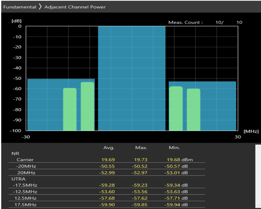
n20 SCS=30kHz DFT_QAM16 BW=20MHz Channel=168400 RB=50@0
