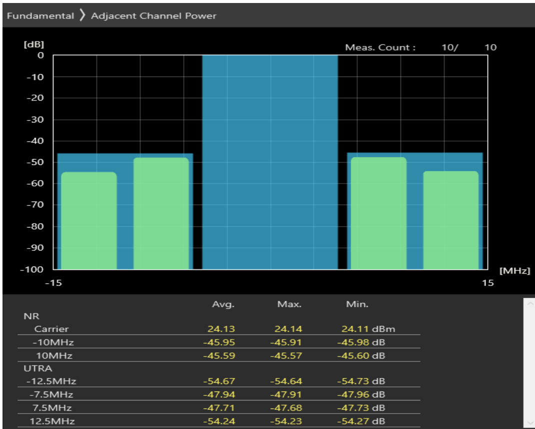
n38 SCS=30kHz DFT_BPSK BW=10MHz Channel=515000 RB=1@0
