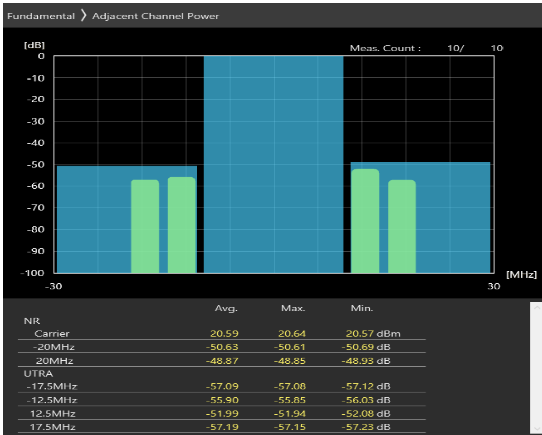
n20 SCS=30kHz CP_QPSK BW=20MHz Channel=170400 RB=51@0
