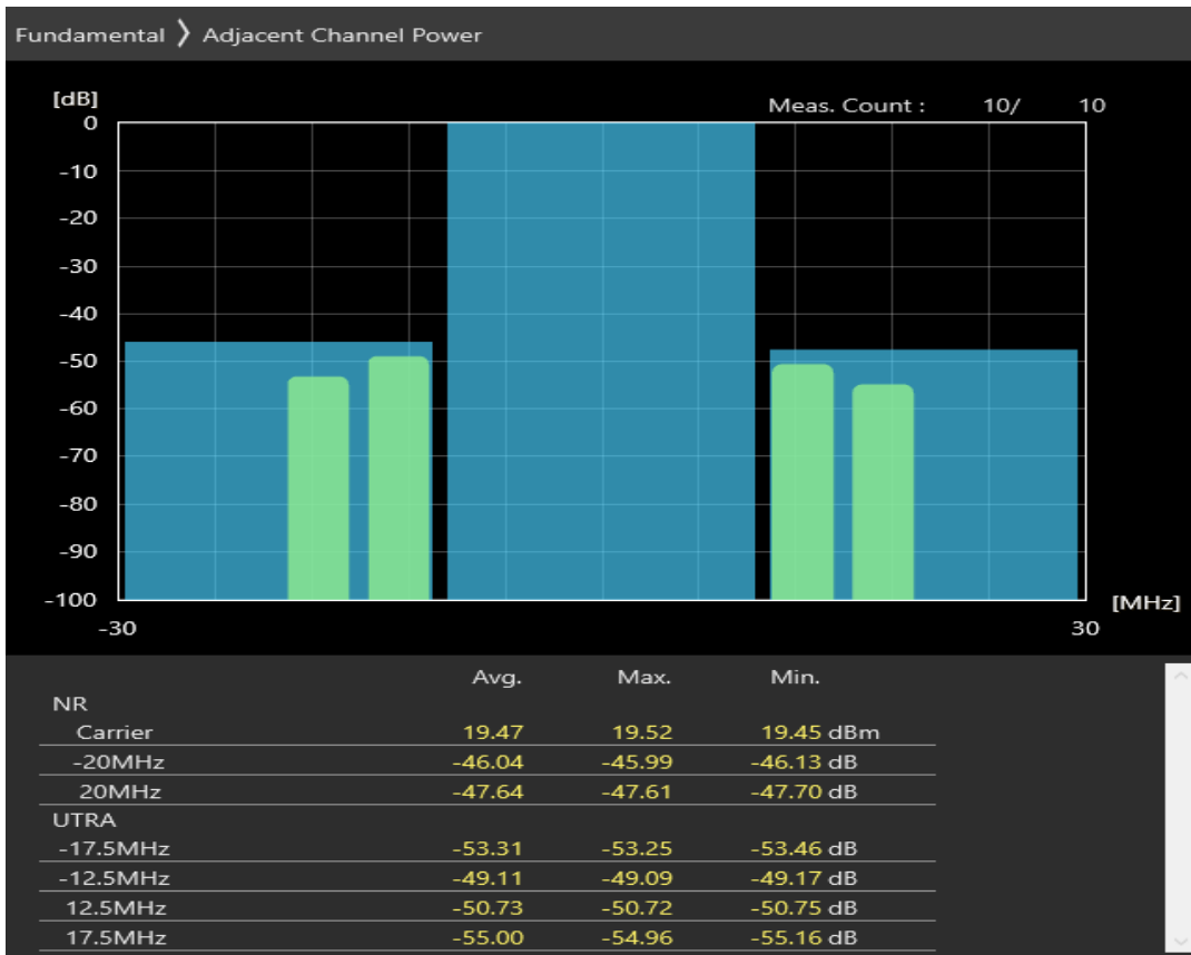
n1 SCS=30kHz DFT_QPSK BW=20MHz Channel=394000 RB=50@0
