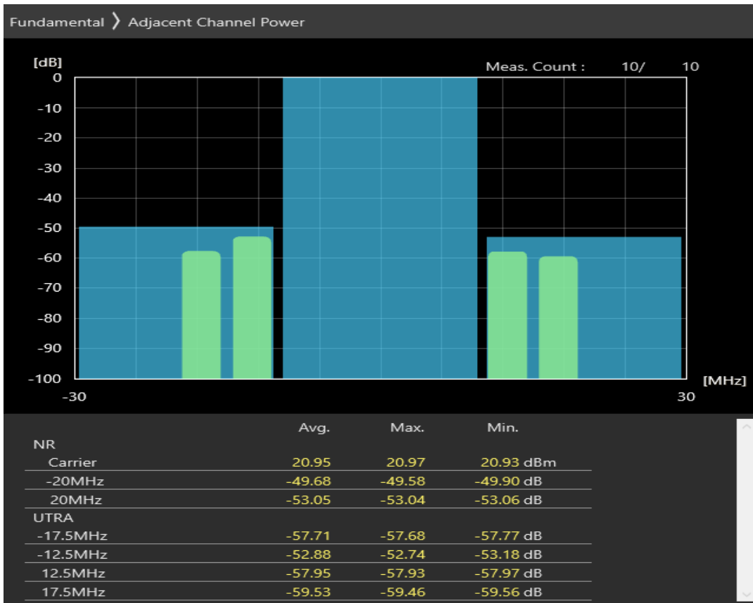
n38 SCS=30kHz DFT_QPSK BW=20MHz Channel=516000 RB=50@0
