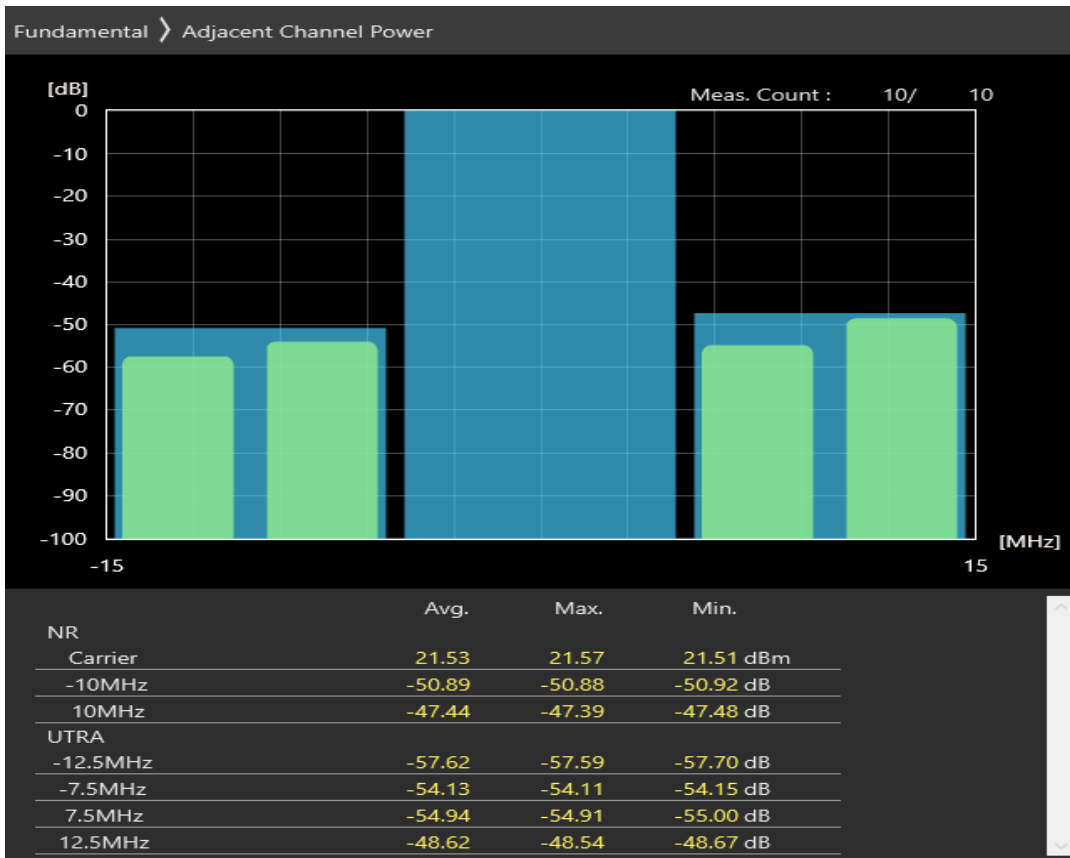
n3 SCS=30kHz CP_QPSK BW=10MHz Channel=343000 RB=24@0
