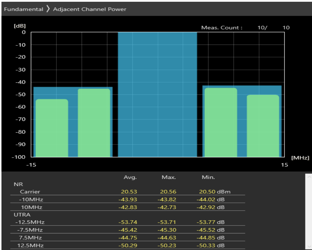
n20 SCS=30kHz CP_QAM64 BW=10MHz Channel=167400 RB=1@0
