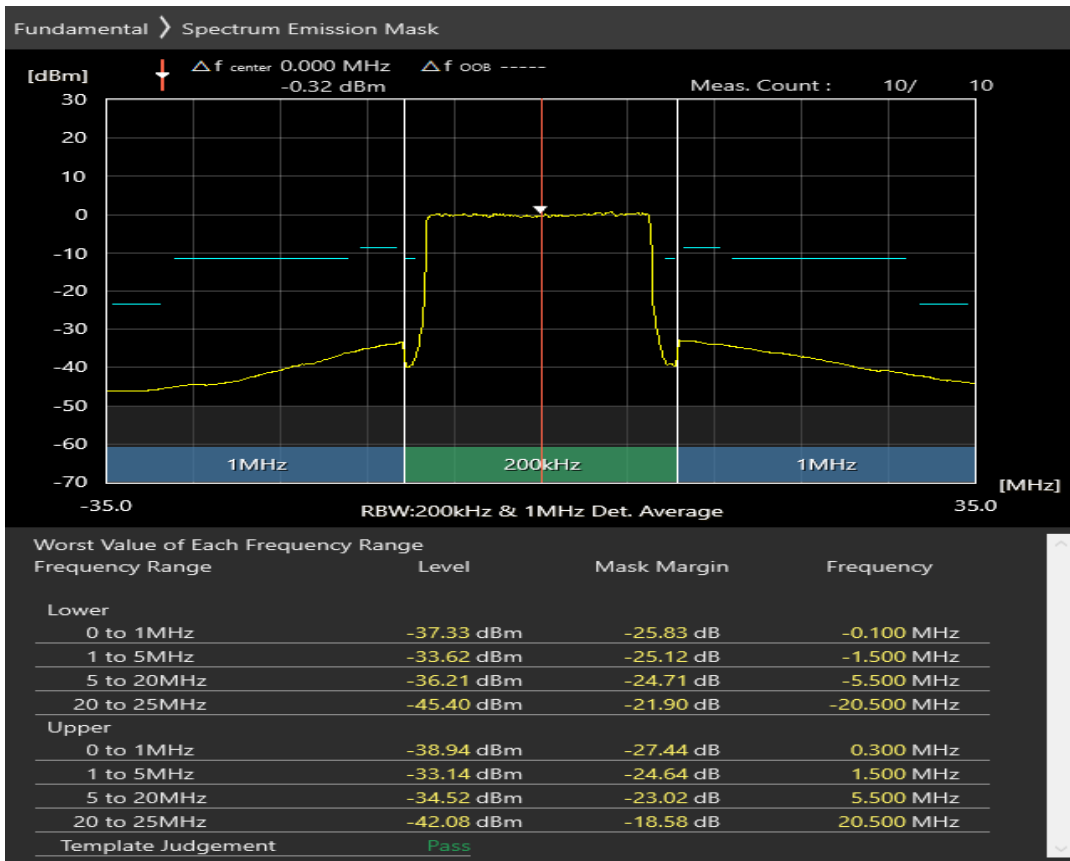
n1 SCS=30kHz DFT_QPSK BW=20MHz Channel=386000 RB=1@0
