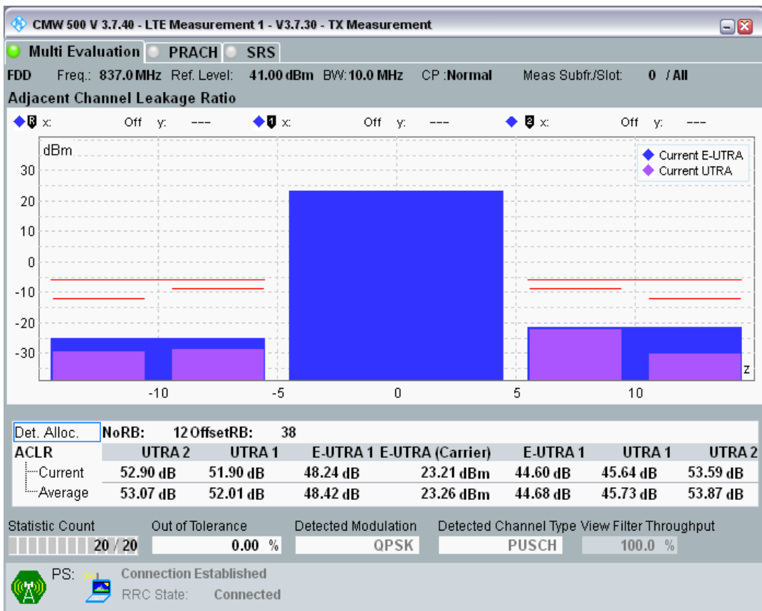
Band20 QPSK BW=10MHz Channel=24200 RB Size=50 Position=#0
