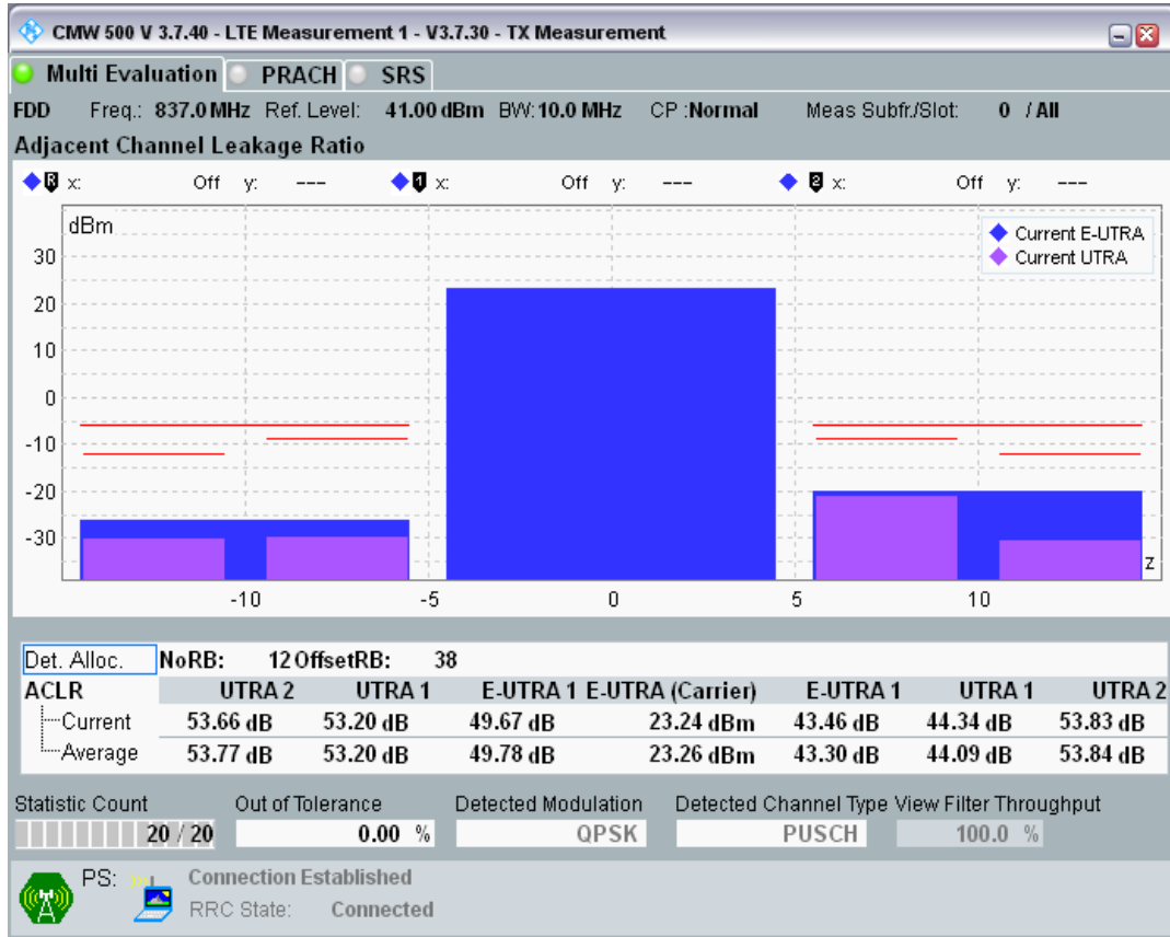
Band20 QPSK BW=10MHz Channel=24200 RB Size=50 Position=#0
