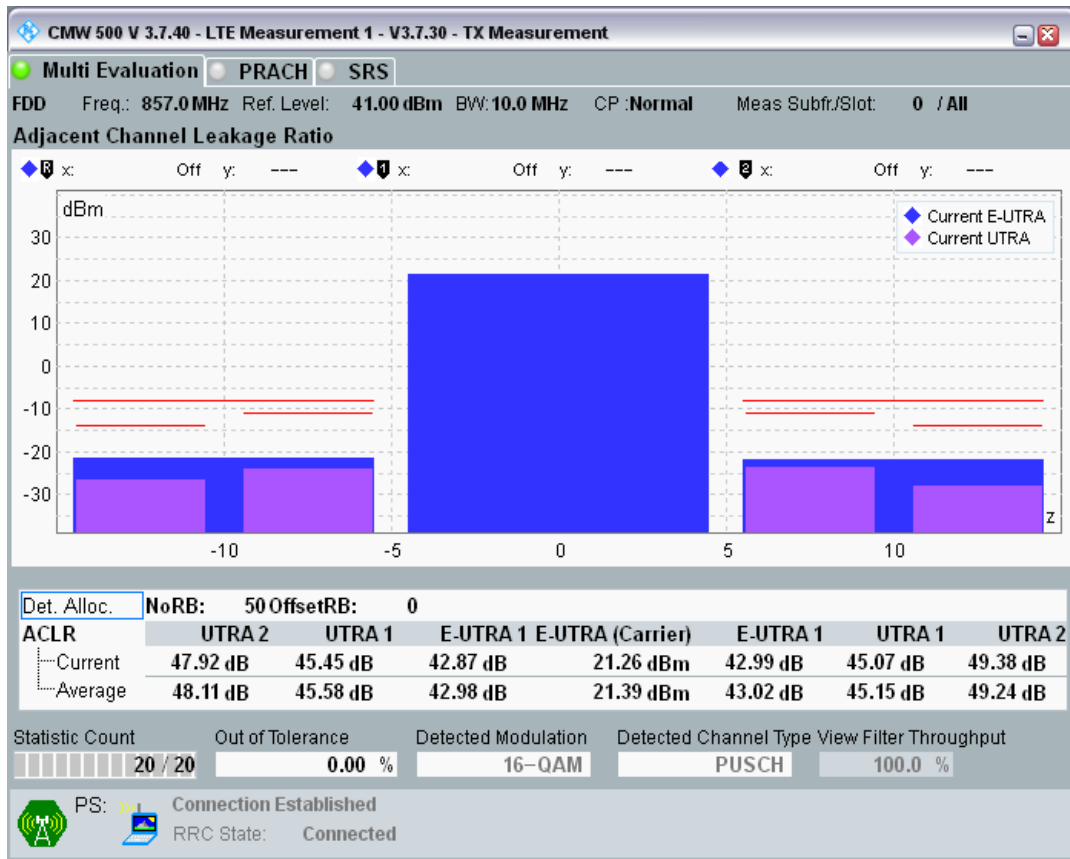
Band20 QPSK BW=20MHz Channel=24250 RB Size=18 Position=#0
