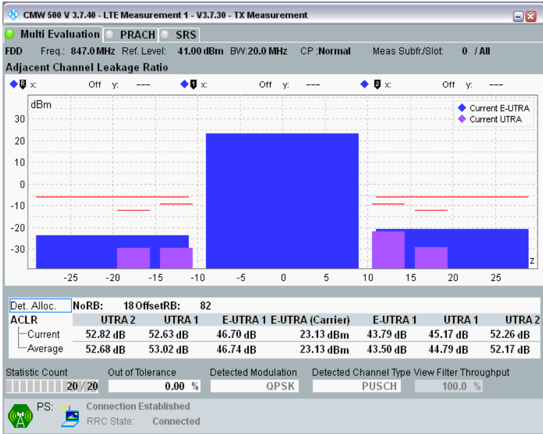
Band20 QPSK BW=20MHz Channel=24300 RB Size=100 Position=#0
